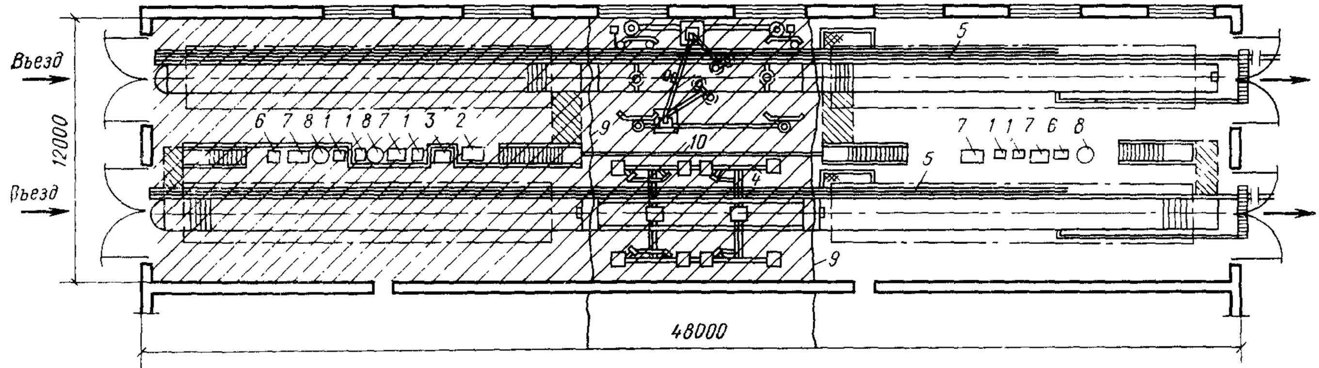
Рис. 6. Примерная схема помещения постов мойки и уборки автомобилей, приспособленного для обеззараживания автотранспорт
