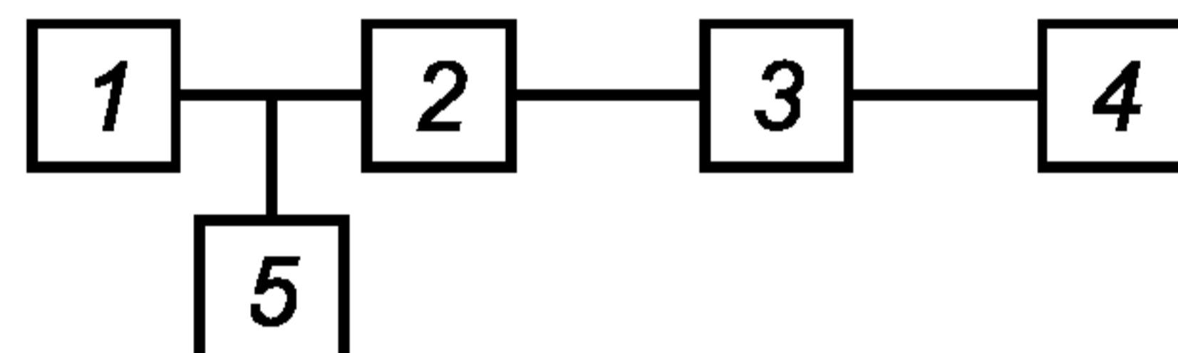
1 — источник напряжения постоянного тока; 2 — коаксиальный измерительный электрический соединитель № 2 (С-001 — для вольтметра типа В3-49) из комплекта поверяемого вольтметра; 3 — коаксиальный измерительный электрический соединитель № 4 (С-003 — для вольтметра типа В3-49) из комплекта поверяемого вольтметра; 4 — поверяемый вольтметр; 5 — цифровой вольтметр или потенциометр
