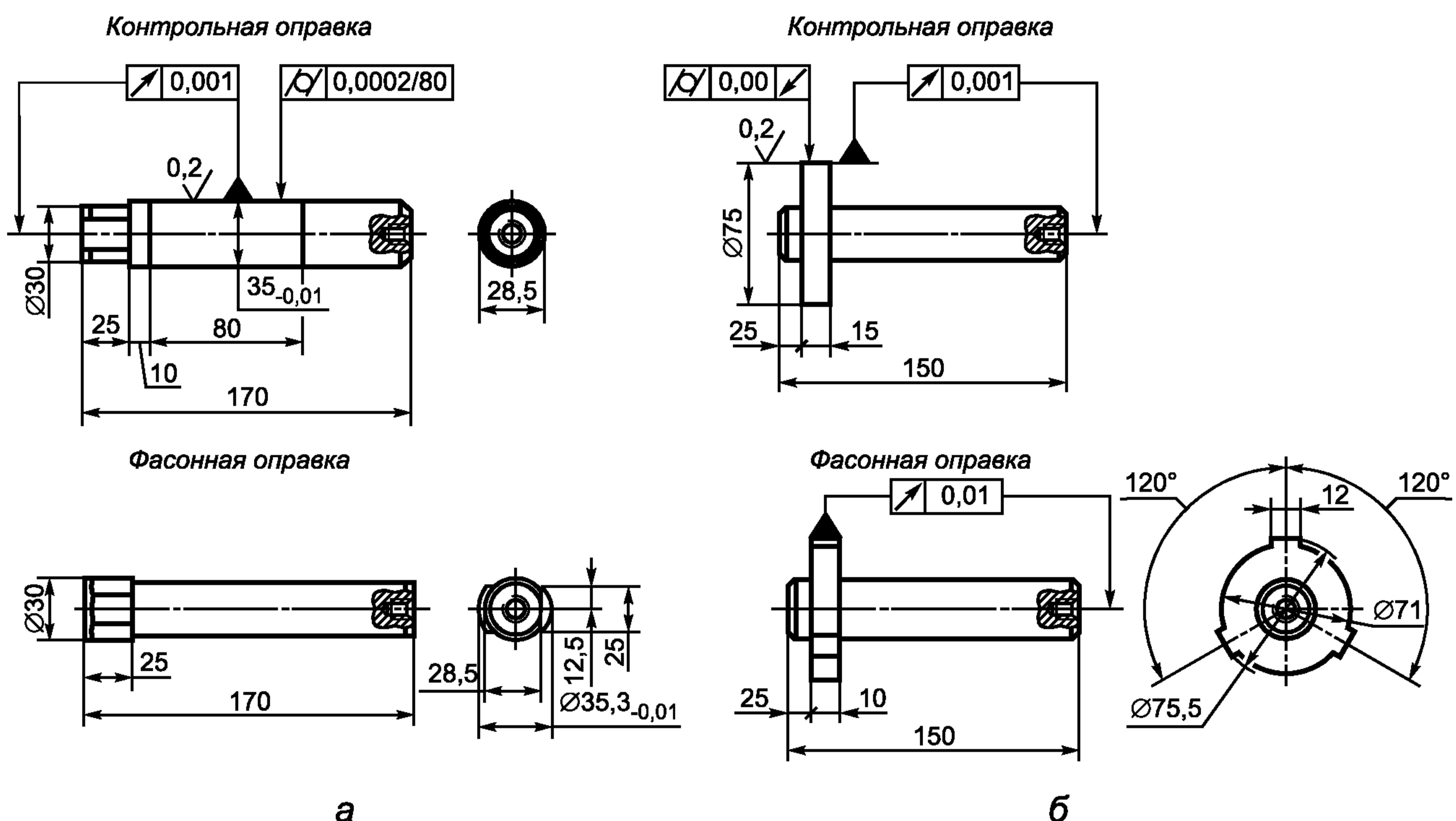
Рисунок 2 — Контрольная и фасонная оправки:
