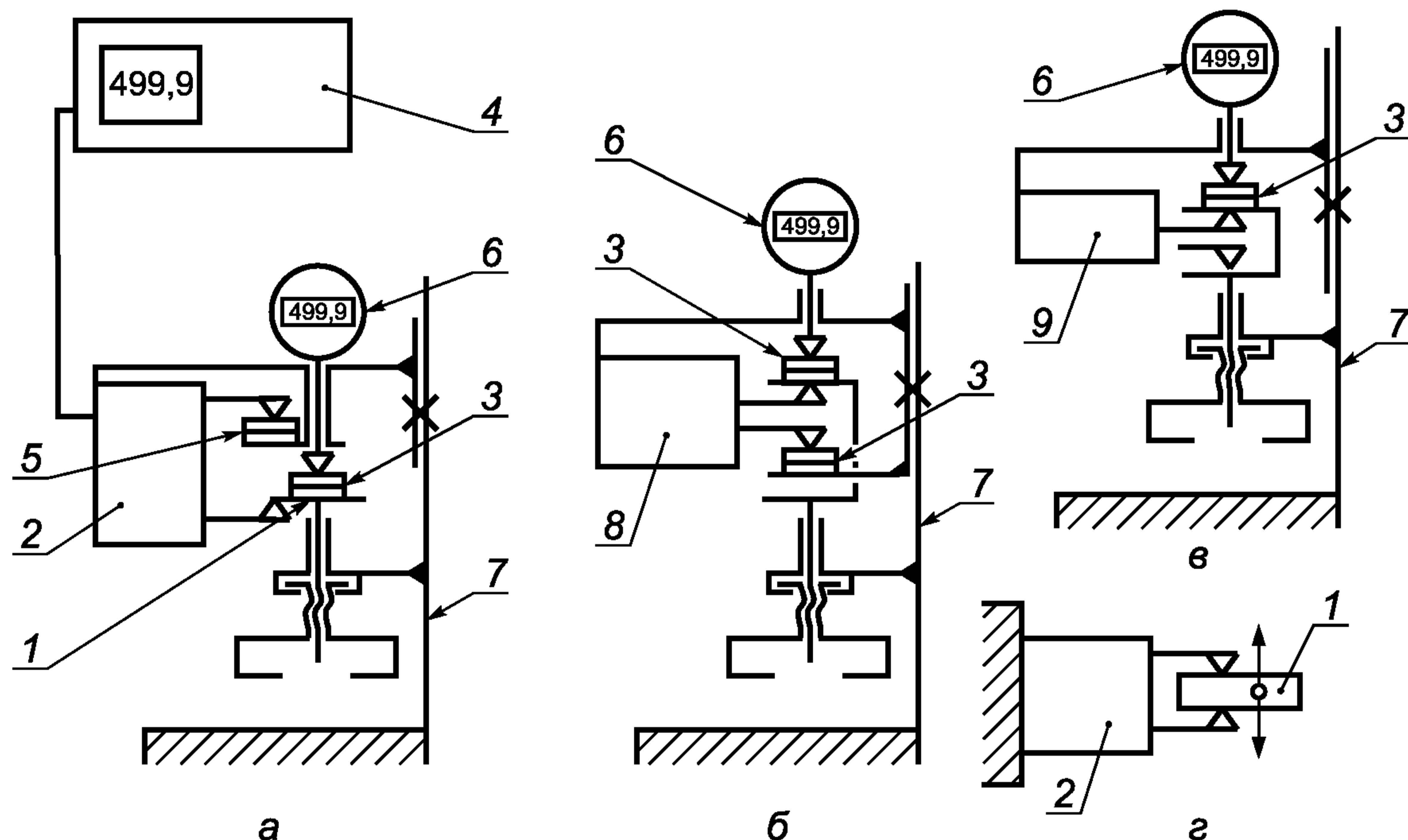
1 — столик; 2, 8, 9 — измерительное устройство; 3, 5 — концевая мера длины; 4 — цифровой электронный блок;
