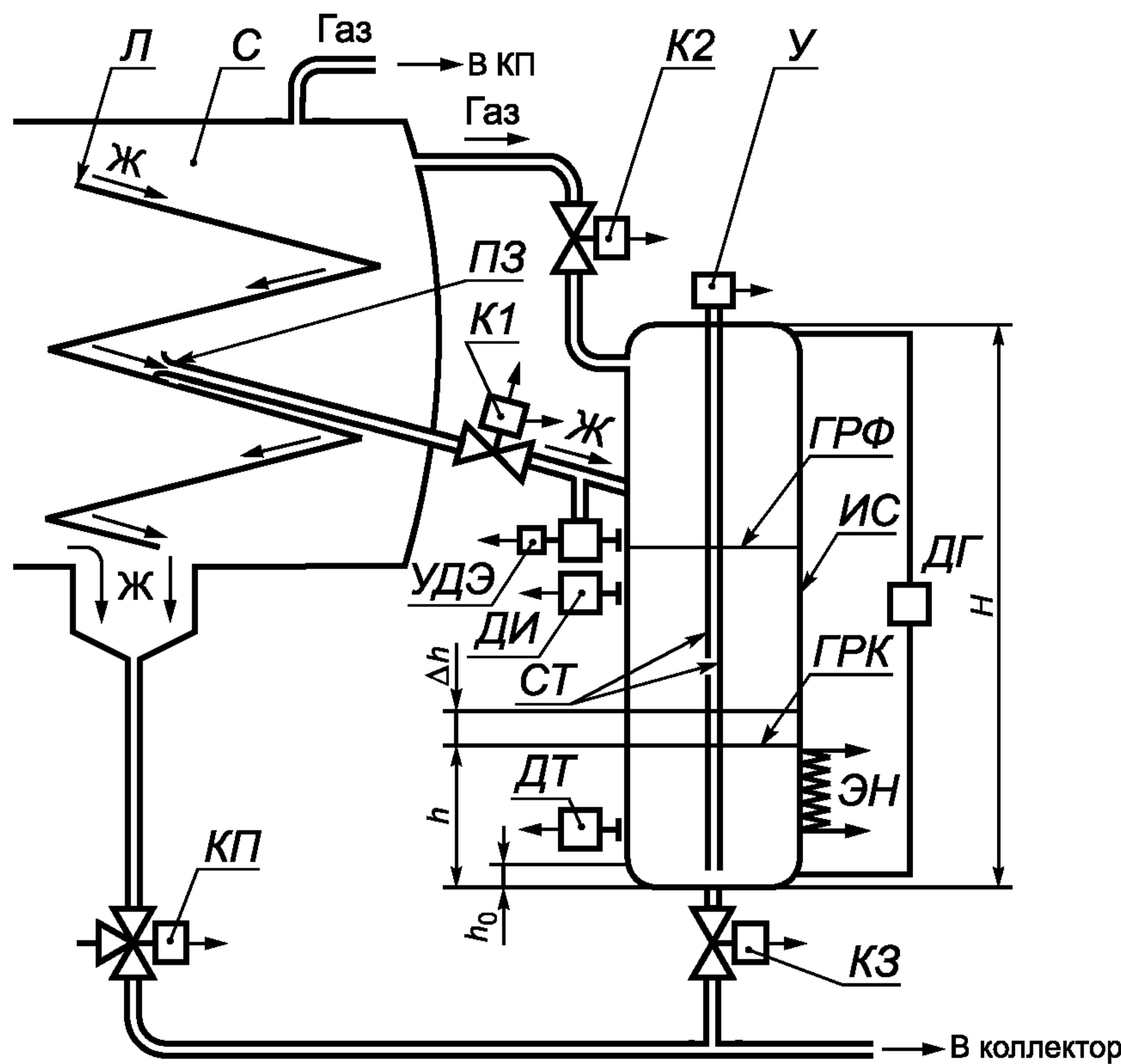
Л — лоток; С — сепаратор; ПЗ — пробозаборное устройство; Ж — жидкость, проба смеси; У — уровнемер; УДЭ — узел дозирования деэмульгатора; К1, К2, К3 — управляемые клапаны; ГРФ — граница раздела фаз (вода — нефть); ИС — влагомер; ГРК — граница раздела компонентов; ЭН — электронагреватель; ДИ — датчик избыточного давления; ДТ — датчик температуры; СТ — стержень уровнемера; ДГ — датчик дифференциального давления
