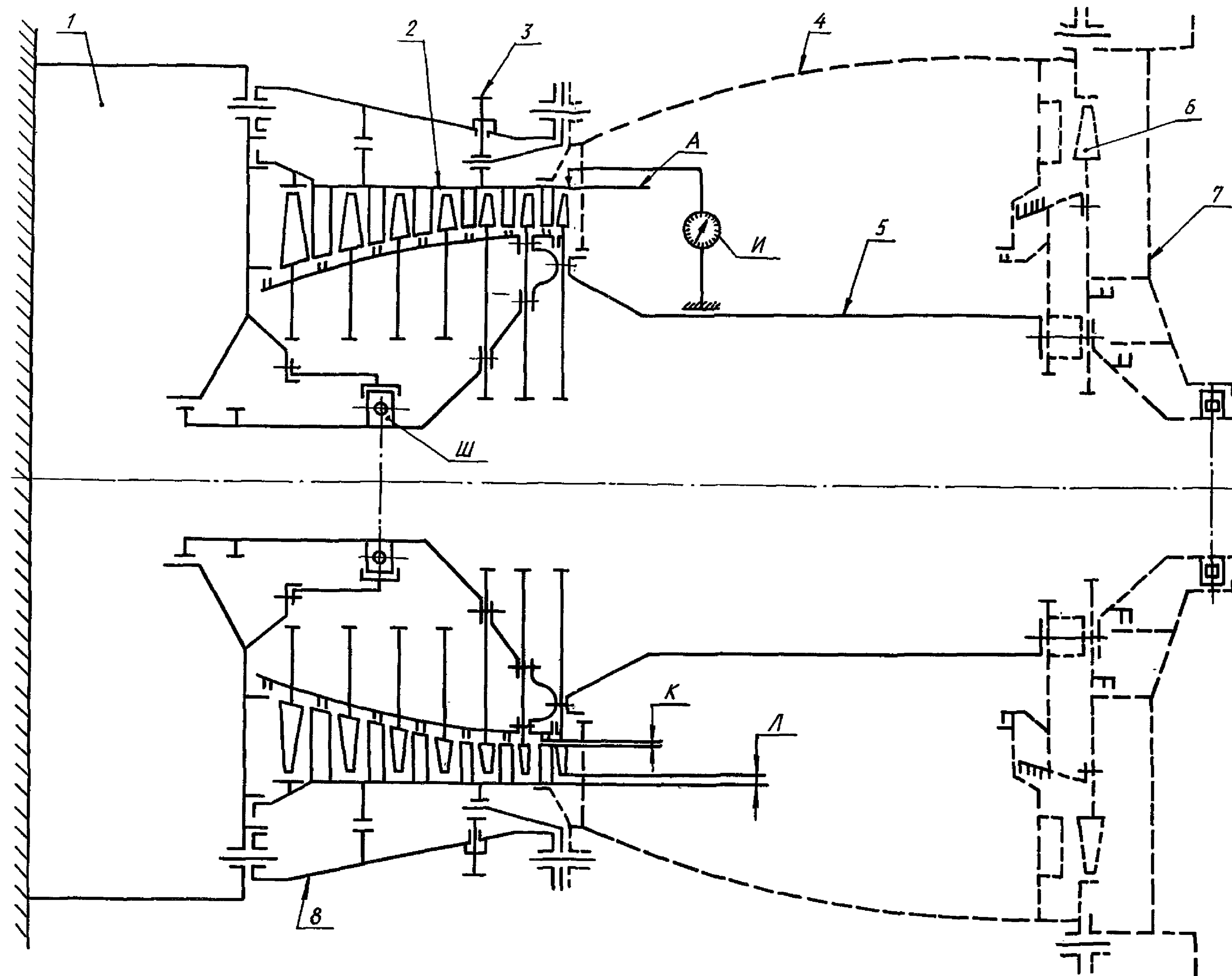
1 - корпус компрессора низкого давления; 2 - статор; 3 - технологические винтовые упоры;
