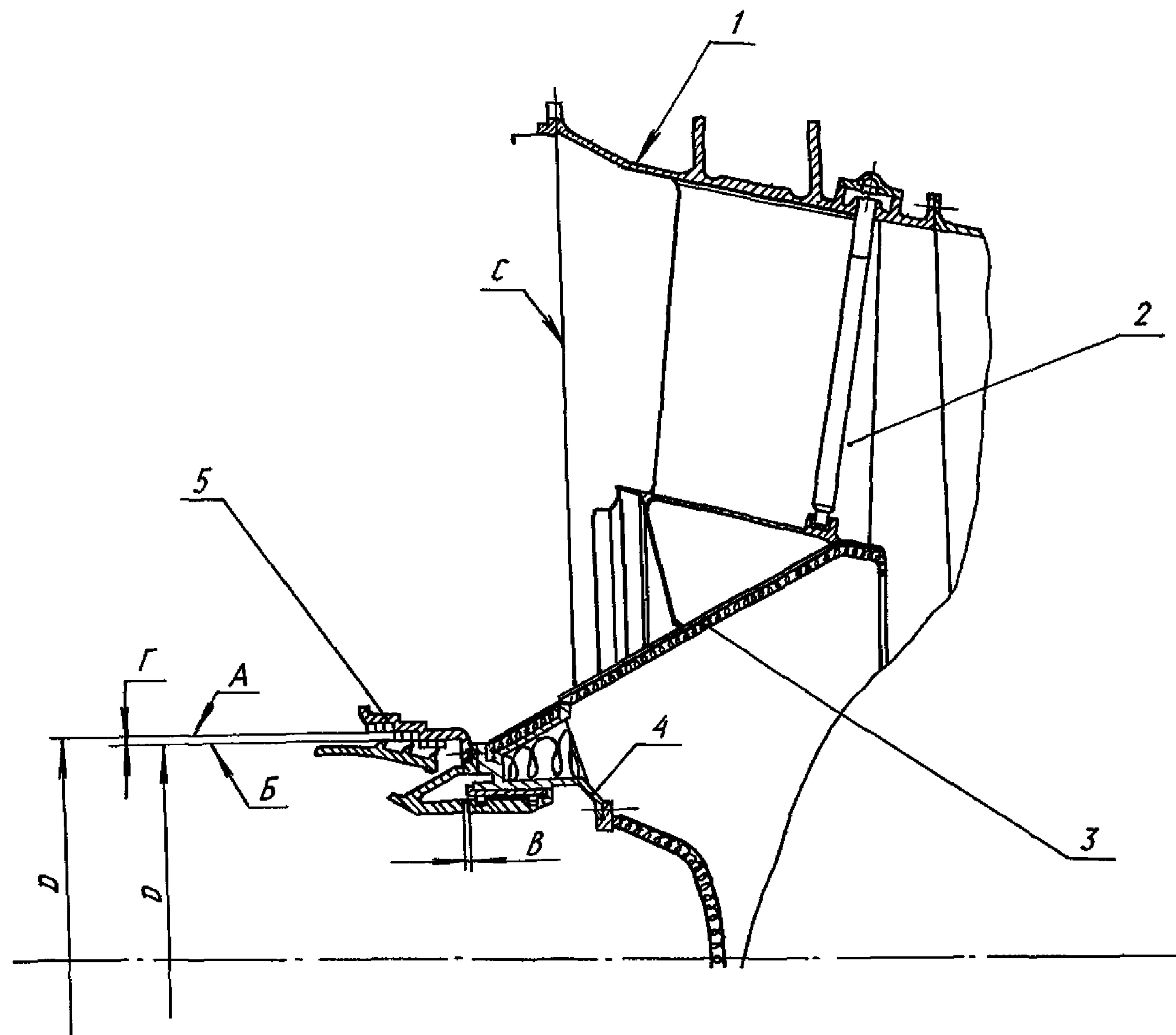
1 - корпус наружный; 2 - стойки; 3 - корпус внутренний; 4 - корпус опоры роликоподшипника;
