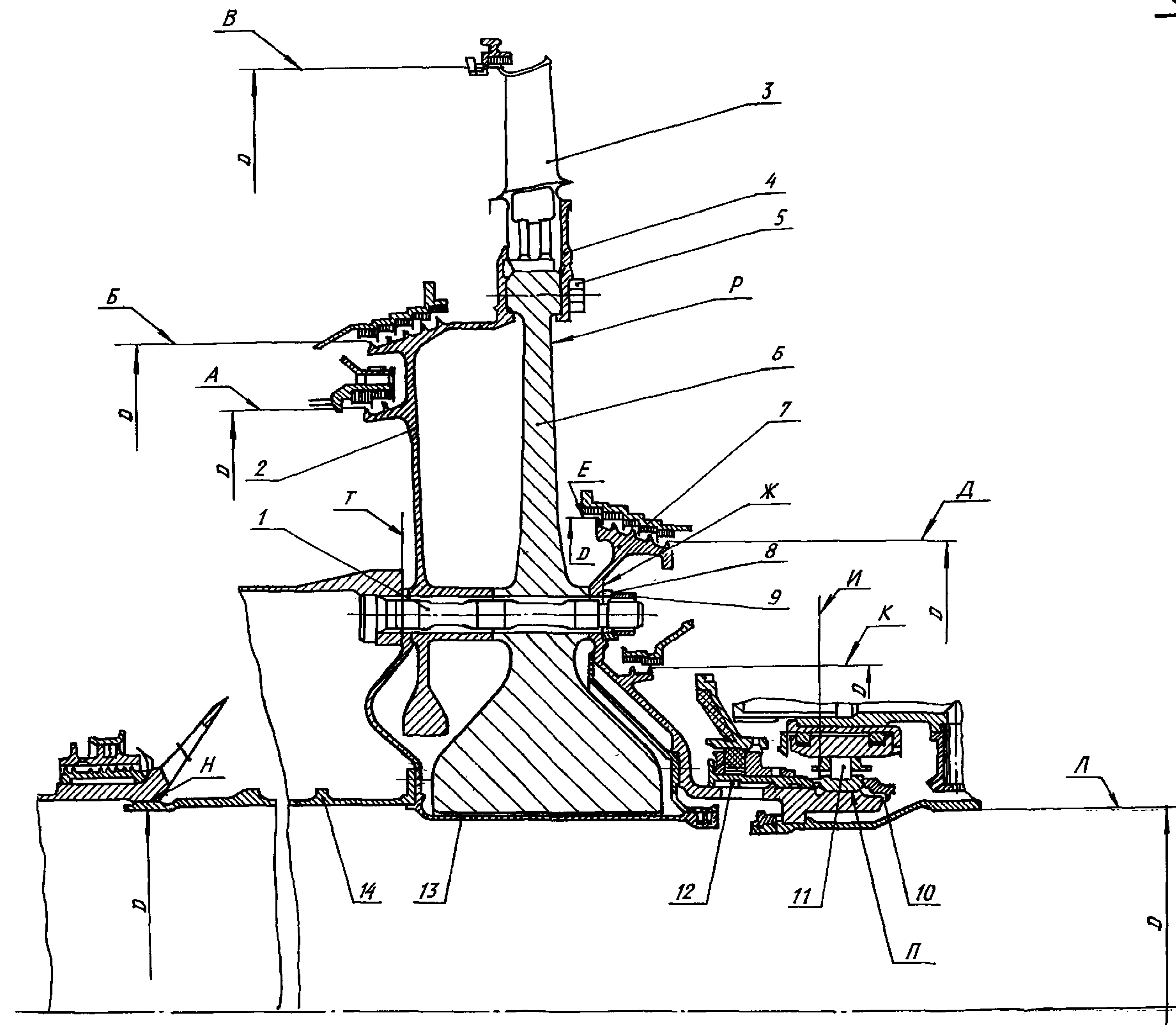
1 - болт стяжной; 2 - диск лабиринтный; 3 - лопатка ТВД; 4 - диск уплотнительный; 5 - груз балансировочный; 6 - диск ТВД; 7 - папфа задняя; 8 - контрвка; 9, 10 - гайки; 11 - ролико-подшипник; 12 - детали радиально-торцевого контактного уплотнения; 13 - экран; 14 - экран передний
