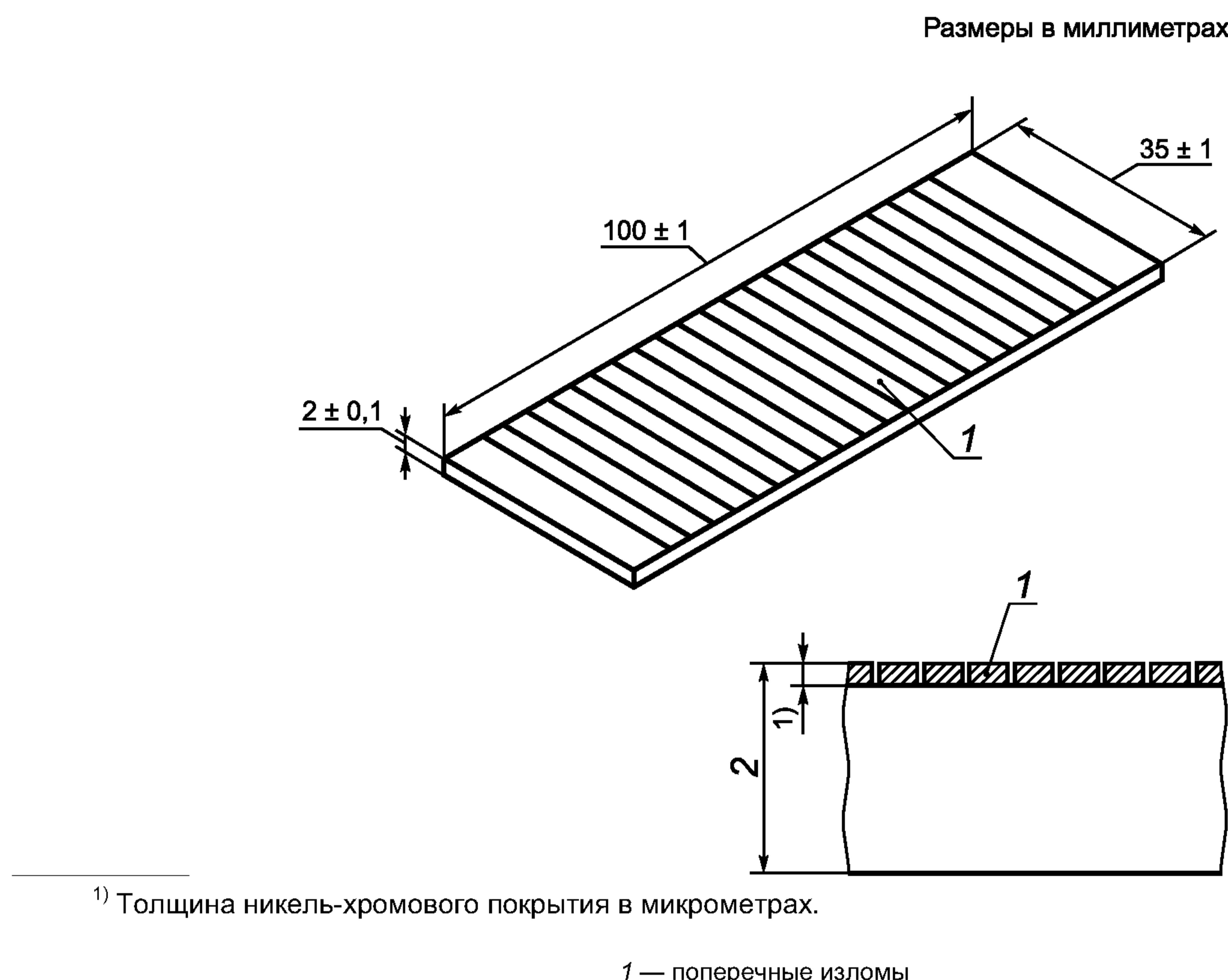
Рисунок 1 — Пластина испытательного образца типа 1
