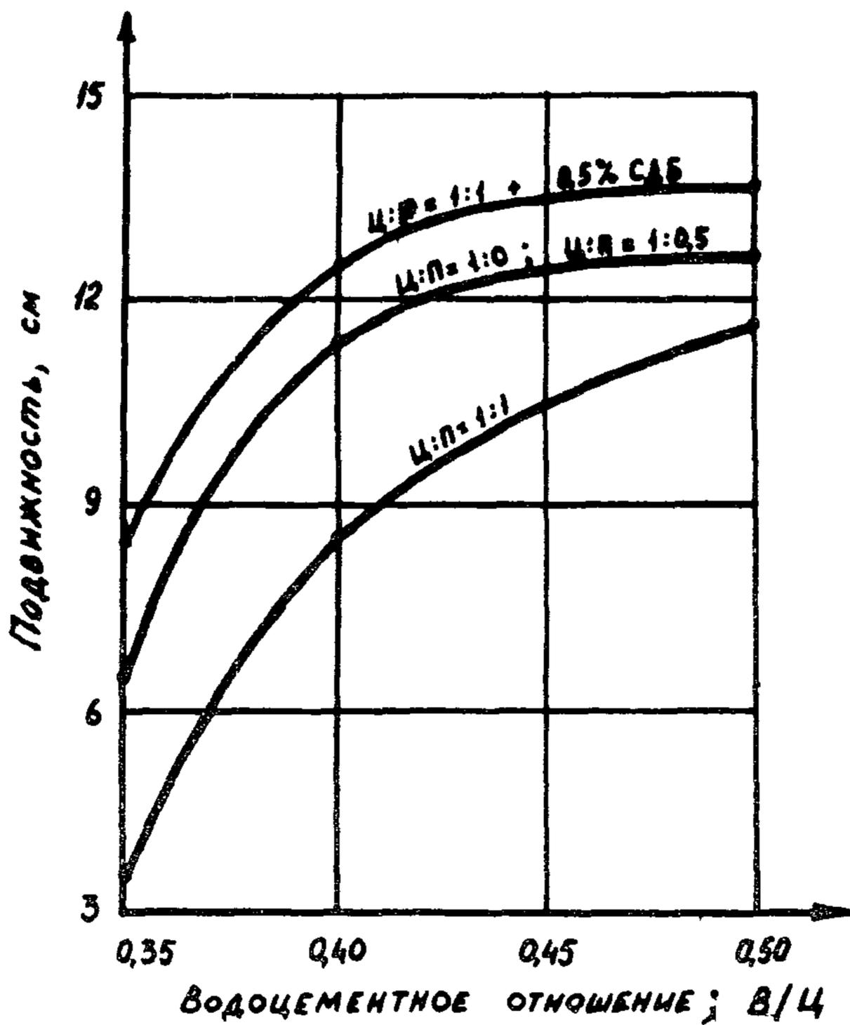
Соотношения между цементом (Ц) и песком (П), обеспечивающие заданную подвижность цементного раствора и мелкозернистого бетона, в зависимости от водоцементного отношения (В/Ц)
