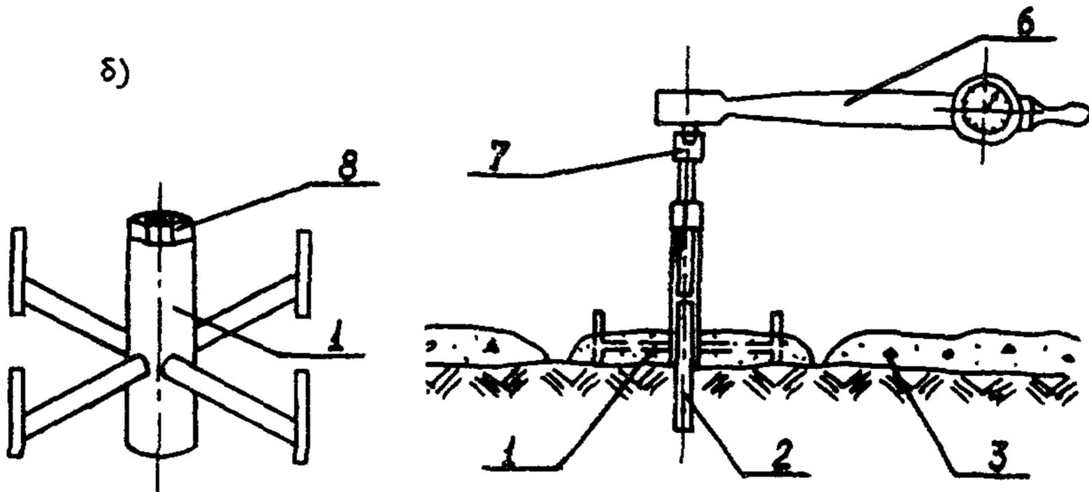
Определение сцепления набрызгбетонного покрытия с поверхностью выработки
