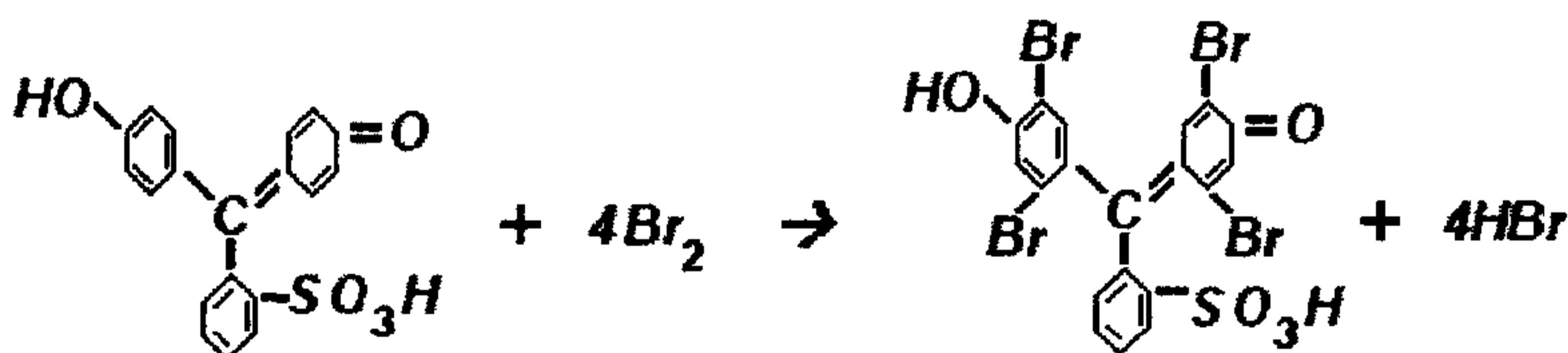
Изменение окраски раствора фиксируют спектрофотометрическим методом при длине волны 585 нм. Нижний предел обнаружения бромид-ионов в пробе 0,015 мг.
