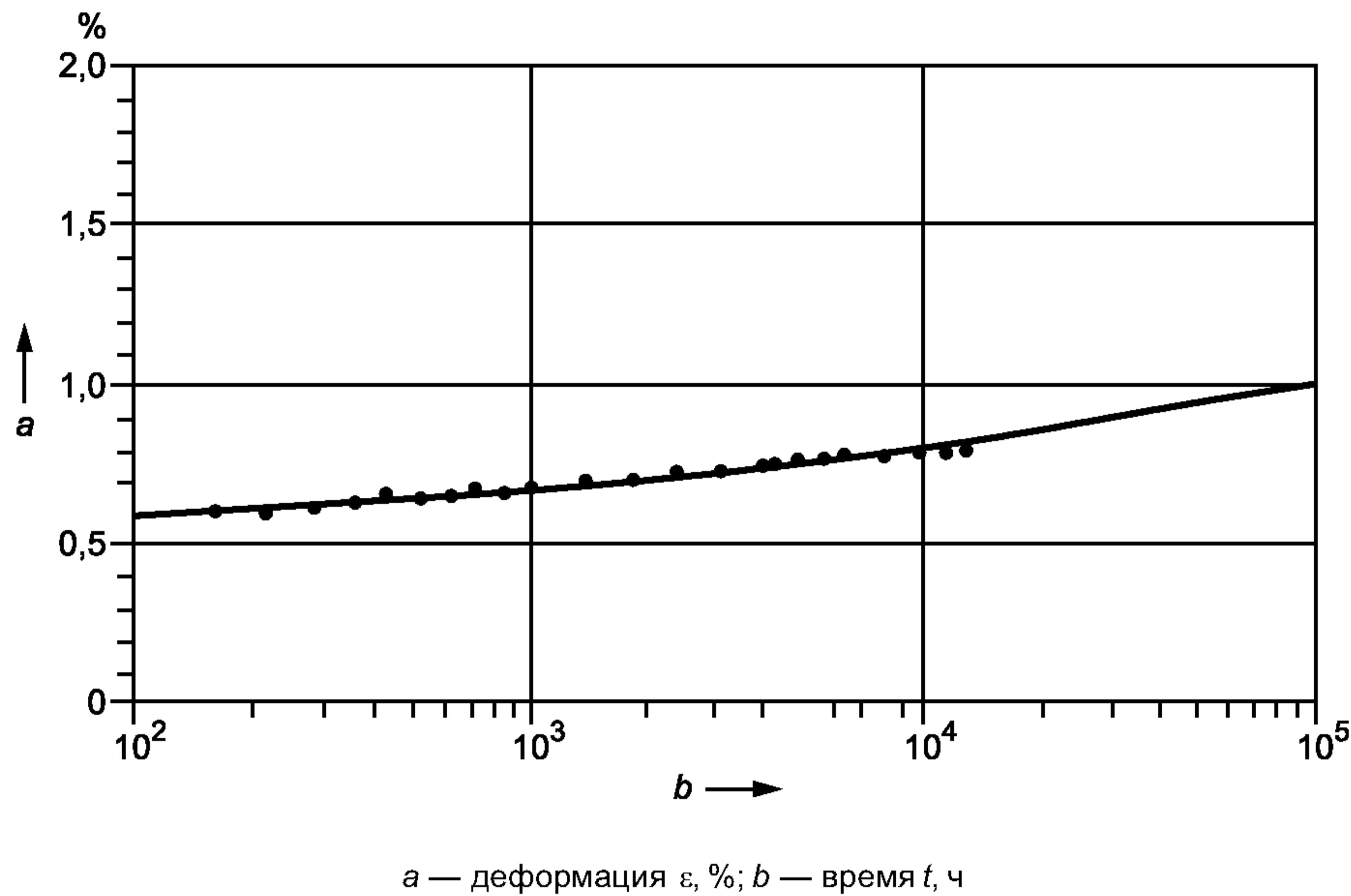
Рисунок В.2 — Деформация ползучести при длительном сжатии. Значения деформации получены при измерении, расчет проведен методом экстраполяции
