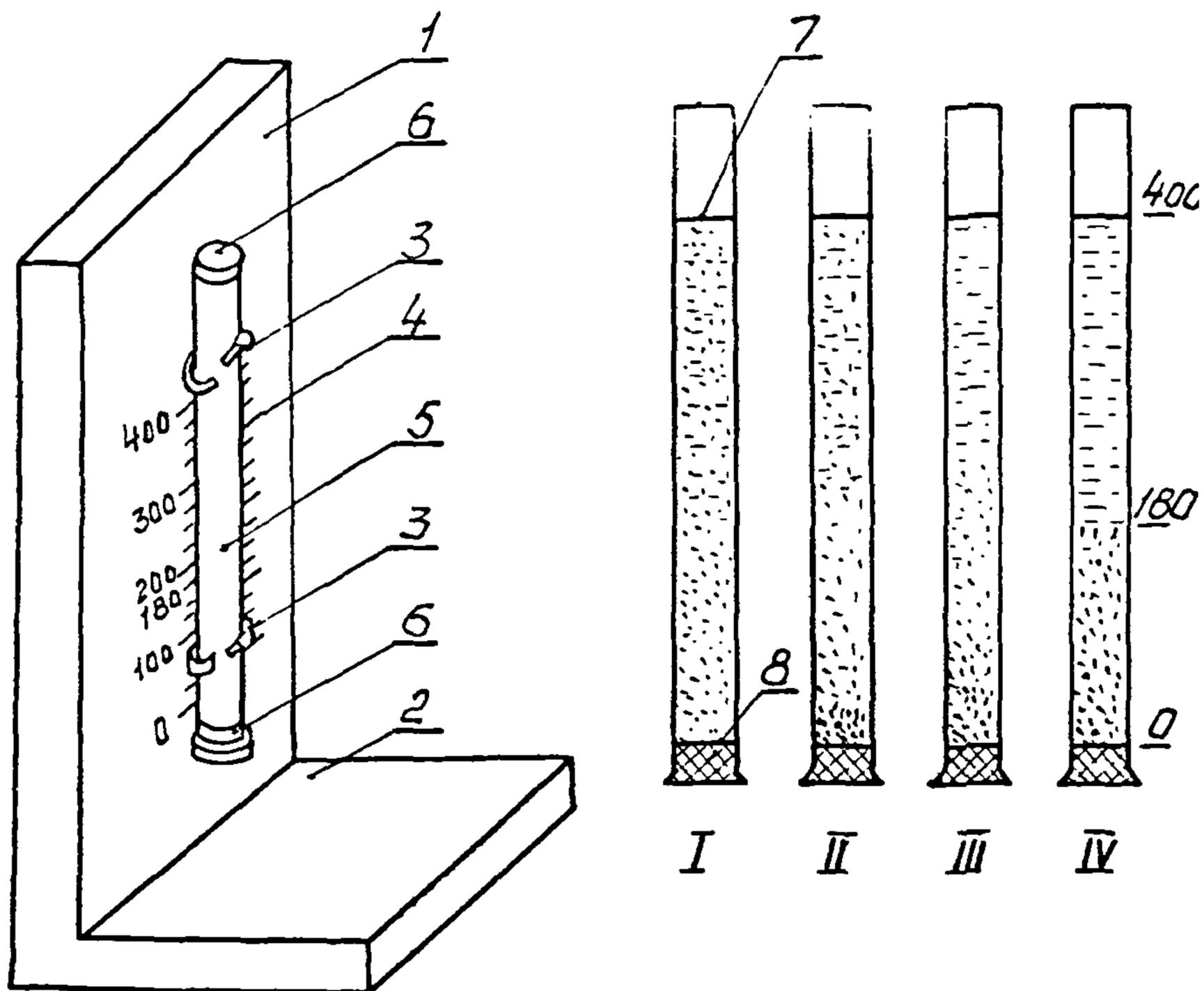
I-стойка, 2-основание, 3-зажимы, 4-шкала, 5-стеклянная трубка,
