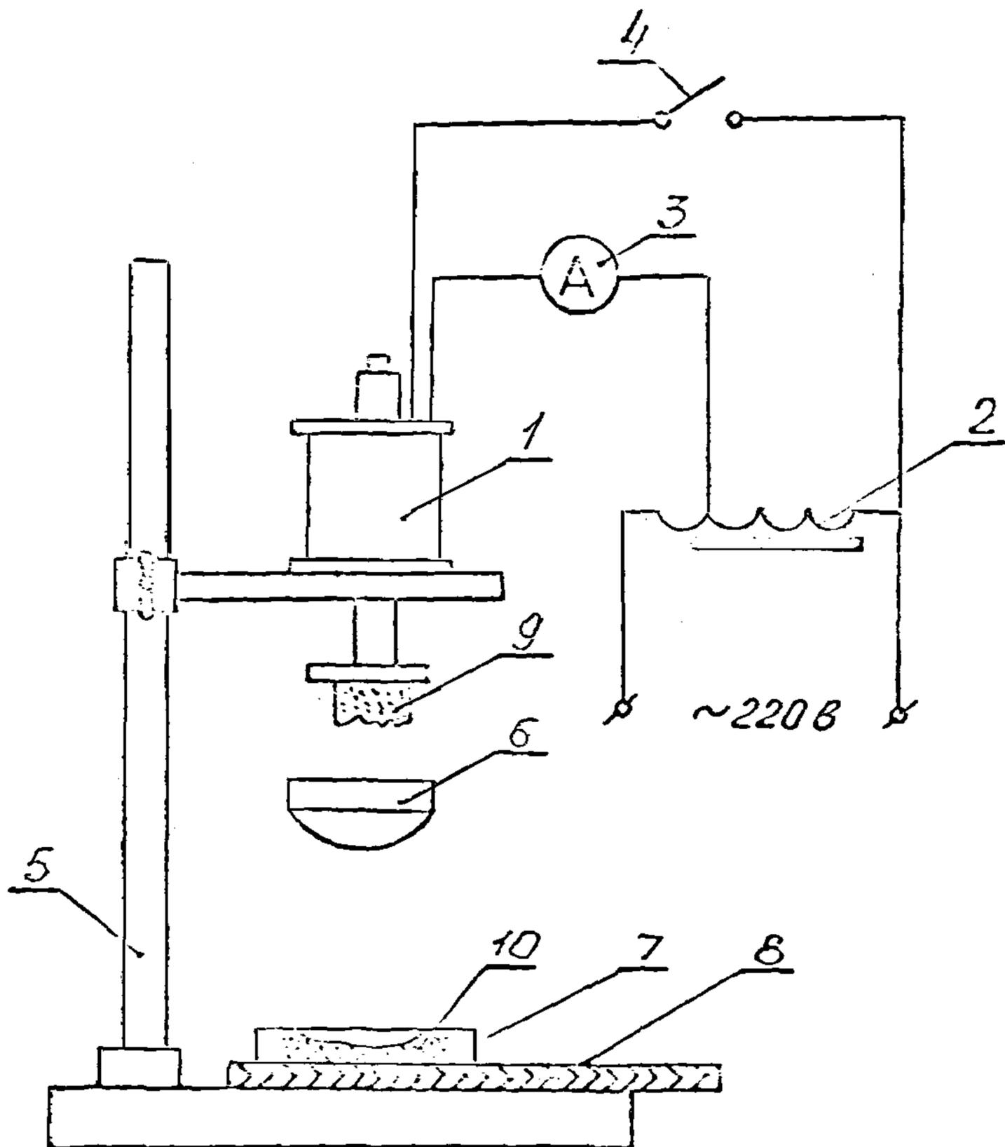
1-электромагнит, 2-автотрансформатор, 3-амперметр,
