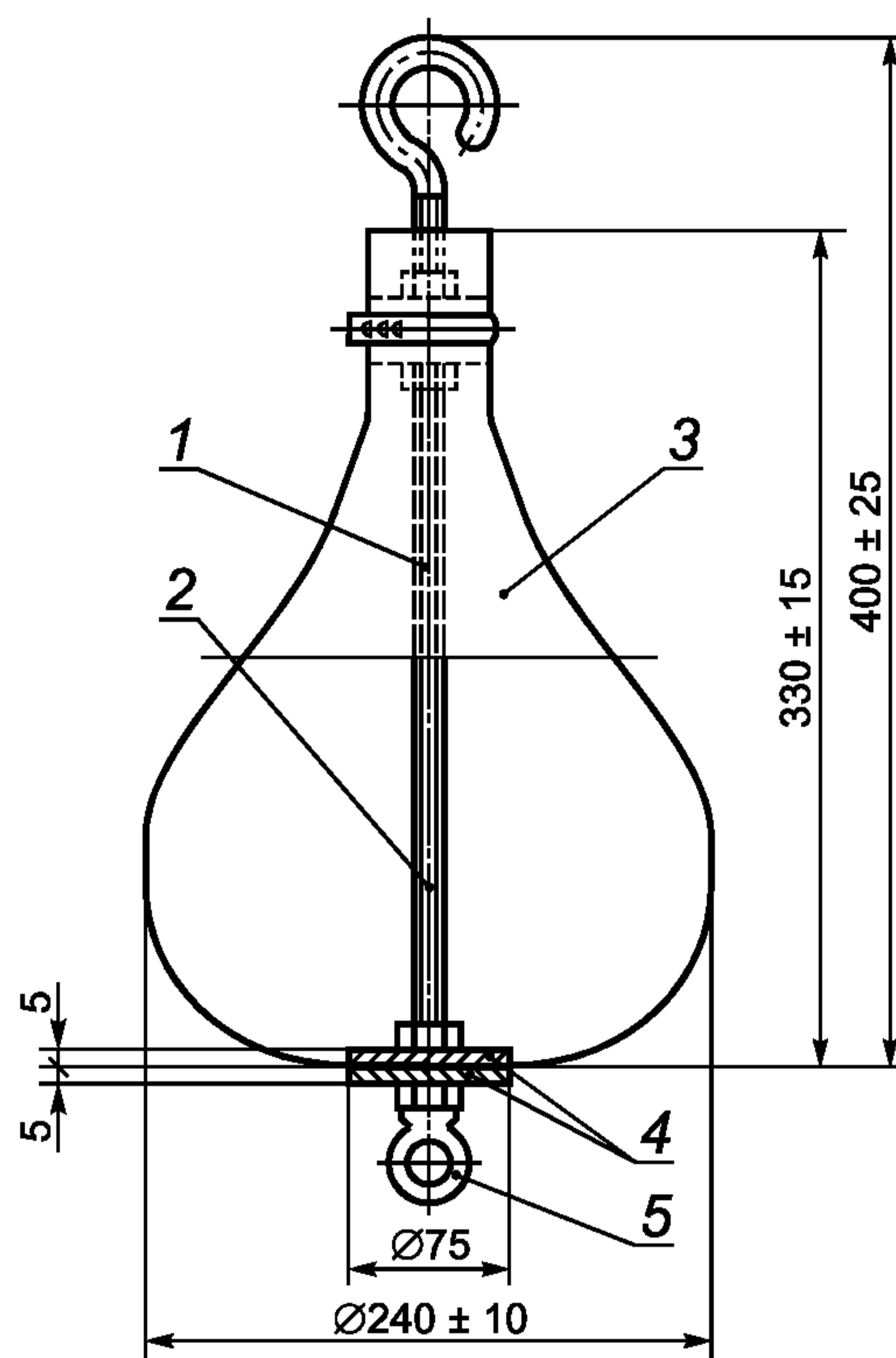
1 — стержень с нарезанной резьбой; 2 — базисная точка для измерения высоты падения в плоскости максимального диаметра;
