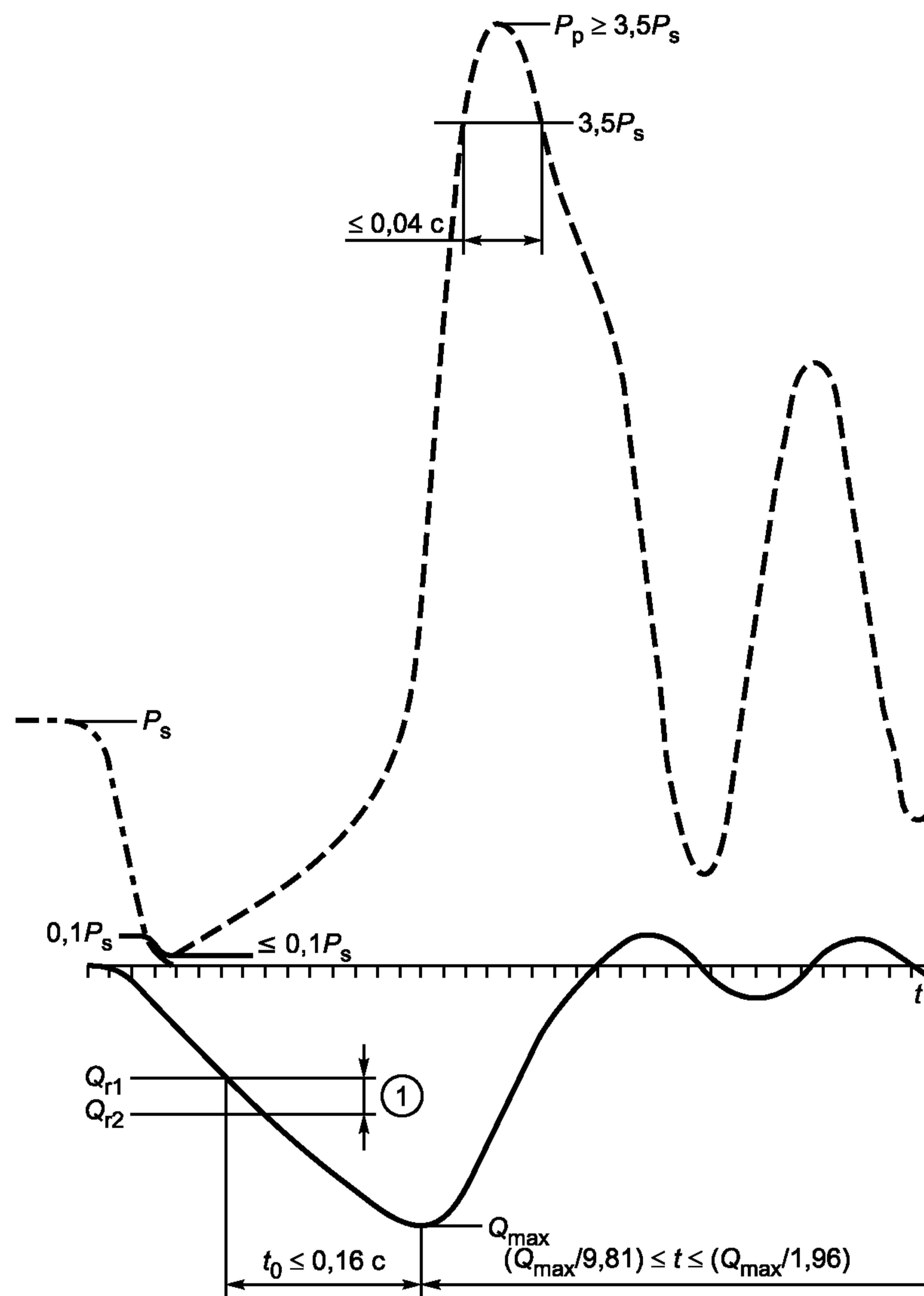
$P_p$  — пик давления;  $P_s$  — давление при статической нагрузке;  $t$  — время; ① — гидравлическое устройство безопасности должно сработать прежде, чем скорость превысит номинальную на 0,3 м/с; — ····· ····· — давление после гидравлического устройства безопасности; ————— — расход гидравлической жидкости; — ····· — давление перед гидравлическим устройством безопасности
