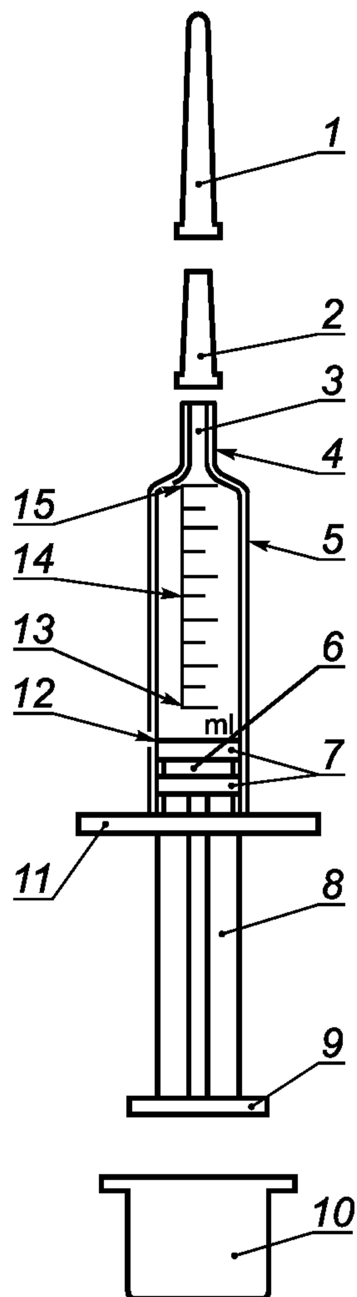
1 — колпачок иглы; 2 — колпачок для защиты наконечника; 3 — отверстие наконечника; 4 — наконечник; 5 — цилиндр; 6 — поршень; 7 — уплотнители; 8 — шток; 9 — упор штока; 10 — колпачок для защиты окончания шток-поршня; 11 — упоры для пальцев; 12 — линия начала отсчета; 13 — линия градуировки номинальной вместимости; 14 — градуировочные линии; 15 — нулевая линия
