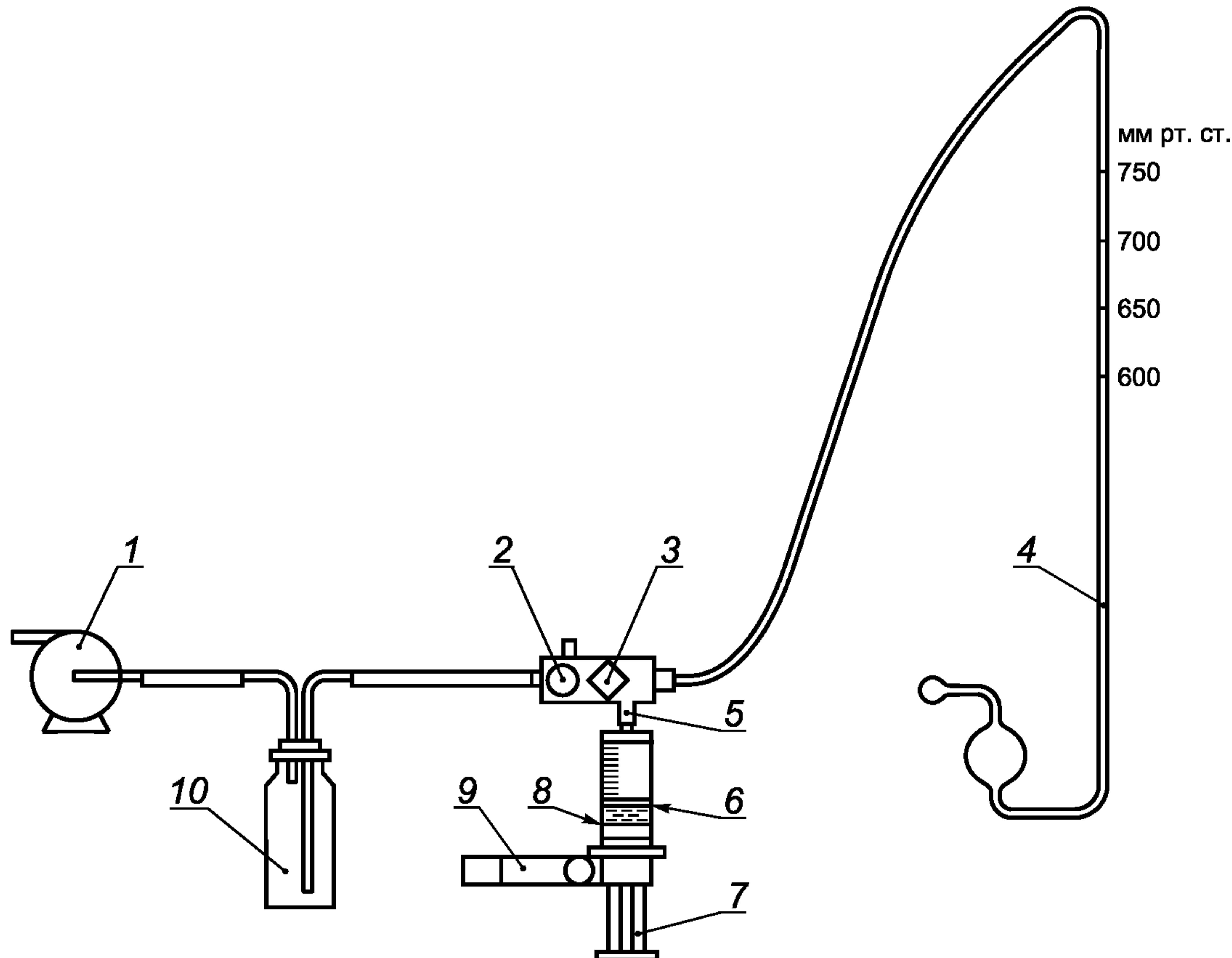
1 — вакуумный насос; 2 — регулятор отбора воздуха; 3 — вакуумный клапан; 4 — манометр; 5 — контрольная стальная или резиновая втулка по ИСО 594-1; 6 — 25 % объема  $H_2O$ ; 7 — шприц; 8 — номинальная вместимость; 9 — зажим; 10 — колба-ловушка
