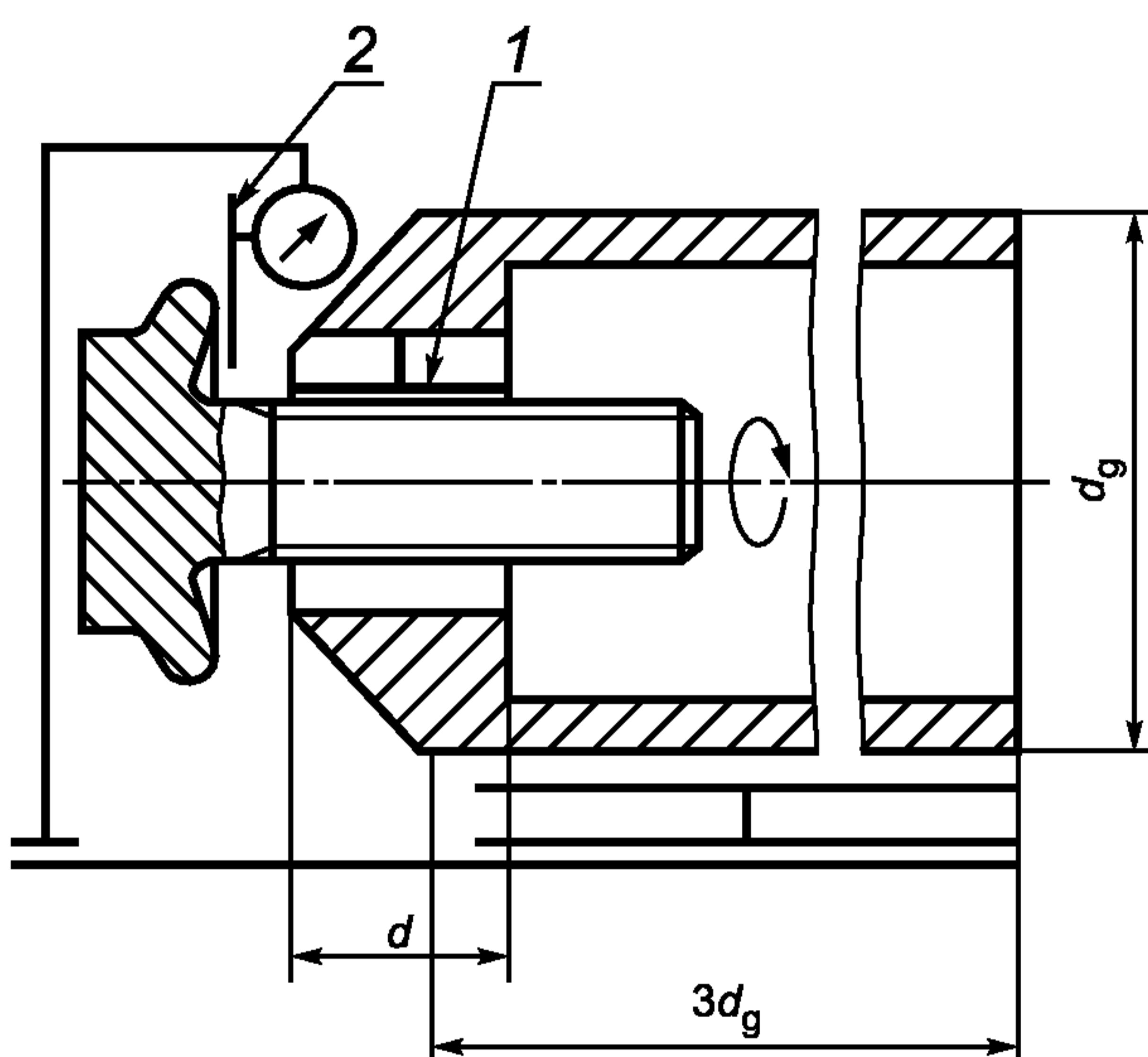
1 — трехкулаковый патрон, 2 — кромка измерительной линейки
