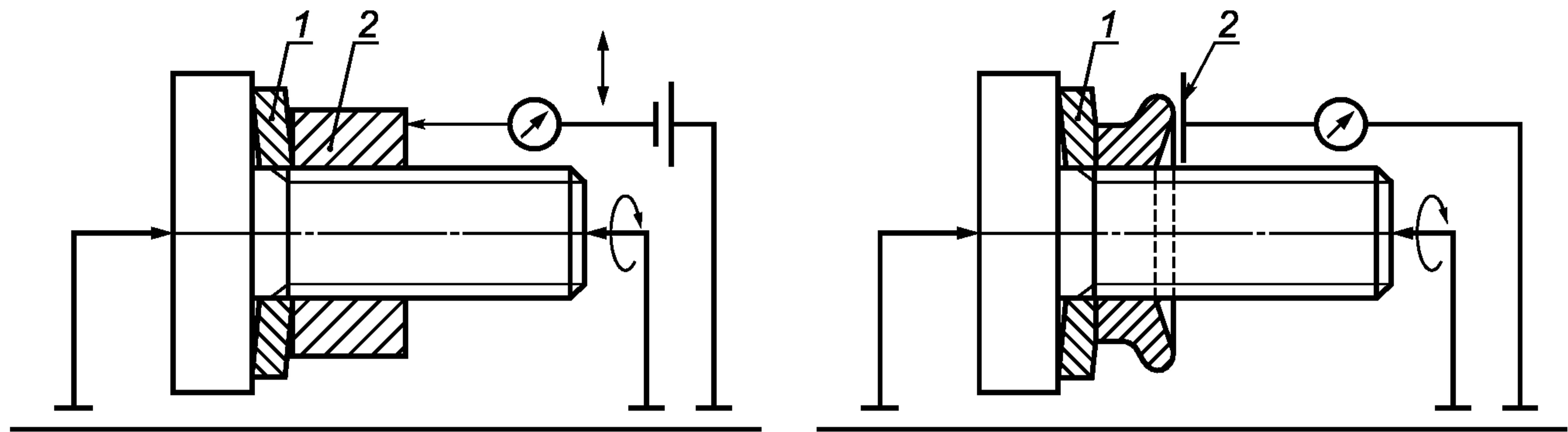
1 — коническая пружинная шайба калибра, 2 — крепежная деталь
