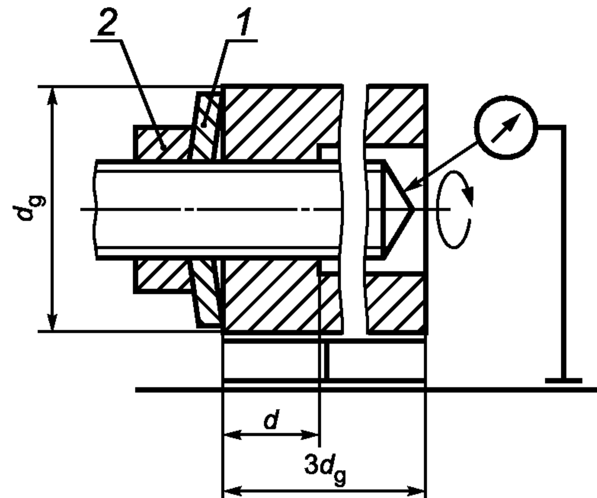
1 — коническая пружинная шайба калибра; 2 — контргайка калибра
