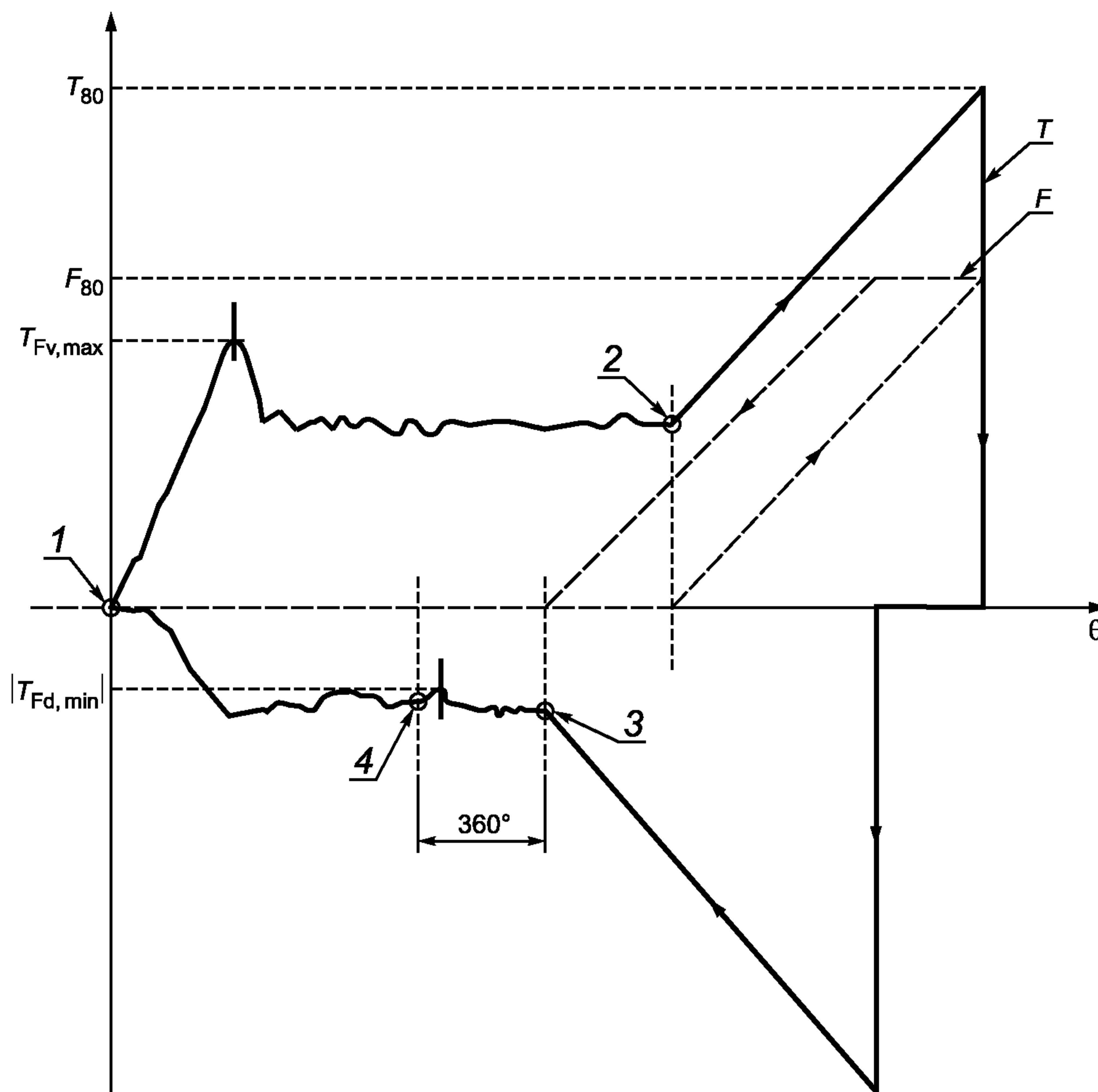
$F$  — усилие предварительной затяжки;  $T$  — крутящий момент;  $\theta$  — угол поворота; 1 — точка, в которой впервые возникает стопорящий момент при закручивании и начинается измерение  $T_{Fv}$ ; 2 — точка посадки, окончание измерений  $T_{Fv}$ ; 3 — отсутствие контакта с испытательной пластиной/шайбой, начало измерения  $T_{Fd}$ ; 4 — окончание измерения  $T_{Fd}$
