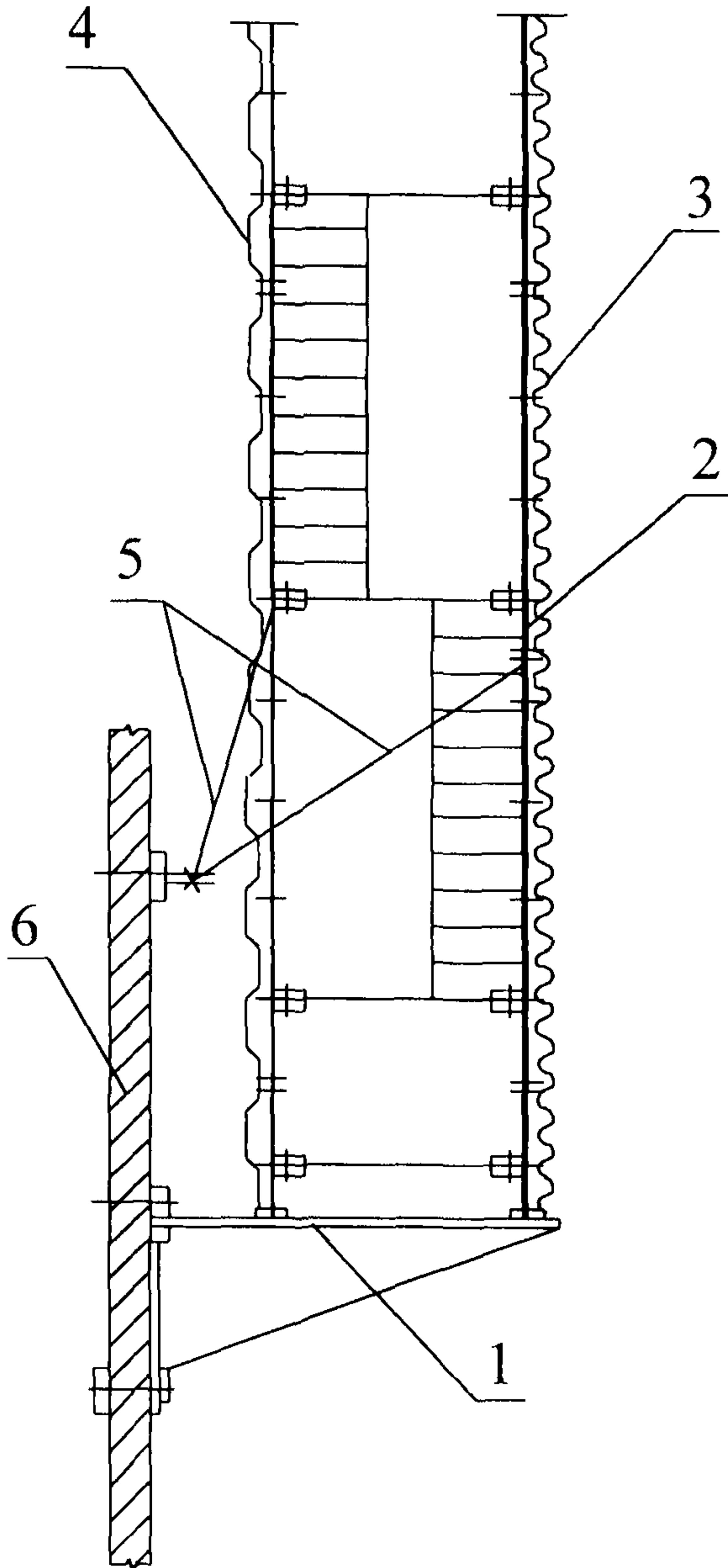
1 – консоль настенная; 2 – леса строительные; 3 – сетка декоративная; 4 – профнастил ограждения; 5 – связи; 6 – возводимое здание
