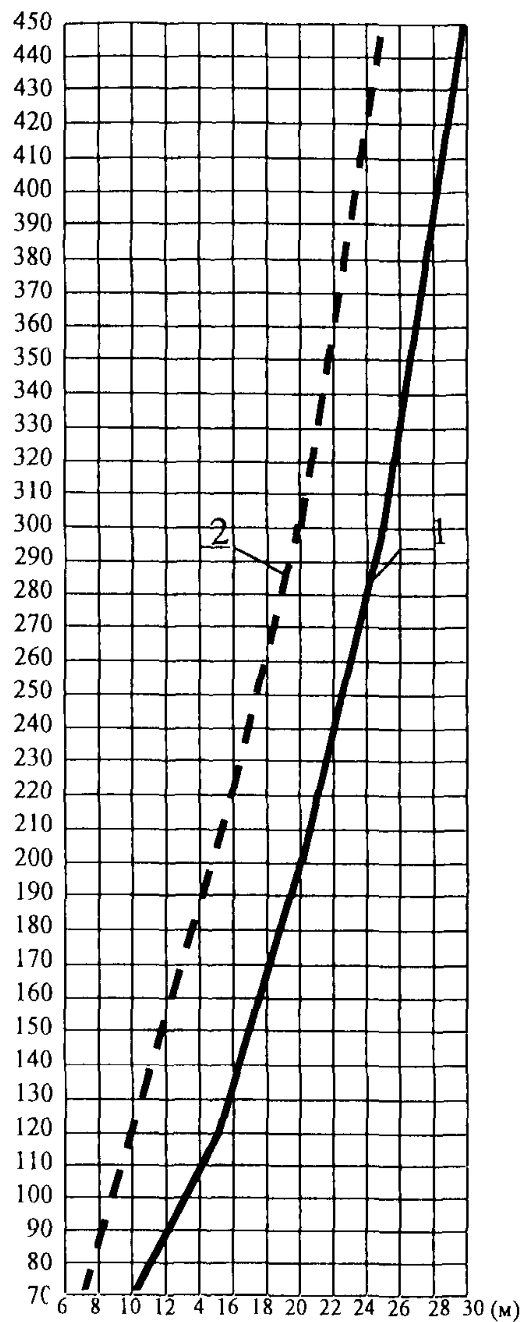
Рисунок 11 – График определения минимального расстояния отлета груза при его падении
