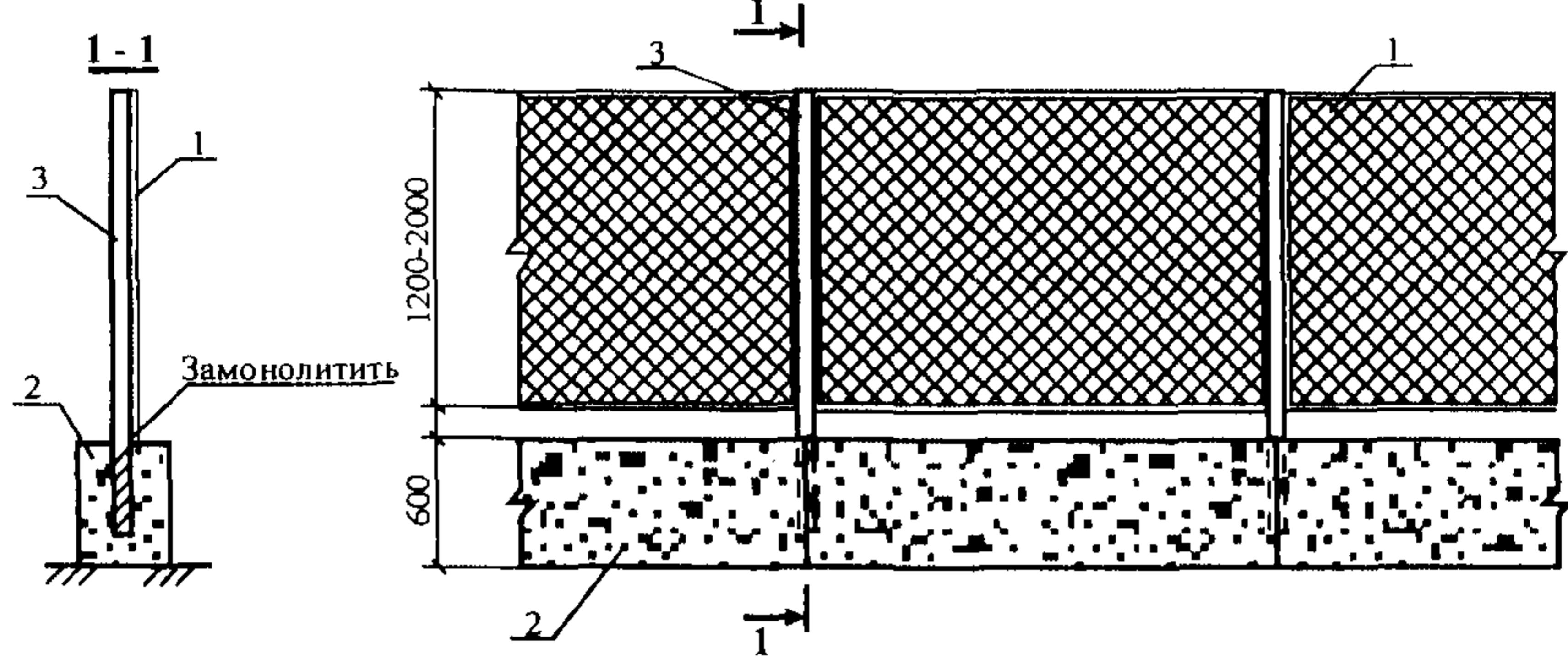
1 – металлическая сетка «Рабитца» на металлическом каркасе;
