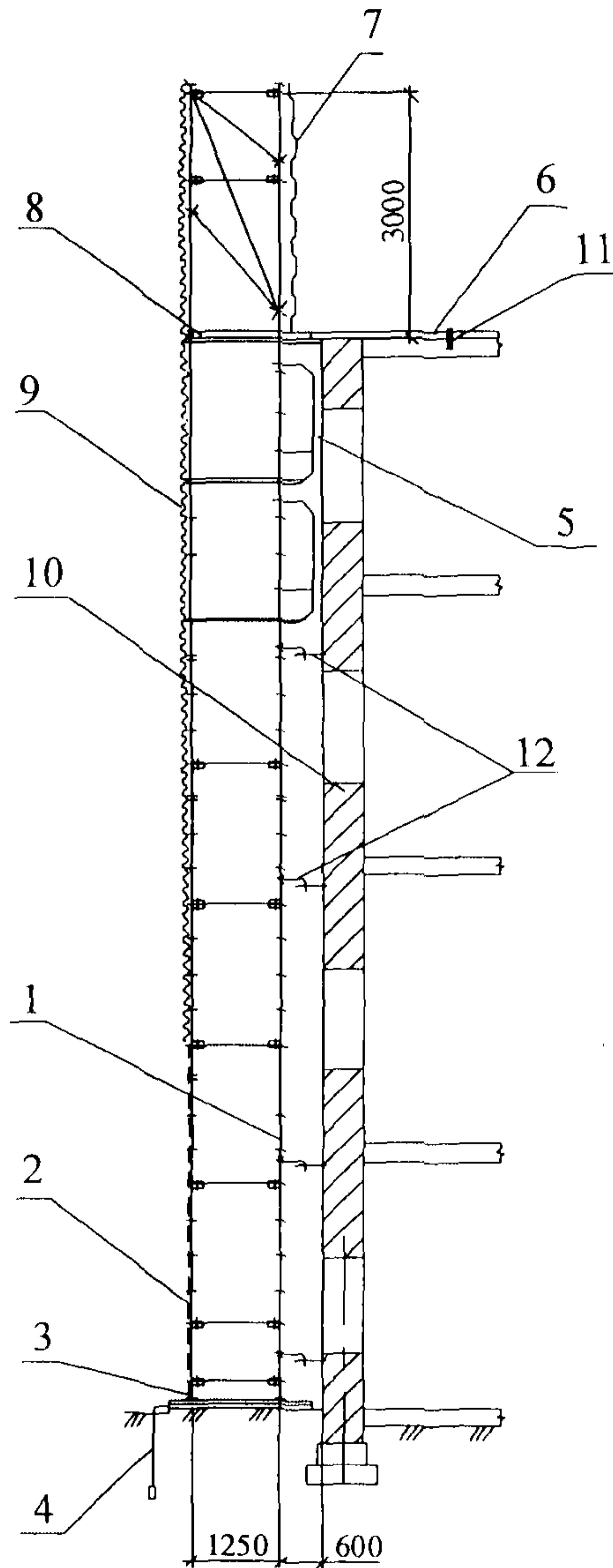
1 – леса строительные; 2 – щит декоративный; 3 – опора винтовая; 4 – заземление;
