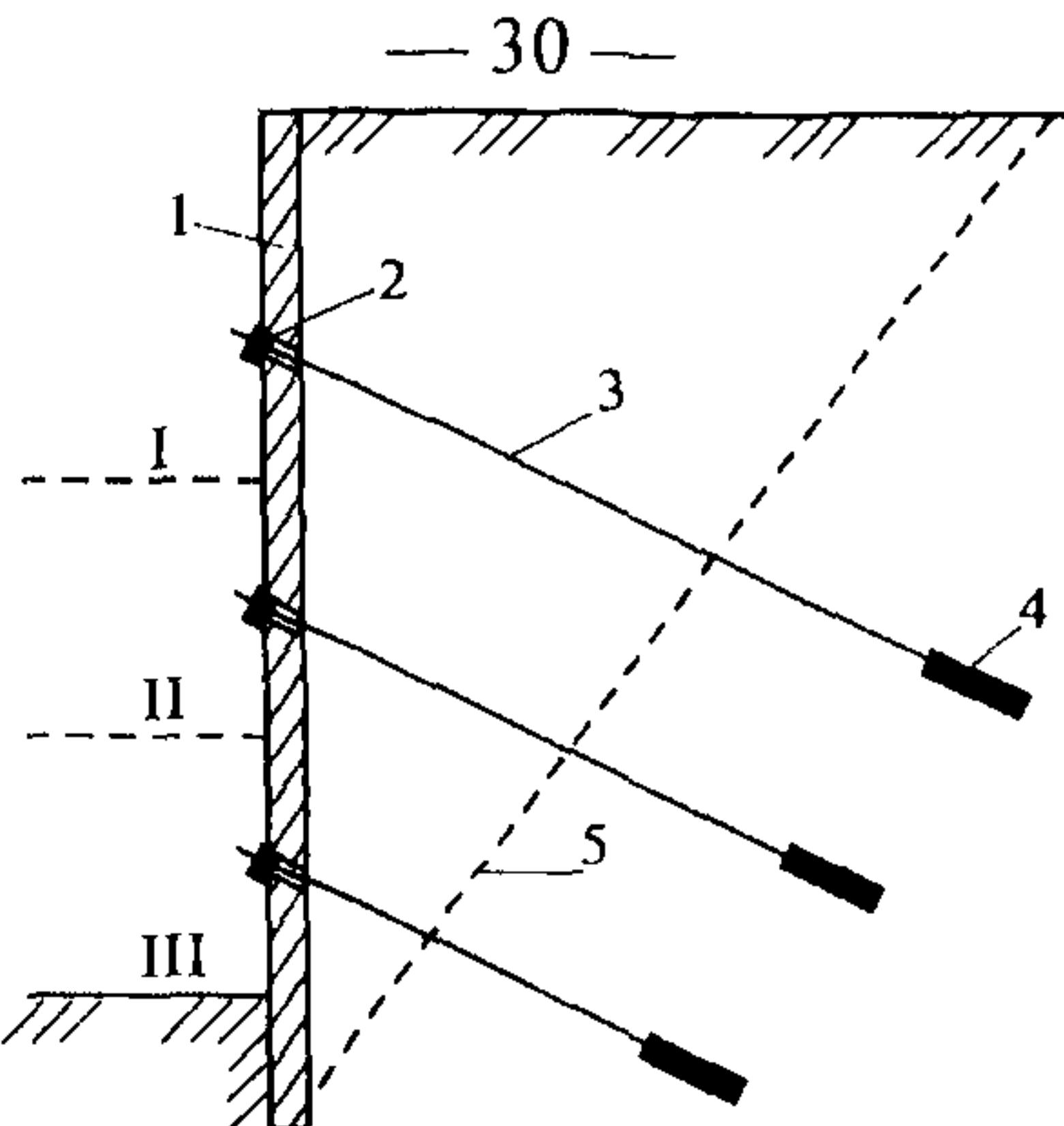
1 – стенка; 2 – стопорное устройство; 3 – тяга; 4 – рабочая часть анкера;
