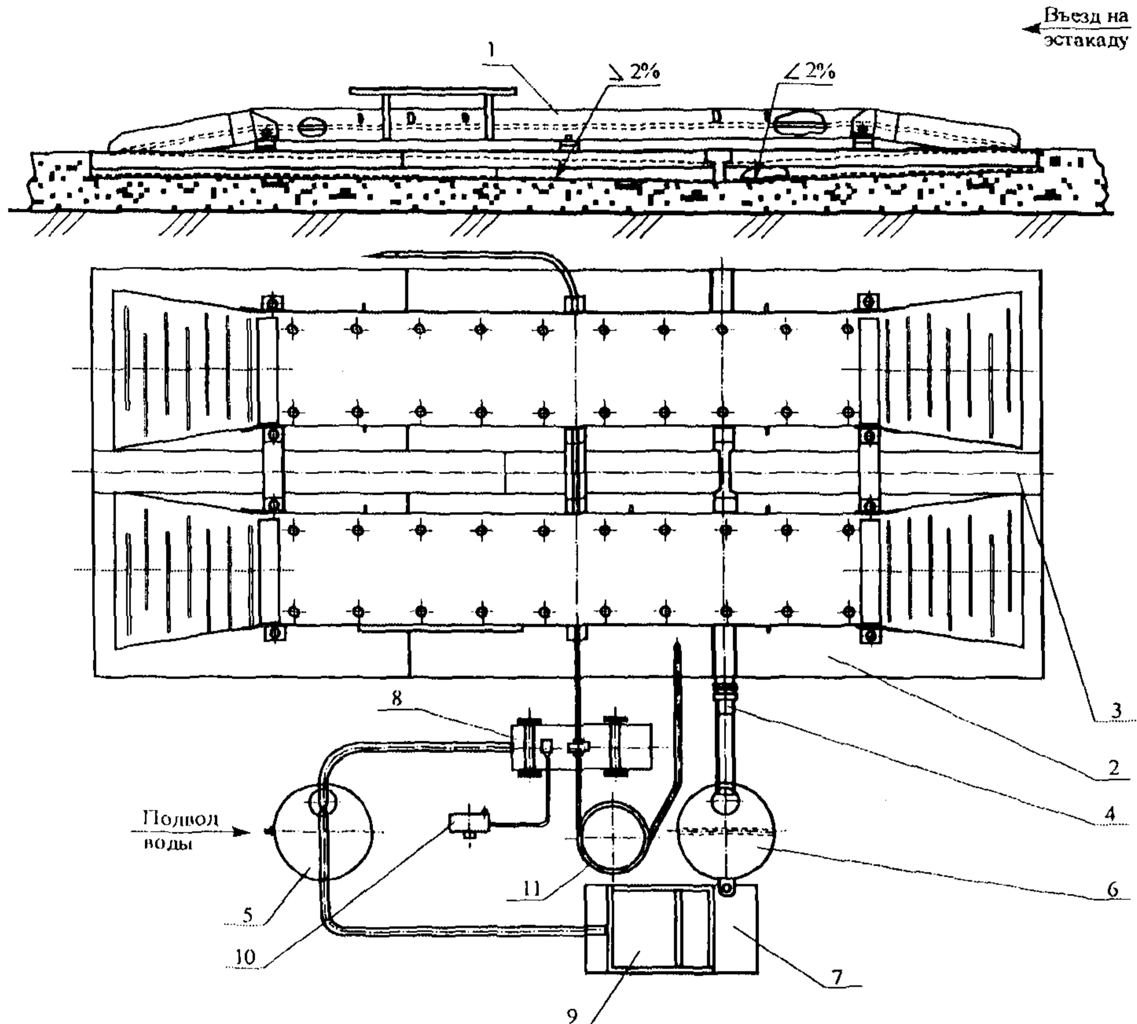
Установка для мойки колес автотранспорта представляет собой сборно-разборную эстакаду (1), состоящую из плиты дорожной (2), желоба сливного продольного (3) и желоба сливного поперечного (4) с баком водозаборным (5) и двумя баками-отстойниками (6, 7) и оснащена покупными установками моечной модели (8) и оборотного водоснабжения (9), а также электроштрафа (10) и шланга моечного (11).
