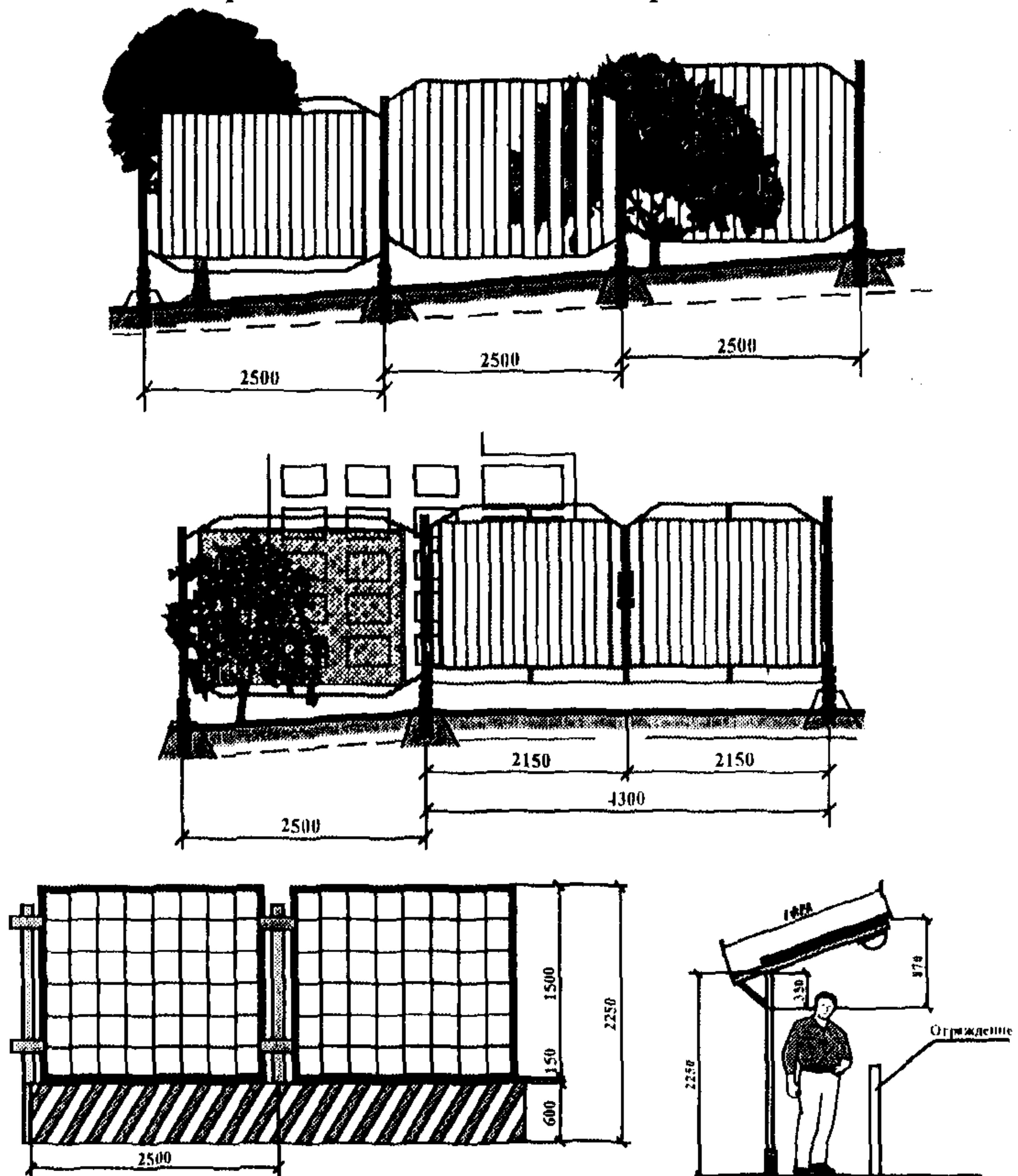
Рисунок 5 – Унифицированные инвентарные ограждения строительных площадок
