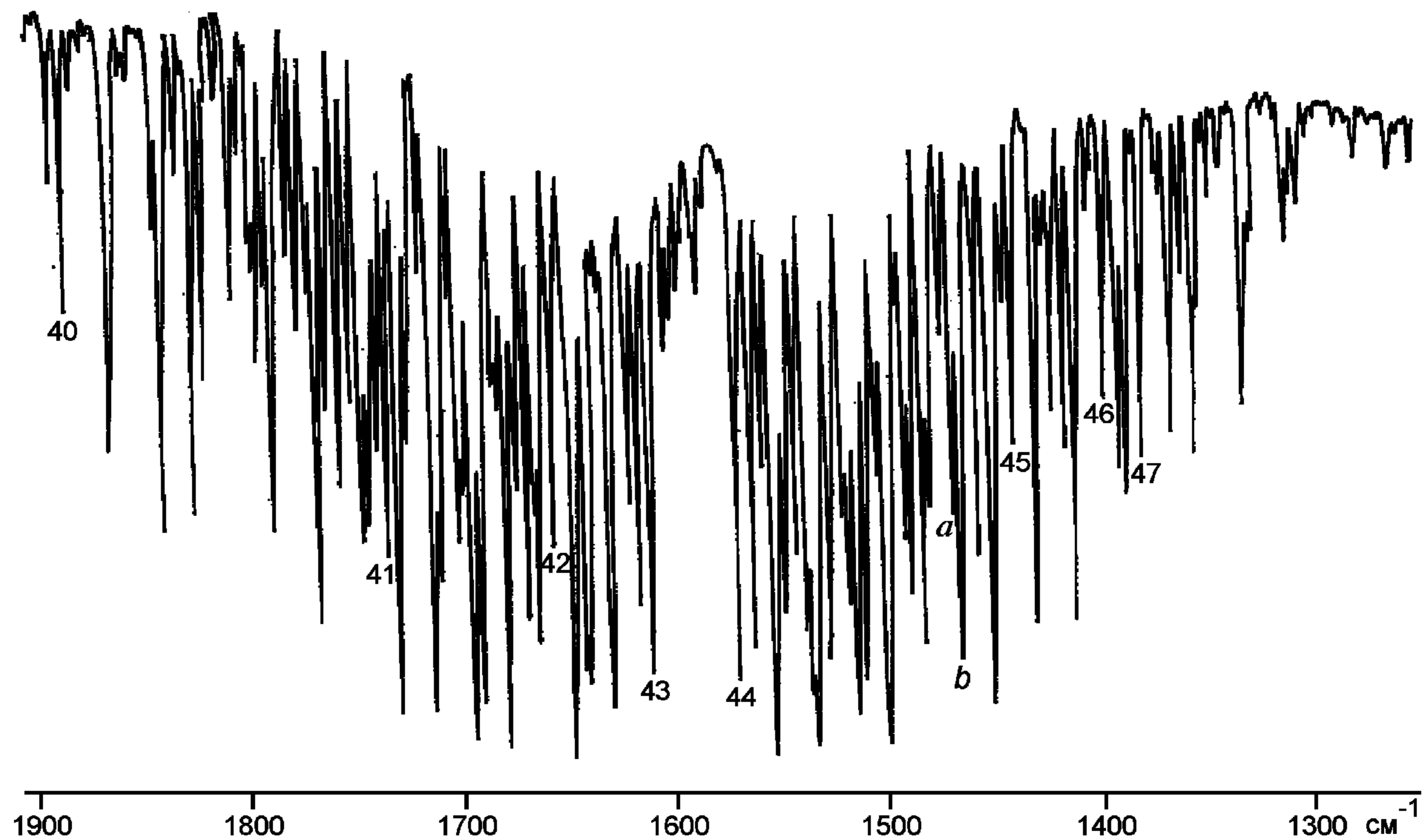
Рисунок Б.4 — Спектр поглощения паров воды в атмосфере
