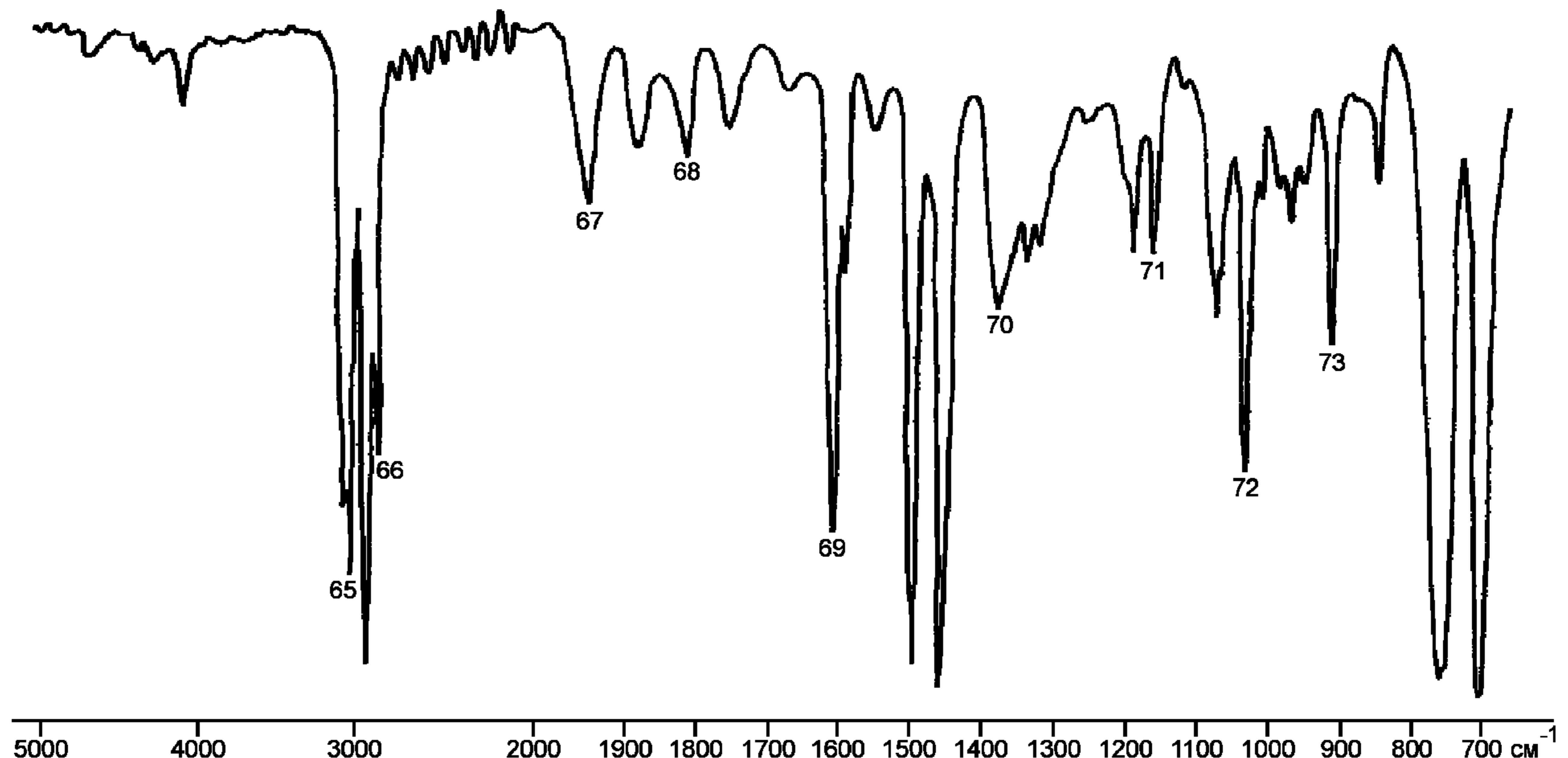
Рисунок Б.8 — Спектр поглощения полистирола при регистрации на спектрофотометре типа ИКС-22
