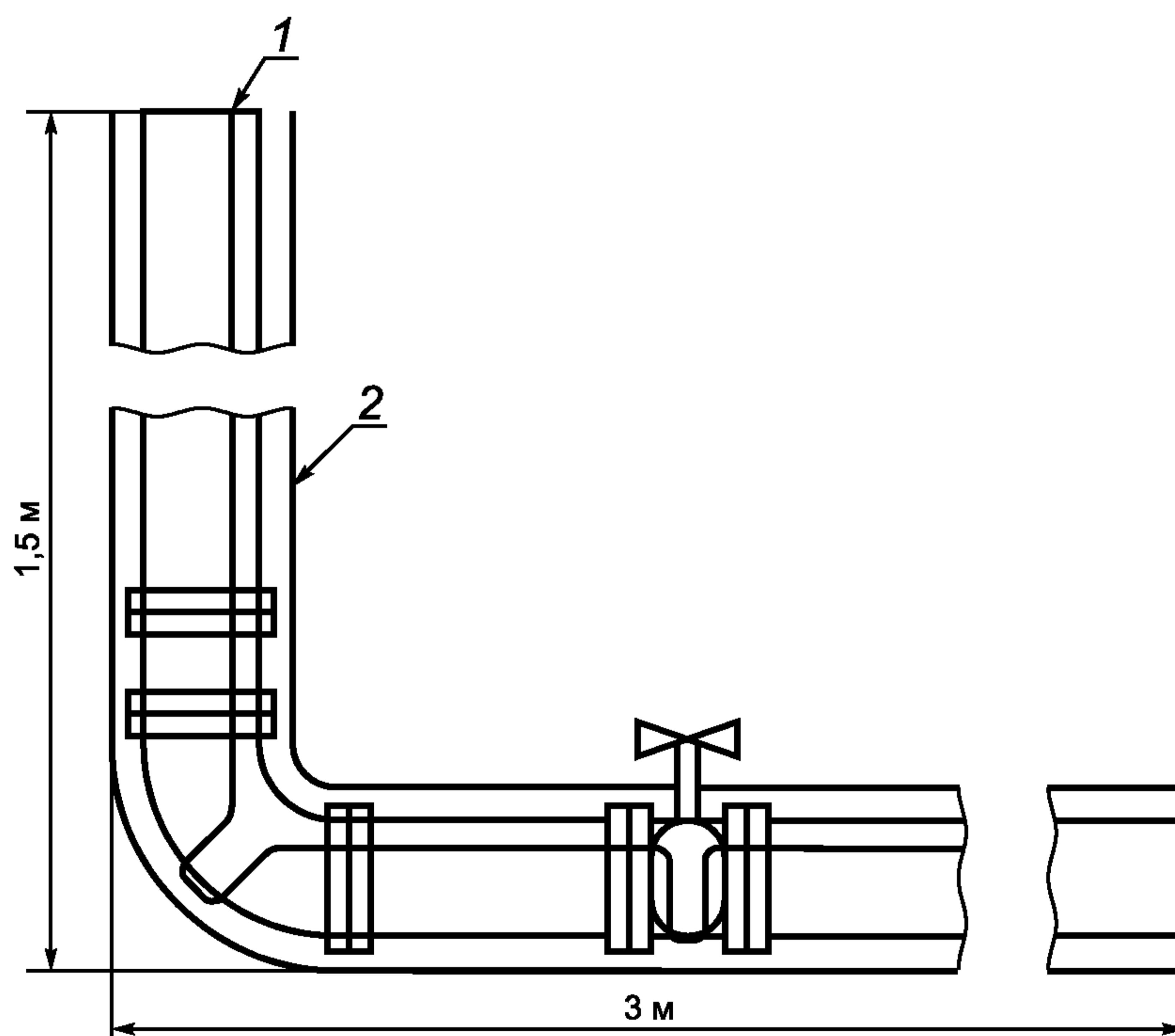
1 — номинальное сечение трубы от 50 до 150 мм; 2 — изоляция из стекловолокна минимальной толщиной 25 мм, плотностью около 3,25 кг/м<sup>3</sup>
