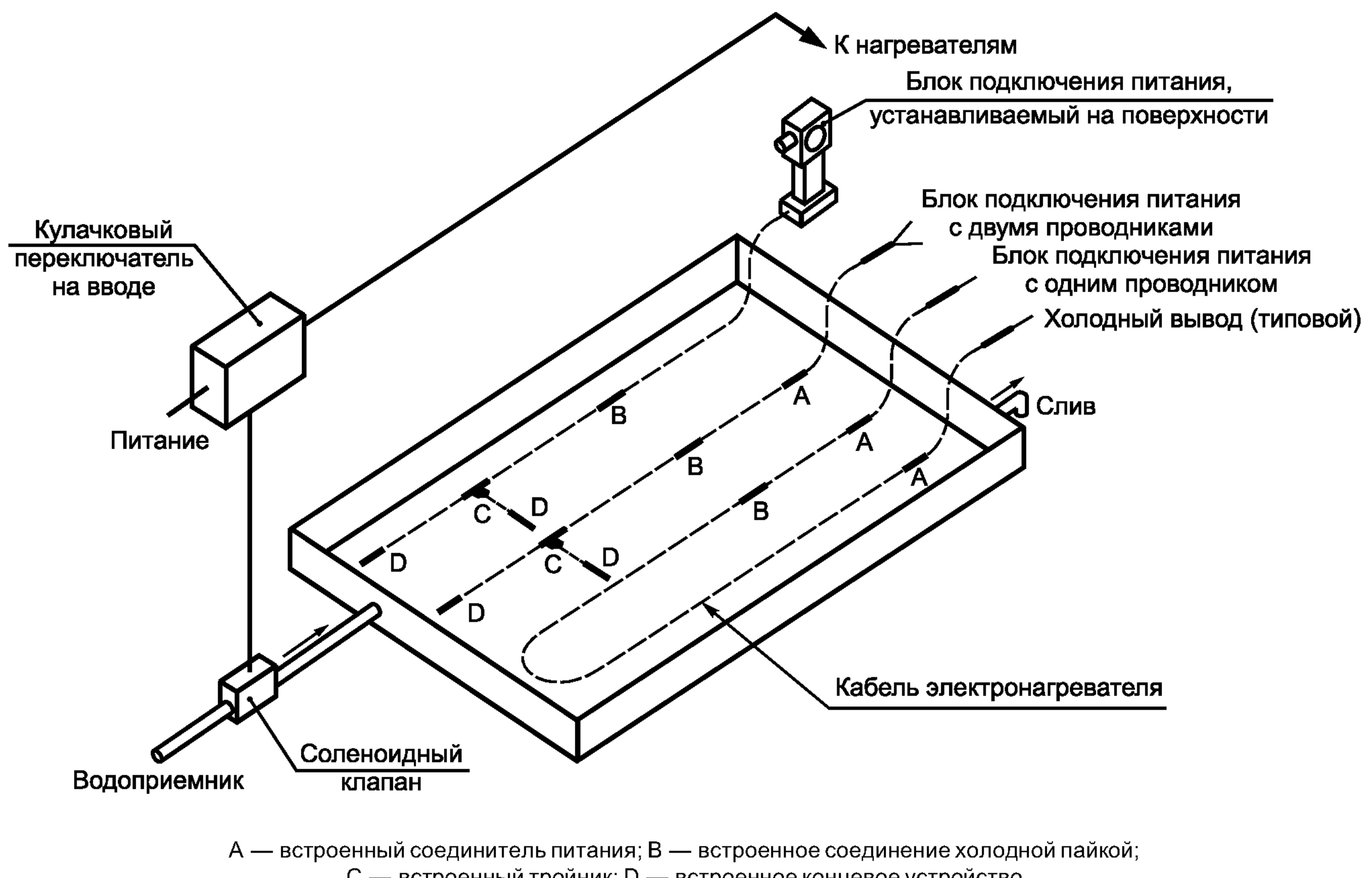
Рисунок 4 — Испытание встроенных компонентов на влагостойкость
