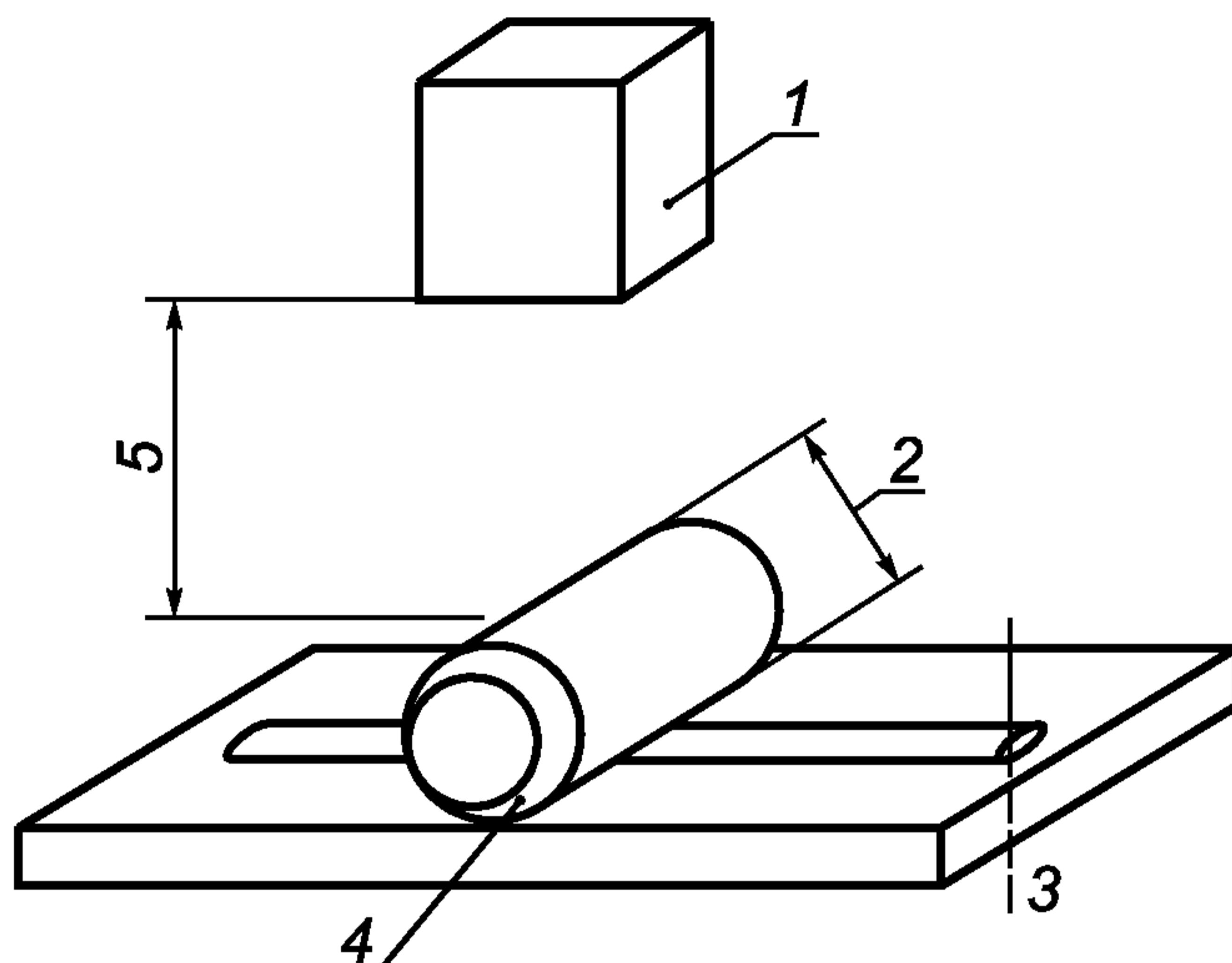
1 — боек массой 1 кг; 2 — цилиндр диаметром 25 мм;
