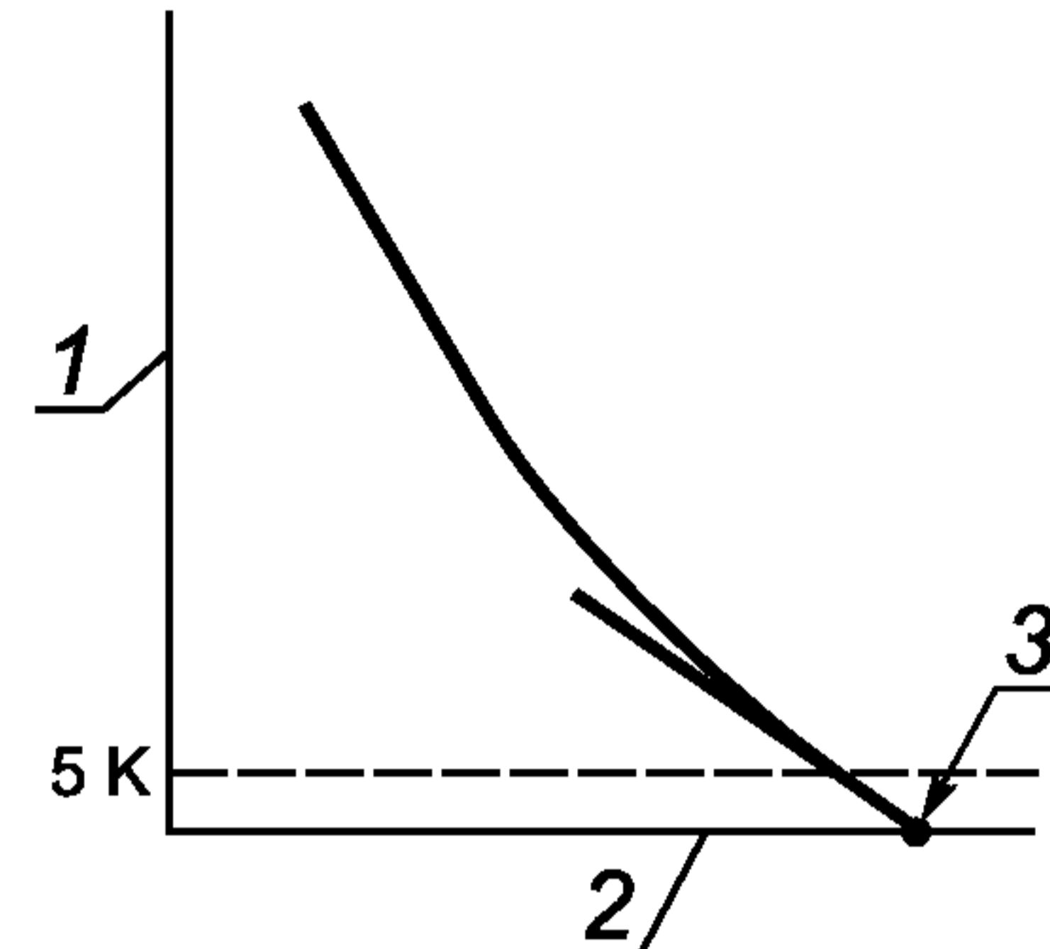
1 — температура образца минус температура воздуха в печи ( $T_s - T_o$ ), К; 2 — температура в печи  $T_o$ , °C; 3 — зарегистрированное значение температуры  $T_s$ , °C
