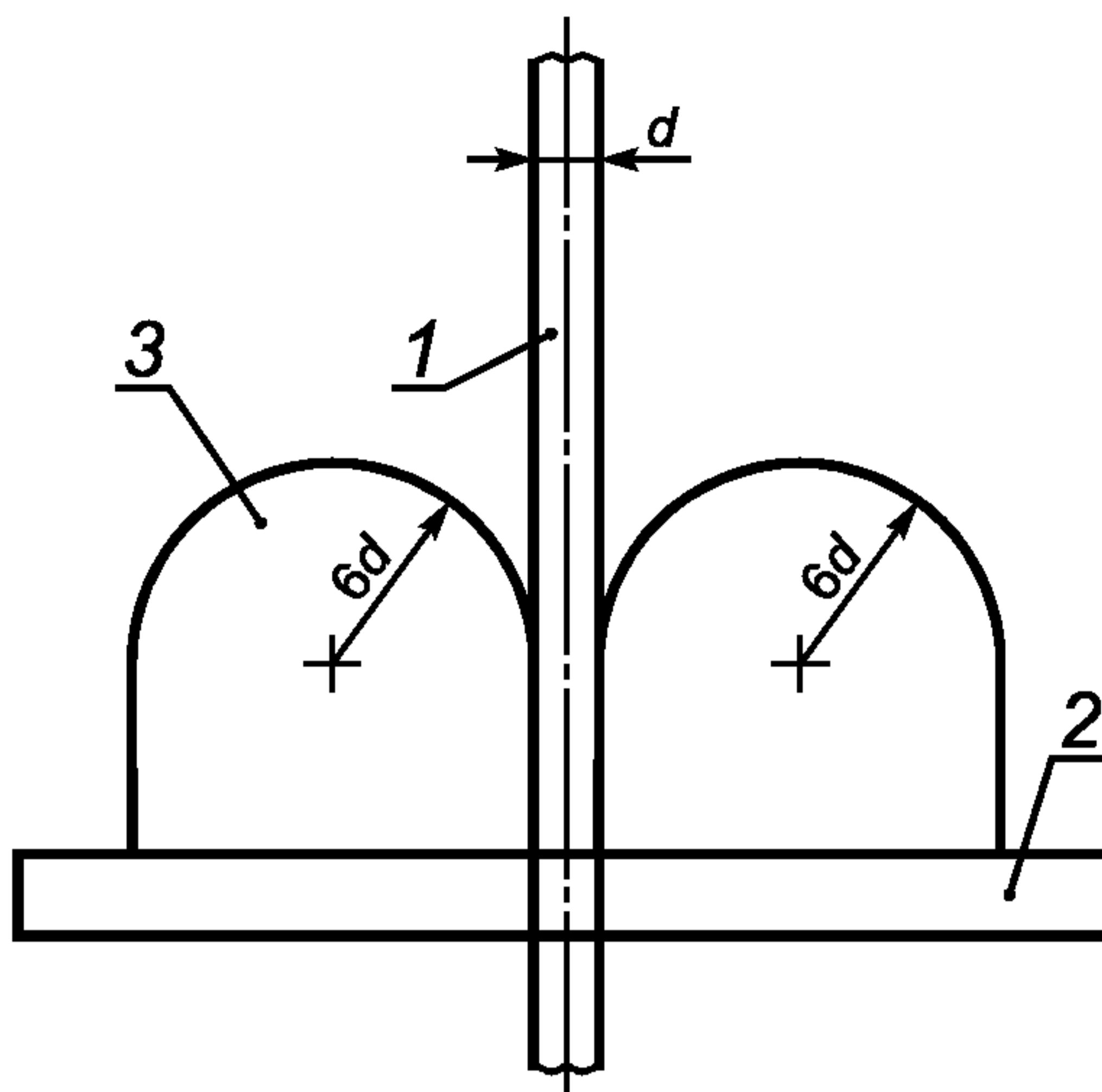
1 — образец резистивного распределенного электронагревателя; 2 — стальное основание; 3 — металлическая оправка;
