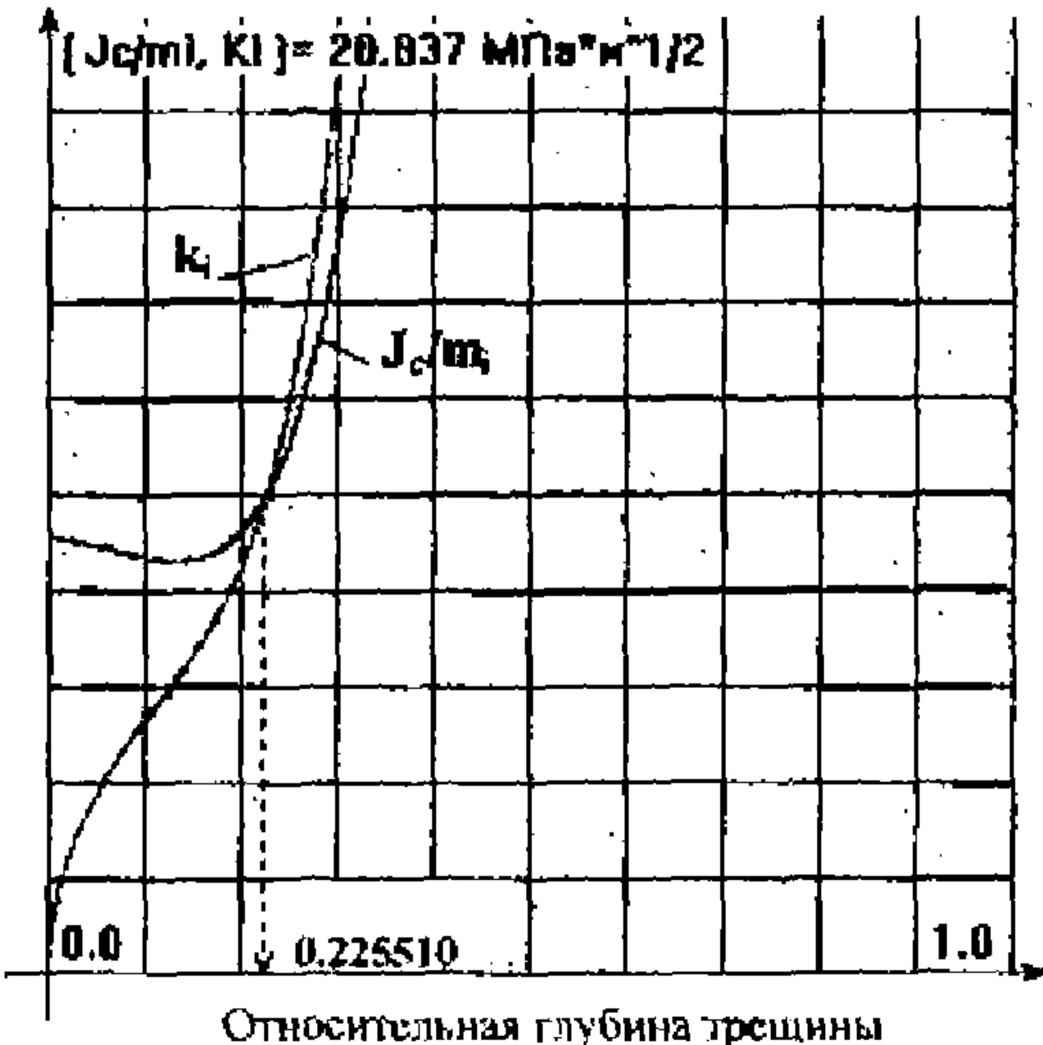
График определения относительной критической глубины трещины
