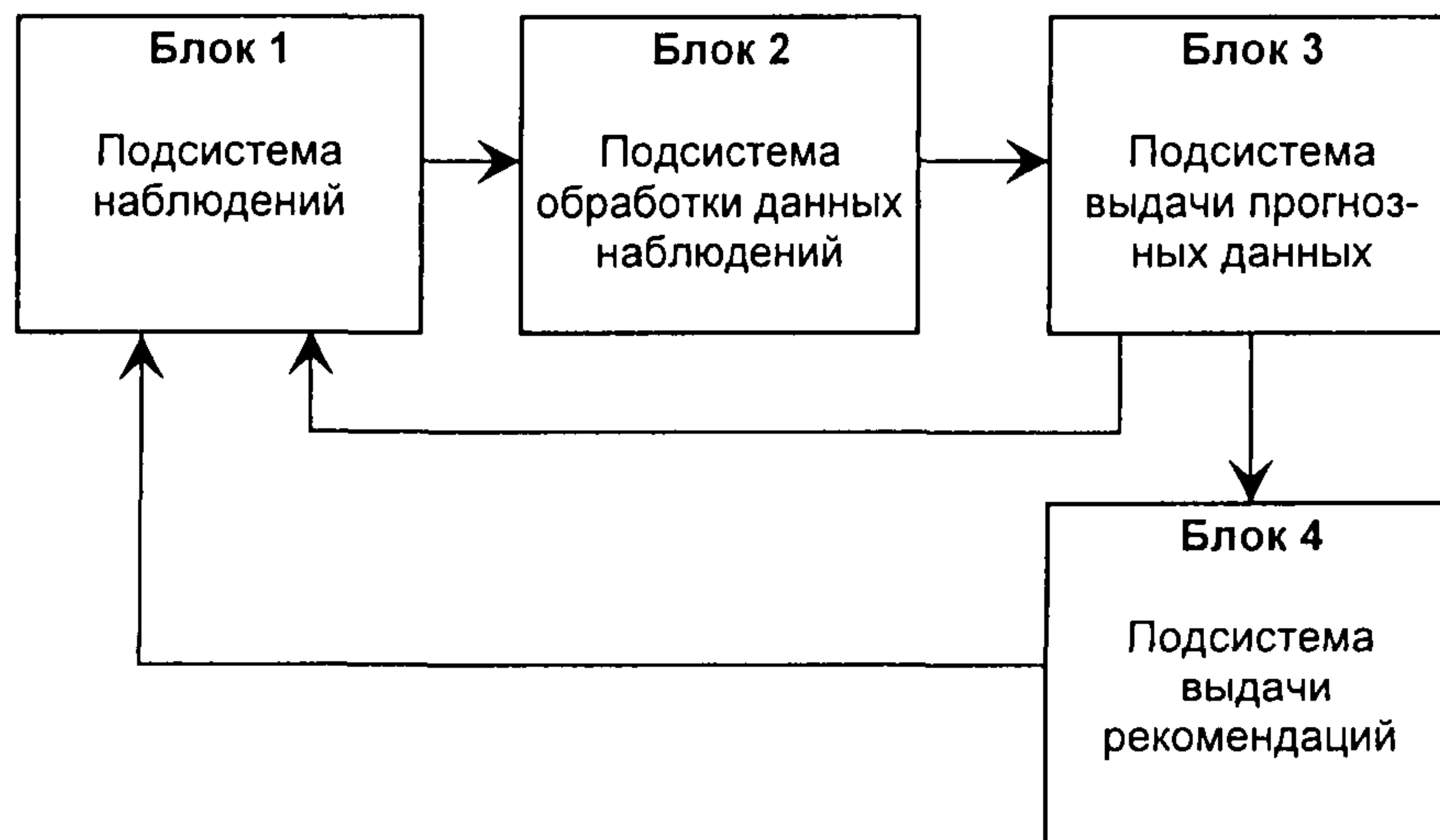
Рис. 1. Блок-схема системы мониторинга
