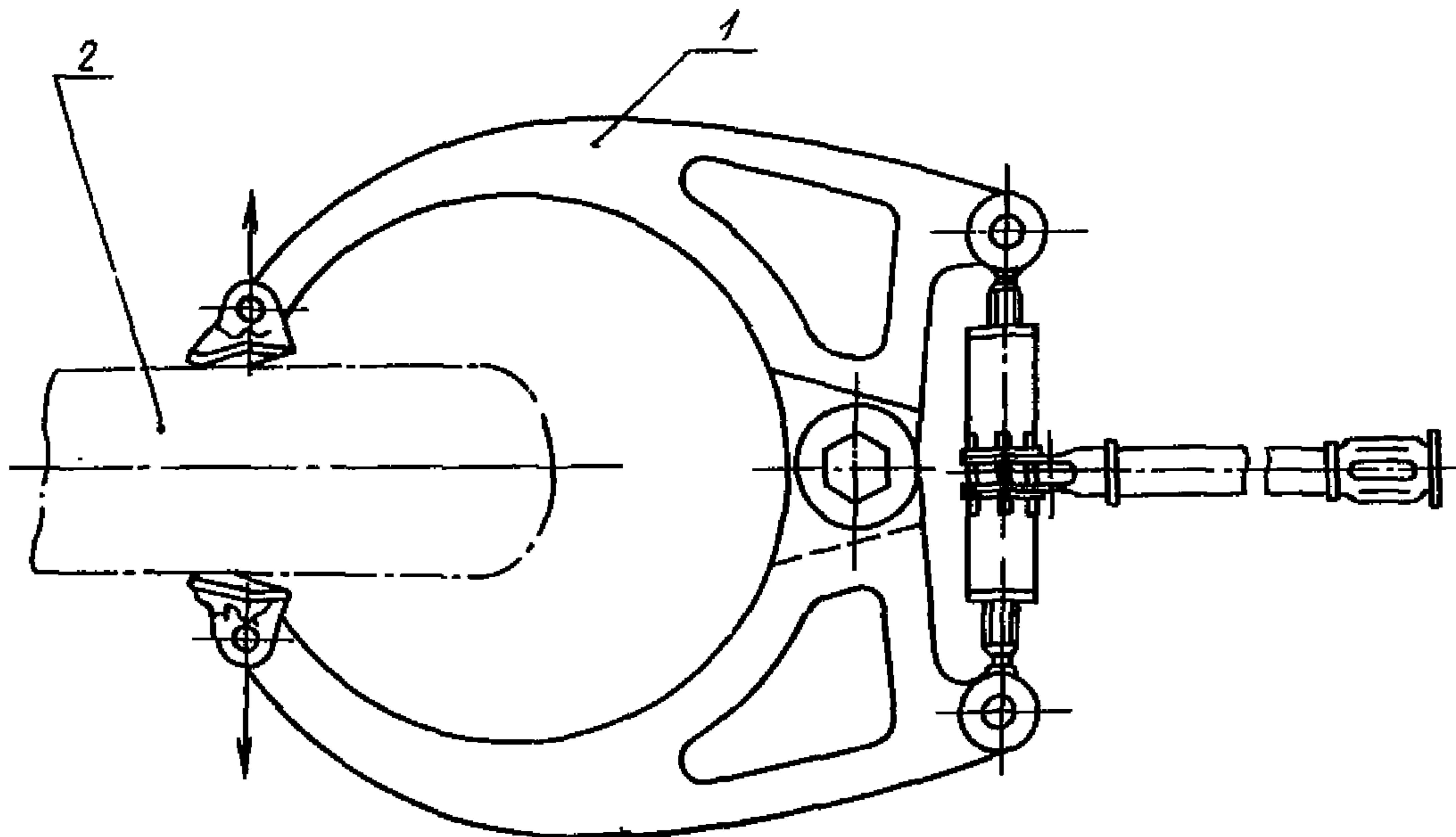
\*1 - съемник шин; 2 - макет колеса
