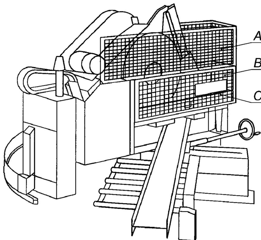
А — стационарное ограждение, смонтированное на (шарнирной) режущей головке над верхней половиной режущего диска;
