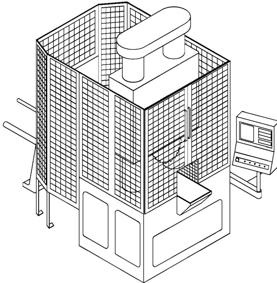
Неподвижные и самозакрывающиеся шарнирные ограждения, включающие регулируемое ограждение места выгрузки отрезанных заготовок.
