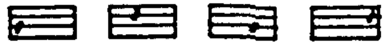
2.12. При расположении известняка в вагонах в виде конусов, отбор точечных проб производится с поверхности выступающей части конуса. Точки отбора при этом по возможности располагают по образующей конуса, сдвинутой примерно на  $(40 \pm 10)^\circ$  по отношению к длинной оси вагона на высоте, не превышающей 2/3 высоты
