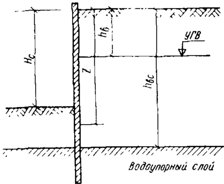
Рис. 1. Расчетная схема для определения величины  $p_{г.б}$
