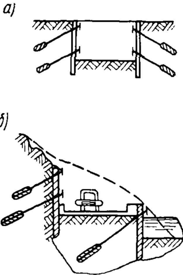
Рис. 38. Примеры применения анкеров для крепления стен заглубленных помещений (а) и подпорных стен (б)
