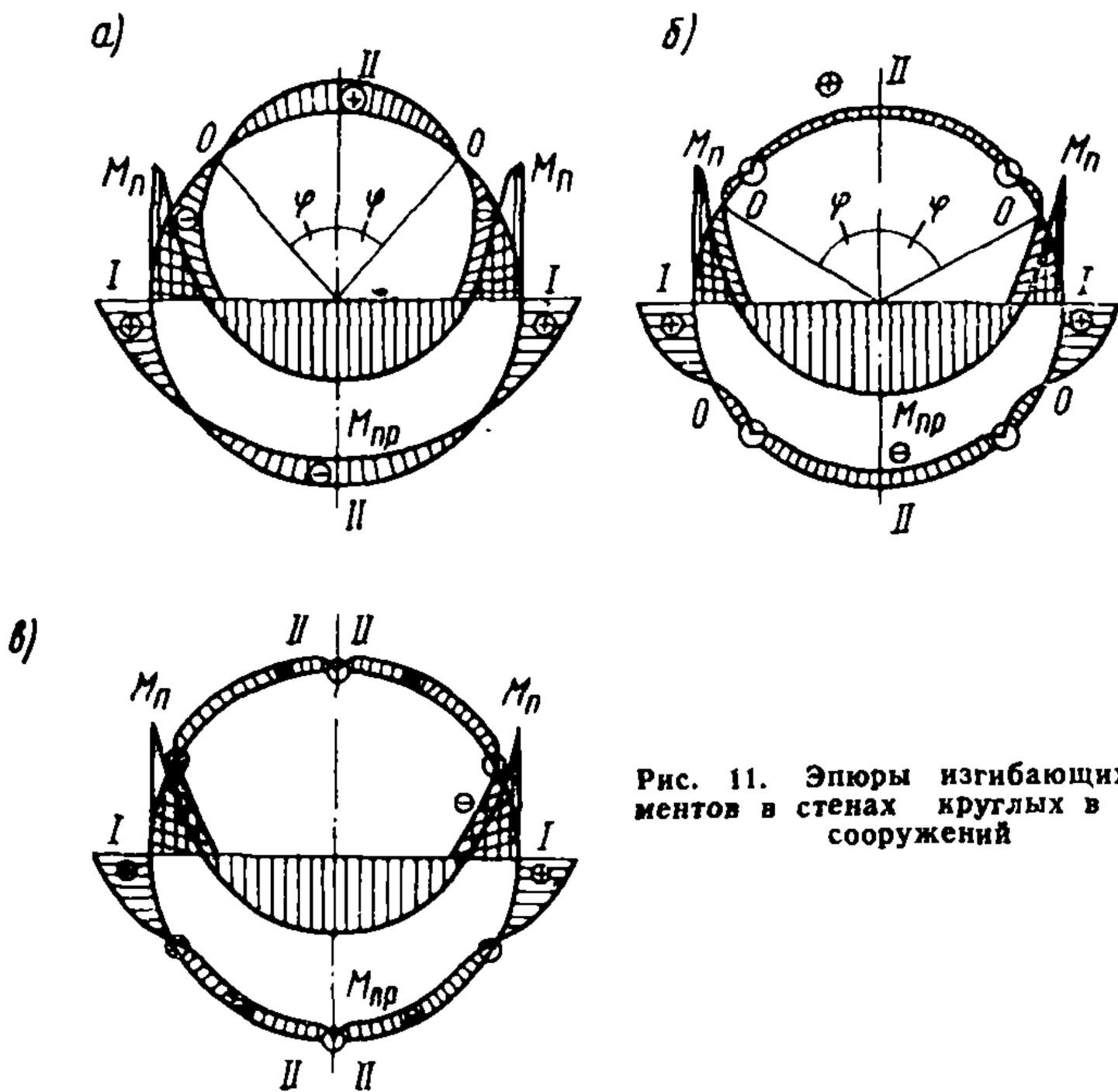
Рис. 11. Эпюры изгибающих моментов в стенах круглых в плане сооружений
