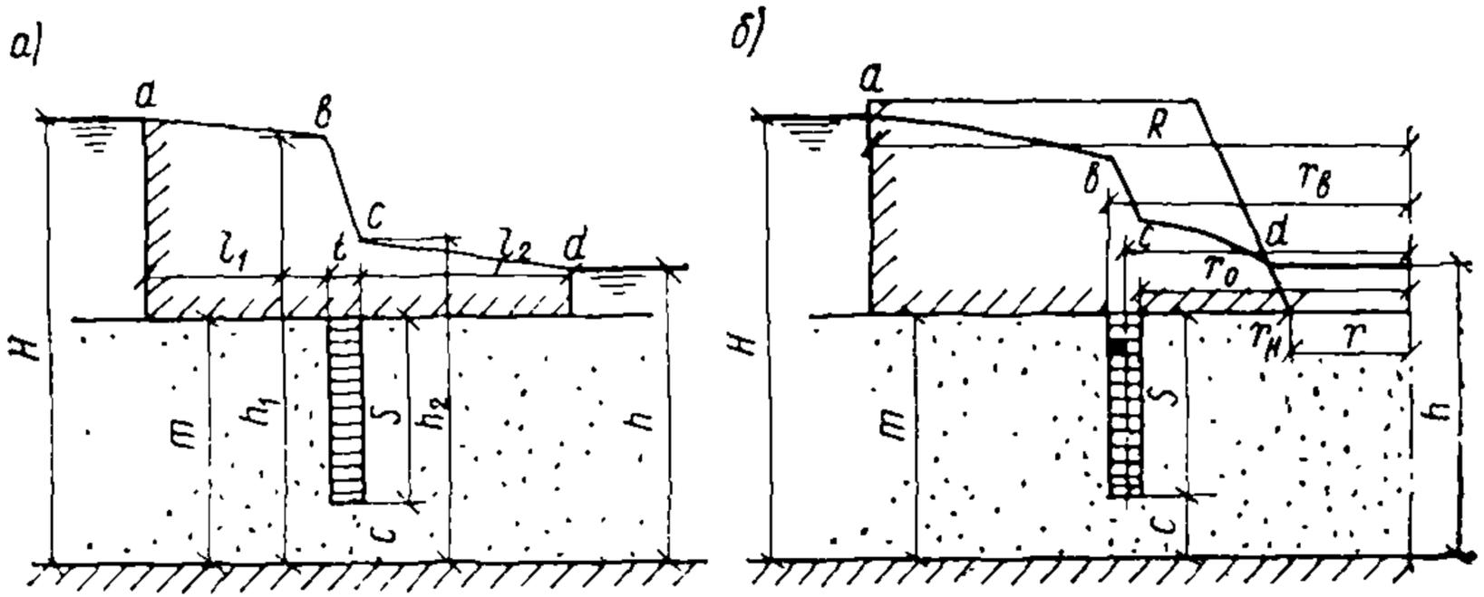
Рис. 16. Обозначения размеров области фильтрации
