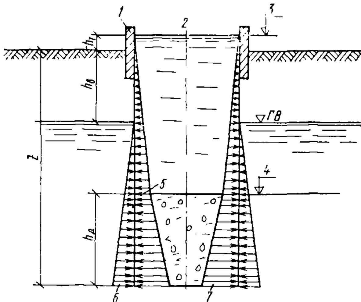
Рис. 2. Расчетная схема для определения величины  $p_{г1}$
