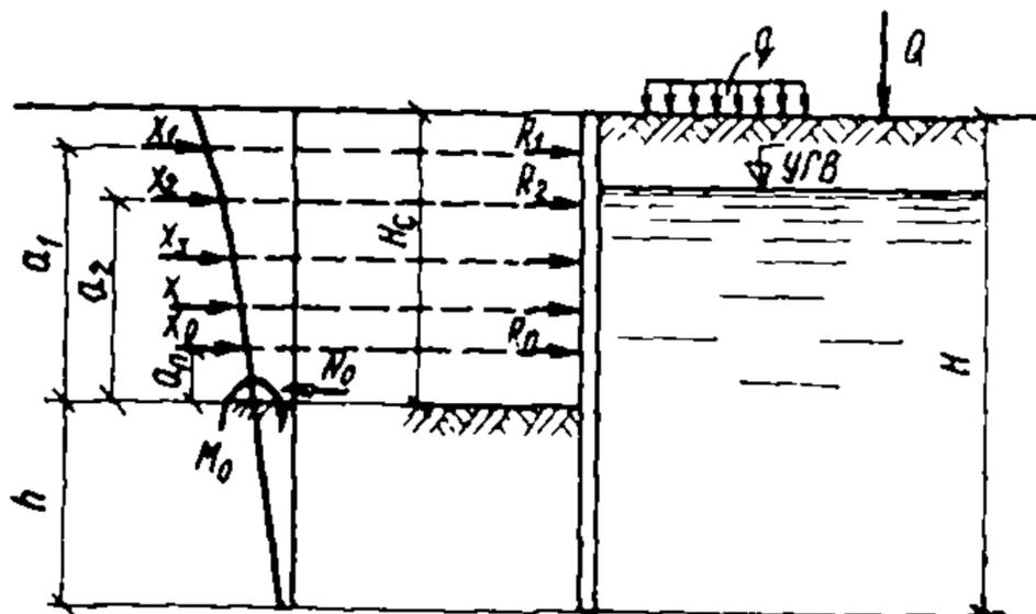
Рис. 7. Расчетная схема стены с опорами
