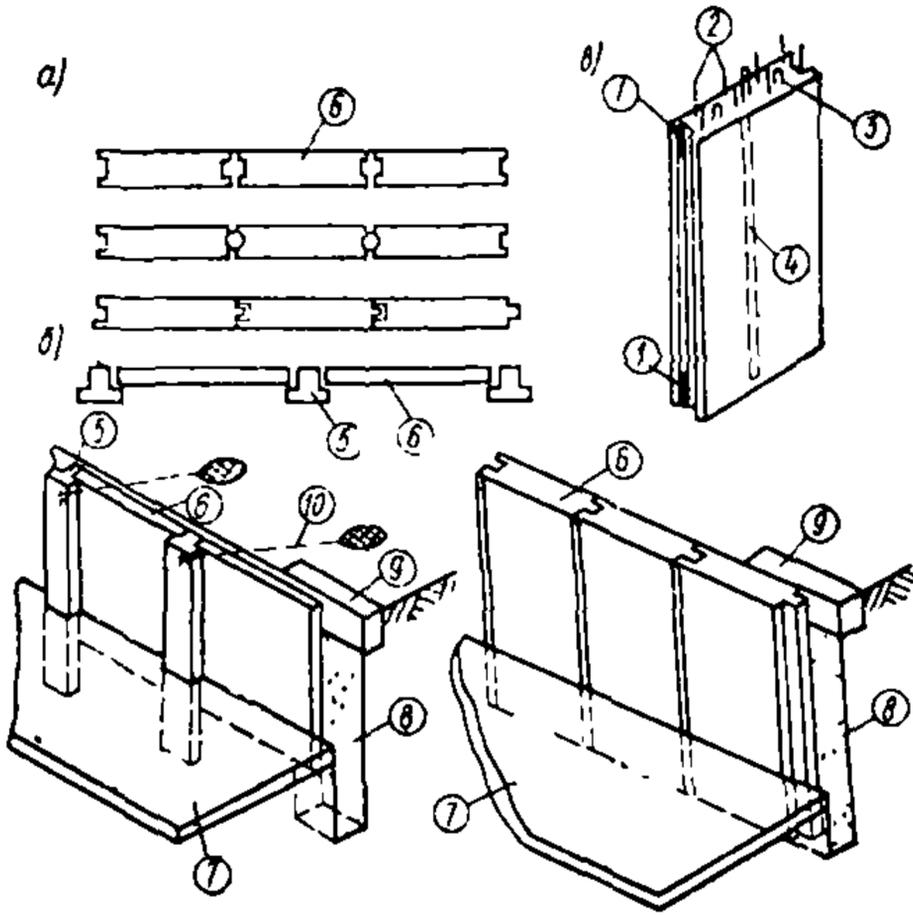
а — конструкция стен из панелей; б — конструкции стен типа «панели-стойки»; в — стенная панель; 1 — закладные детали; 2 — выпуска арматуры; 3 — монтажные петли; 4 — инъекционная трубка; 5 — стойка; 6 — стеновые панели; 7 — плита днища; 8 — тампонажный материал; 9 — форшахта; 10 — анкер
