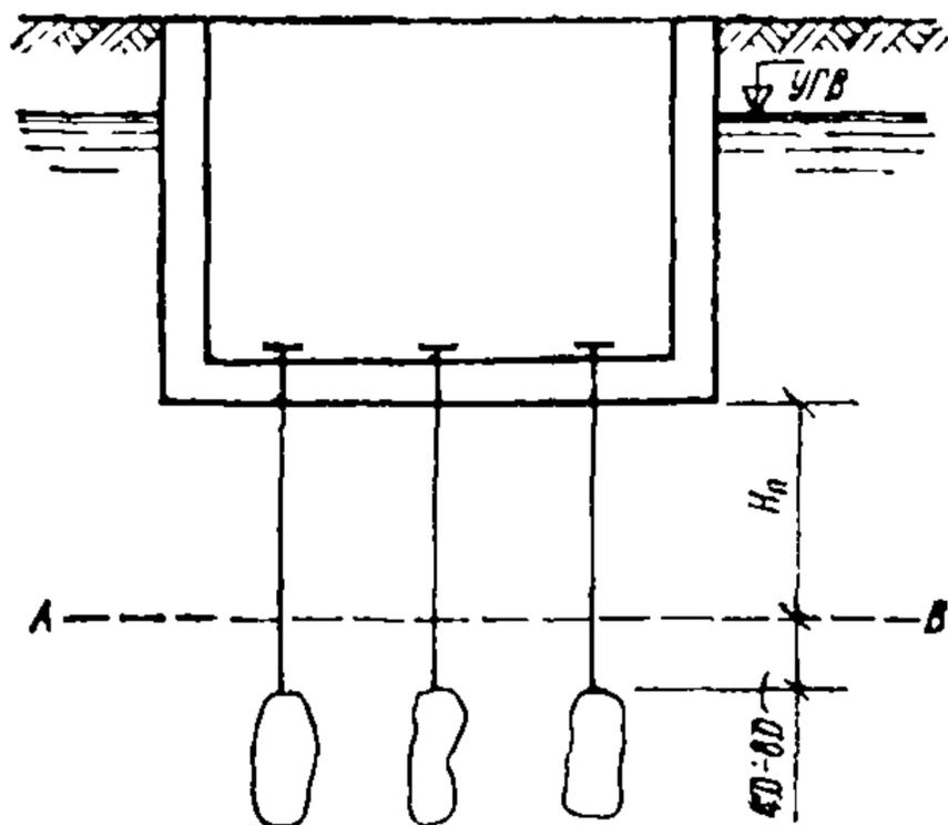
Рис. 15. График для определения длины заделки анкеров, удерживающих сооружение от всплытия
