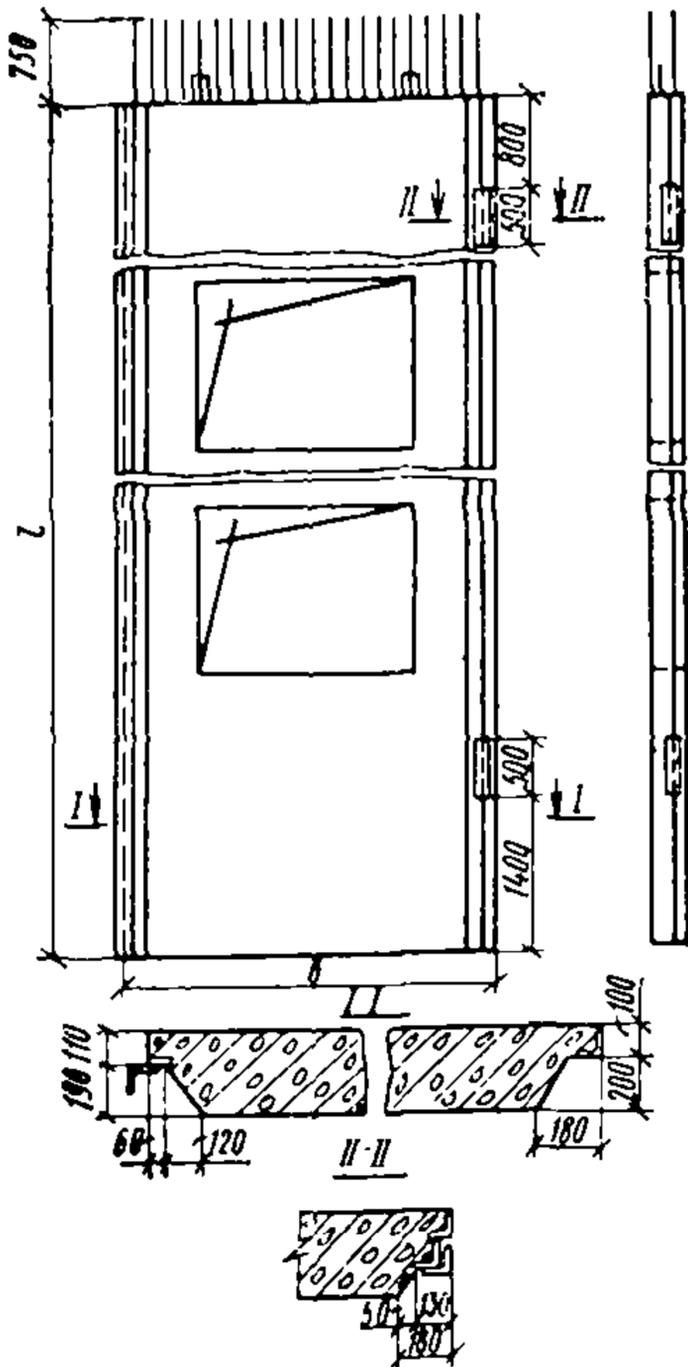
Рис. 30. Плоские стеновые панели без проемов
