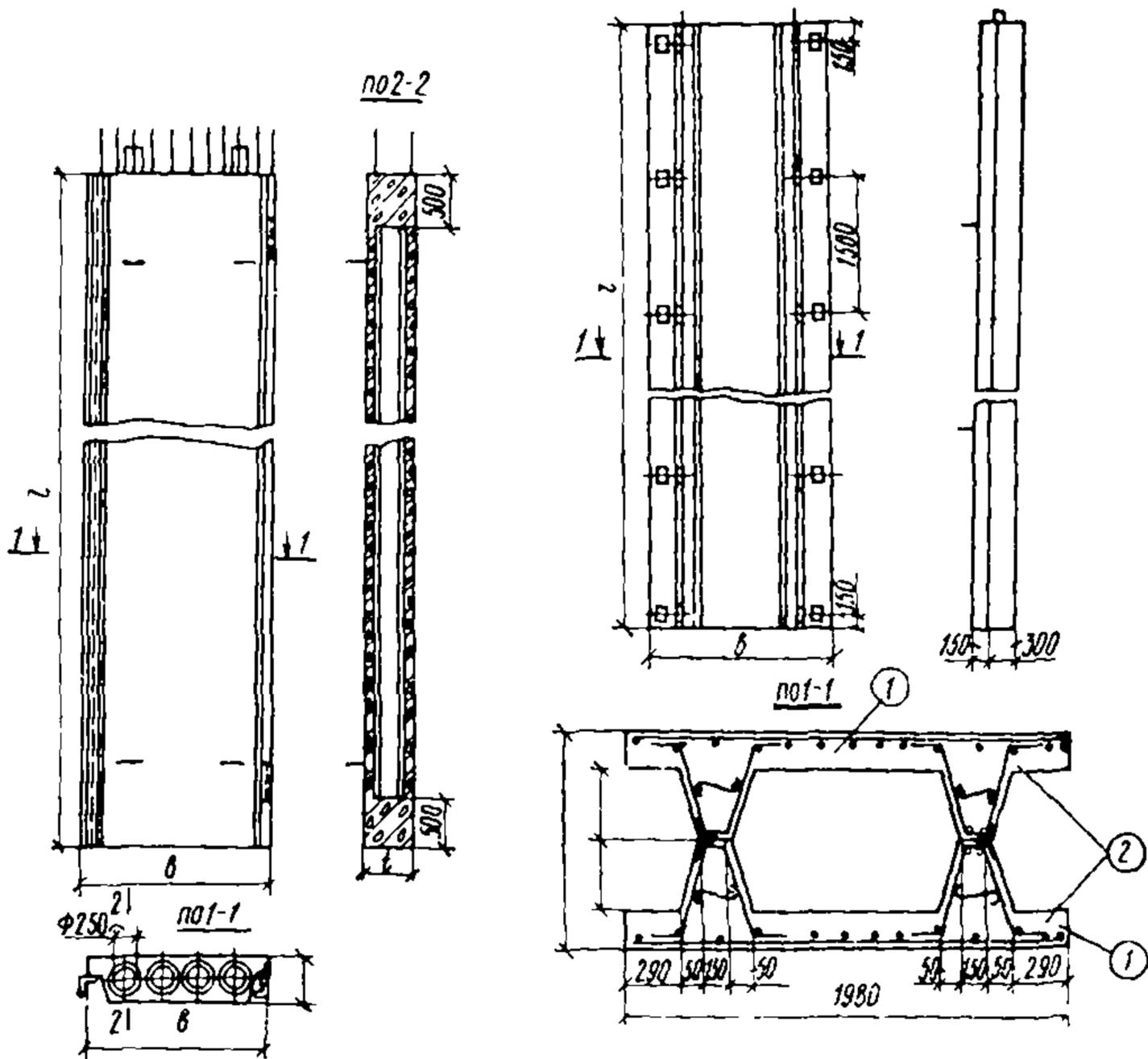
Рис. 31. Многопустотные стеновые панели
