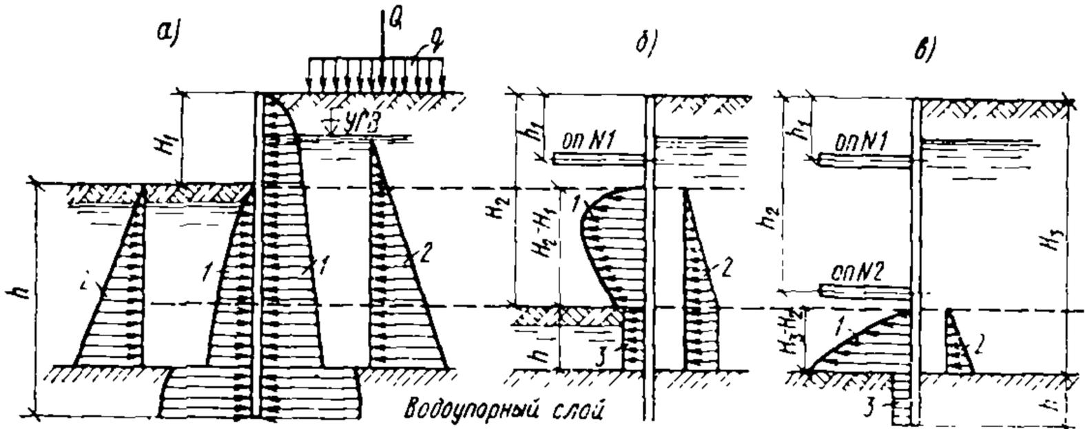
Рис. 5. Расчетные схемы стенки с опорами в строительный период
