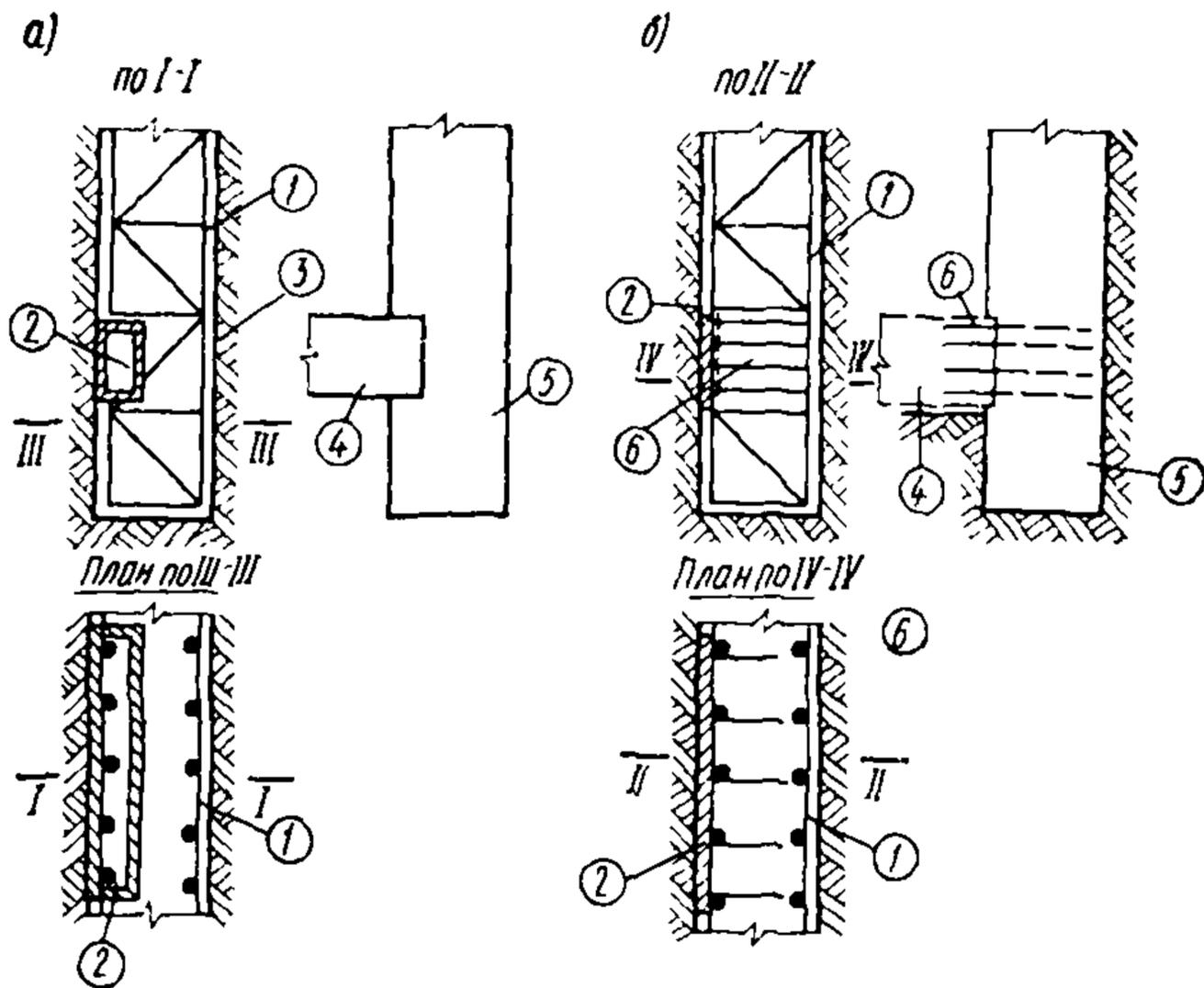
Рис. 26(4). Конструкции сопряжений дна со стенами
