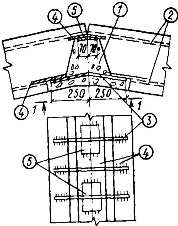
Рис. 33. Конструкция рабочего стыка
