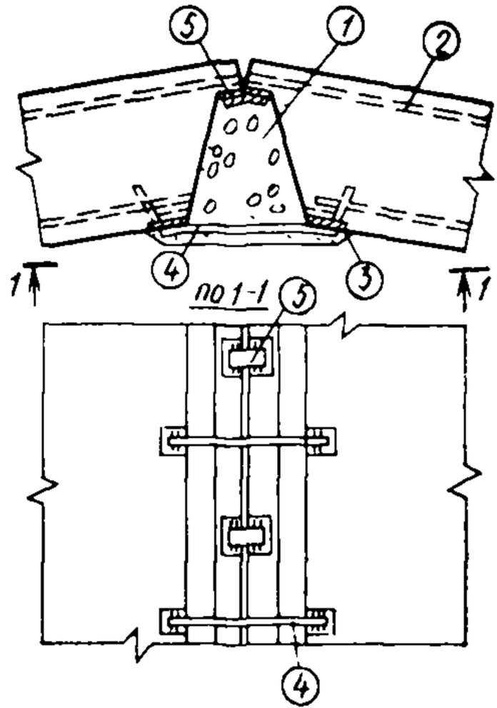
Рис. 34. Конструкция нерабочего стыка
