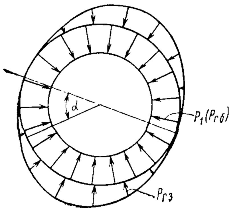
Рис. 3. Распределение в плане основного  $p_r(p_{r.б})$  и дополнительного  $p_{r.з}$  давления грунта на стены сооружений, круглых в плане
