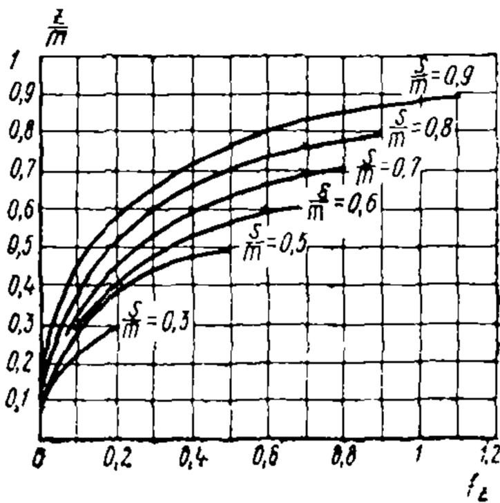
Рис. 18. График для определения дополнительного фильтрационного сопротивления  $f_2$
