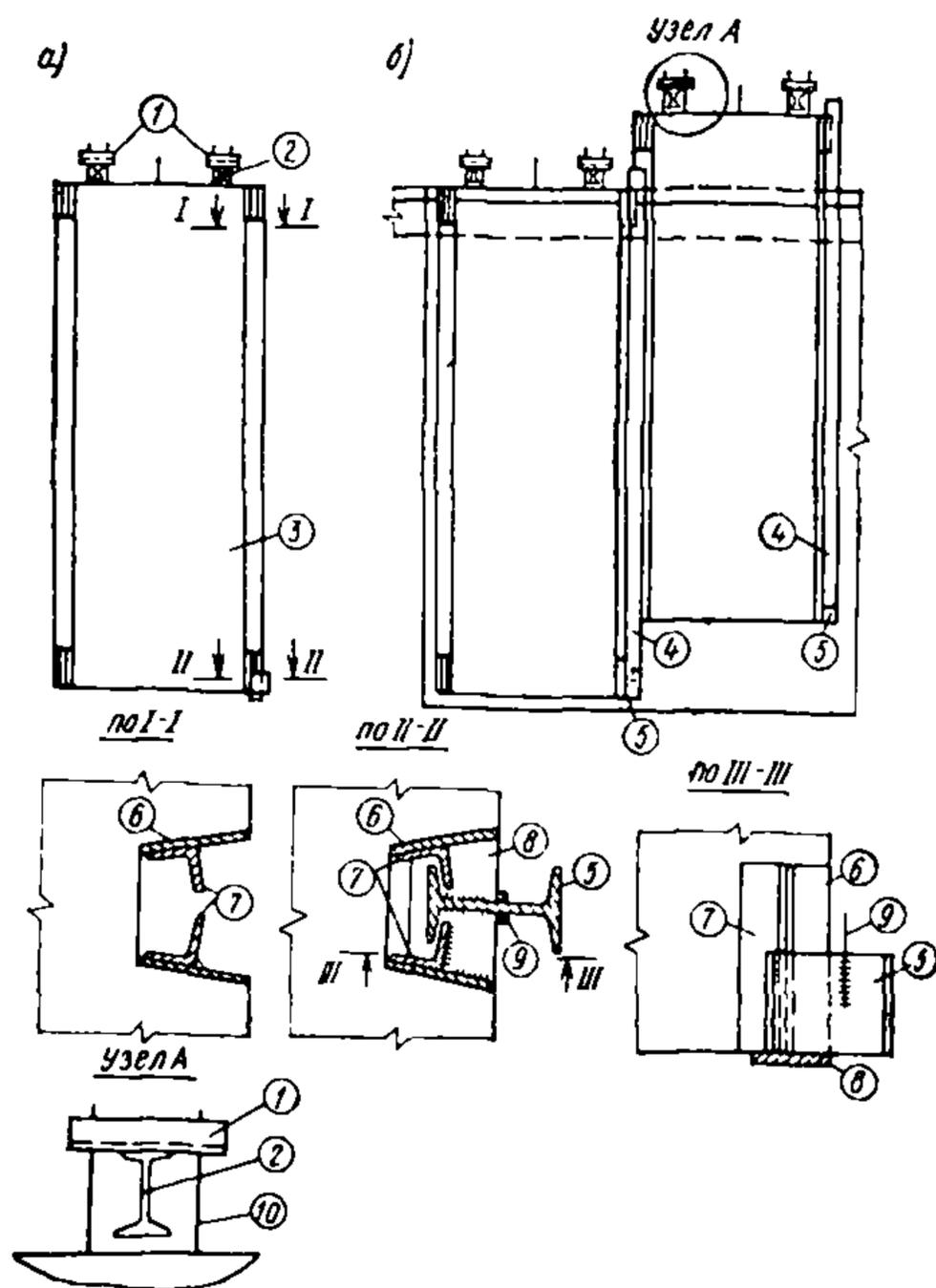
4.45. Для сопряжения ограждающих стен с дном, внутренними стенами и перегородками в стеновых панелях предусматривается устройство штраб или соответствующих закладных частей и выпусков арматуры.
