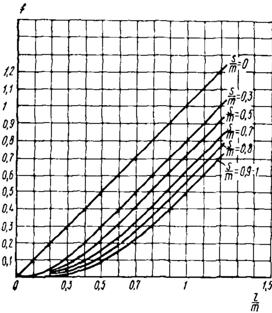
Рис. 17. График для определения фильтрационного сопротивления
