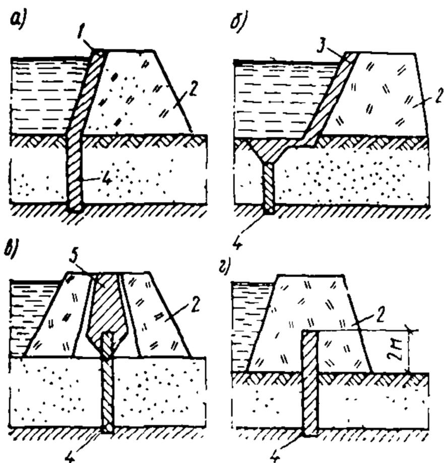
Рис. 40. Сопряжение завесы с земляным сооружением
