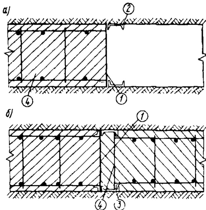
Рис. 25(3). Рабочий стык бетонирования монолитной стены
