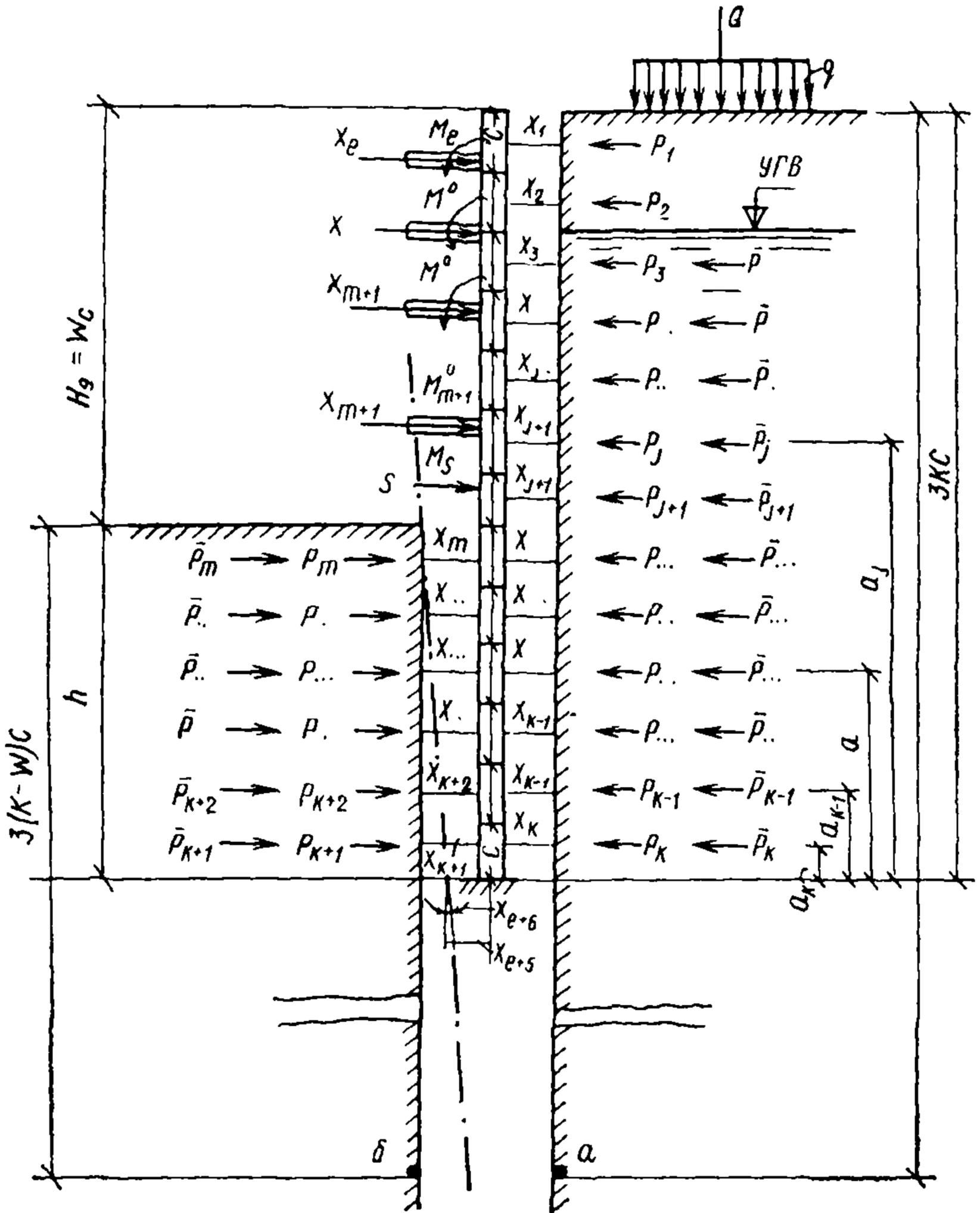
Рис. 6. Расчетная схема стены с опорами или анкерами
