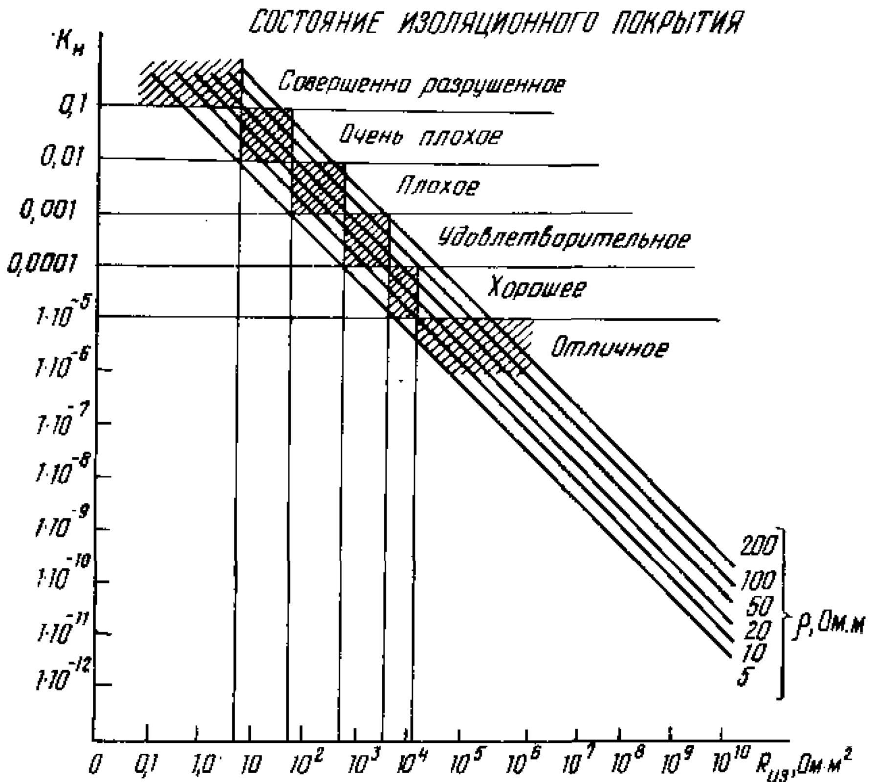
Зависимость коэффициента несплошности изолированной поверхности  $K_n$  от сопротивления изоляционного покрытия  $R_{из}$  при различном удельном сопротивлении грунта  $\rho$
