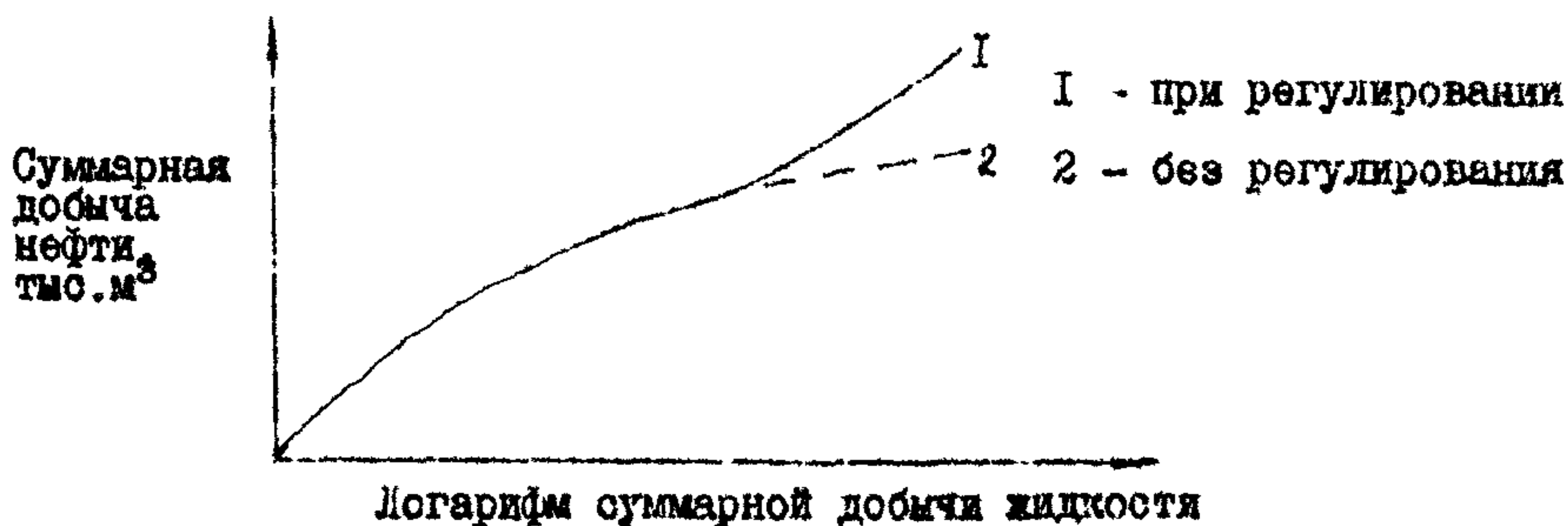
Рис. 8.1 - Характеристика вытеснения при регулировании процесса разработки
