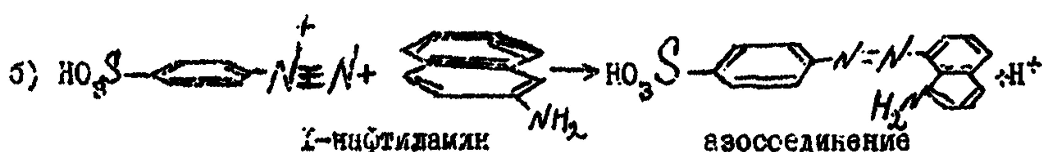
Паряду с сульфаниловой кислотой и I-нафтиламином применяется пара реагентов: амид сульфаниловой кислоты и  $\text{N}-(\text{I-нафтил})$  этилендиамин дигидрохлорид (НЭДА).
