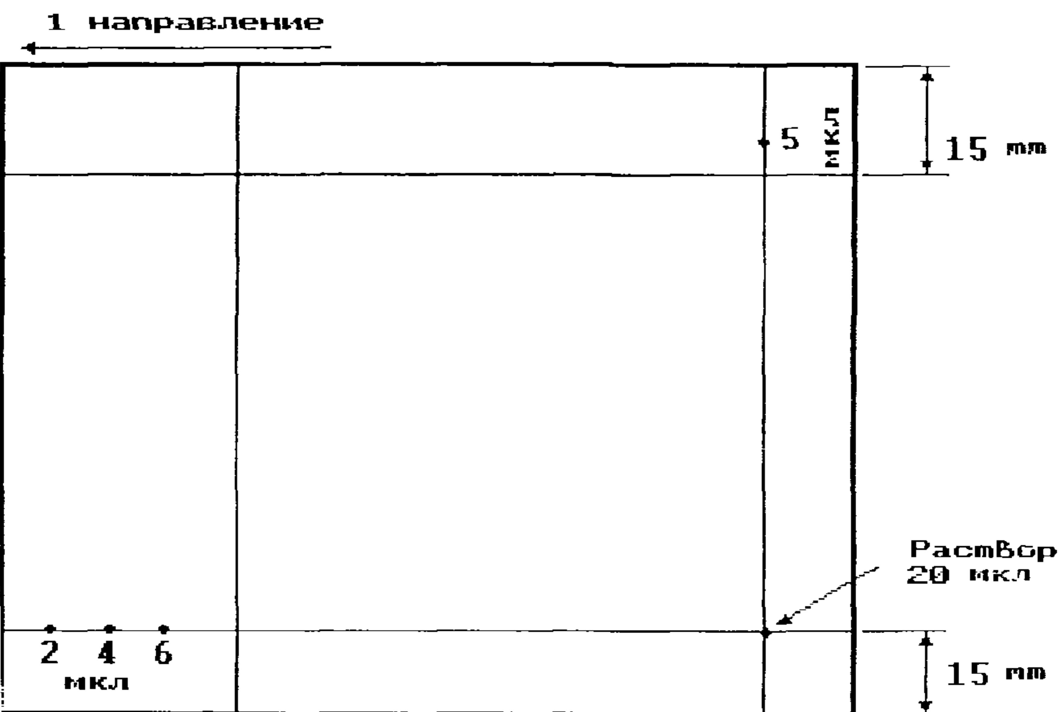
Рис. 2. Разметка пластинки для двумерной ТСХ зеараленона.
