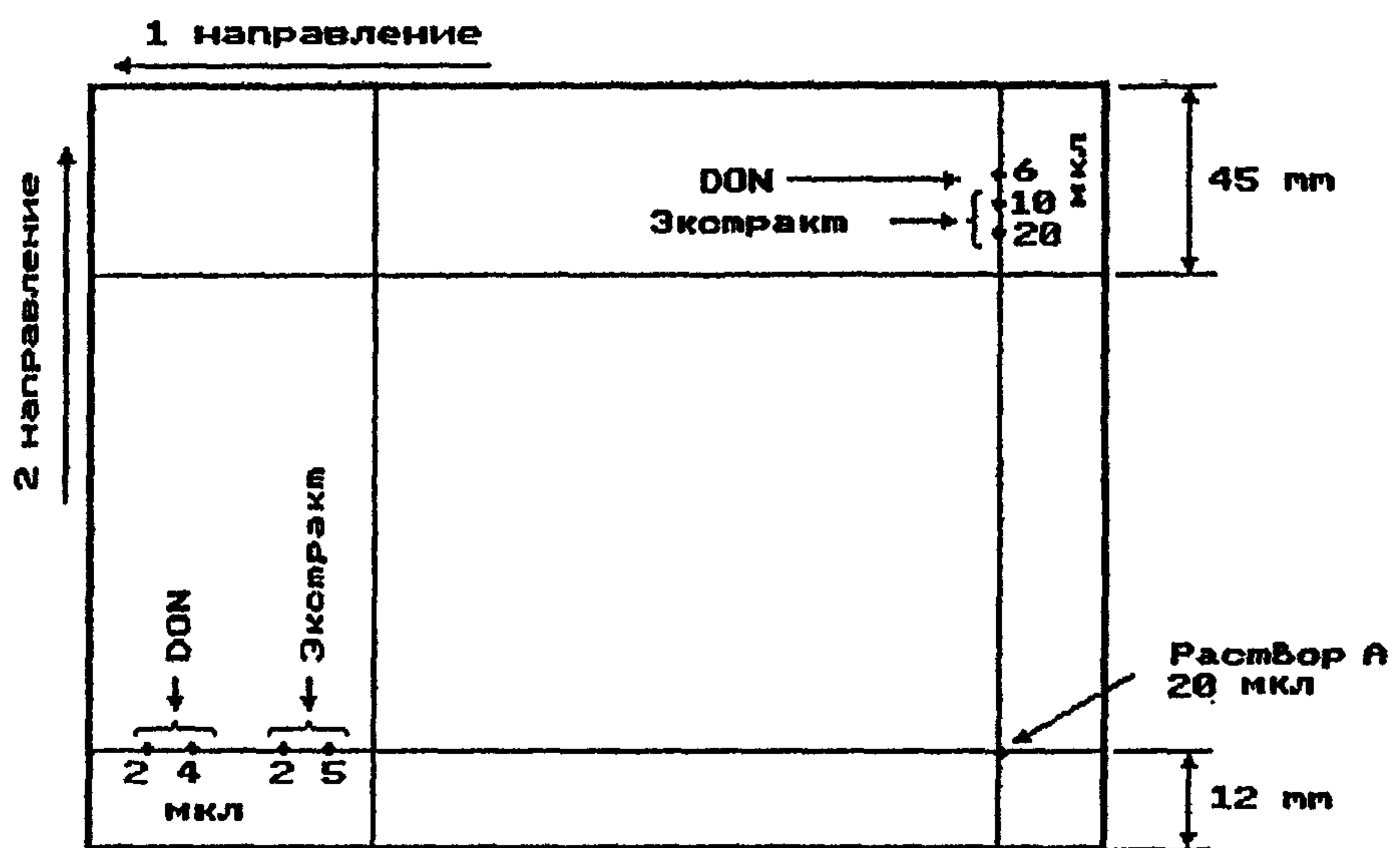
Рис. 1. Разметка пластинки для двумерной ТСХ дезоксиваленола .
