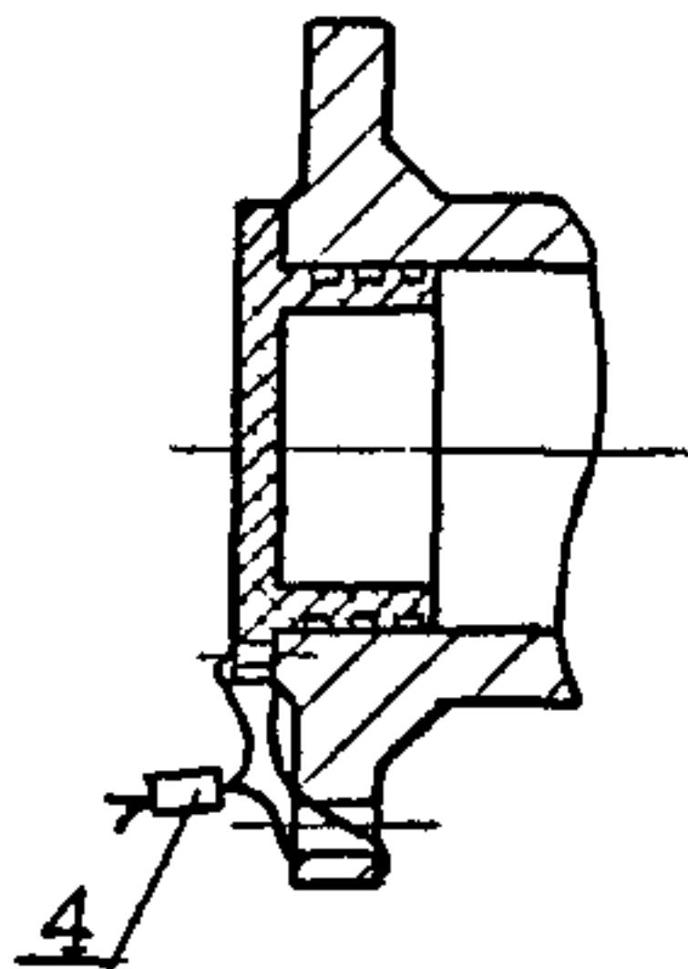
4. Закрытие патрубков пластмассовыми заглушками. Пломба ставится на проволоке, продетой через отверстия в заглушке и во фланце.
