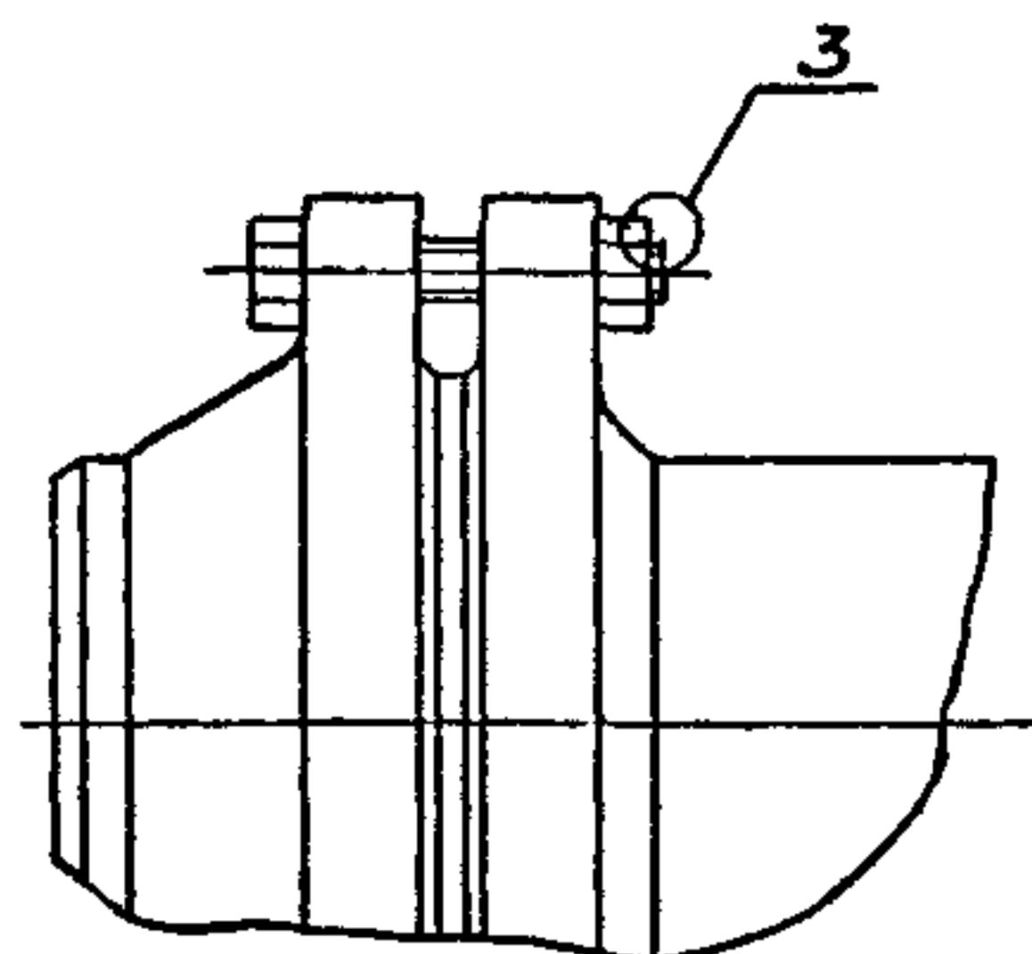
3. Закрытие патрубков ответными фланцами с установкой прокладки. Ответные фланцы стянуты с фланцем арматуры болтами. Пломба ставится краской на резьбовых концах не менее двух болтов.
