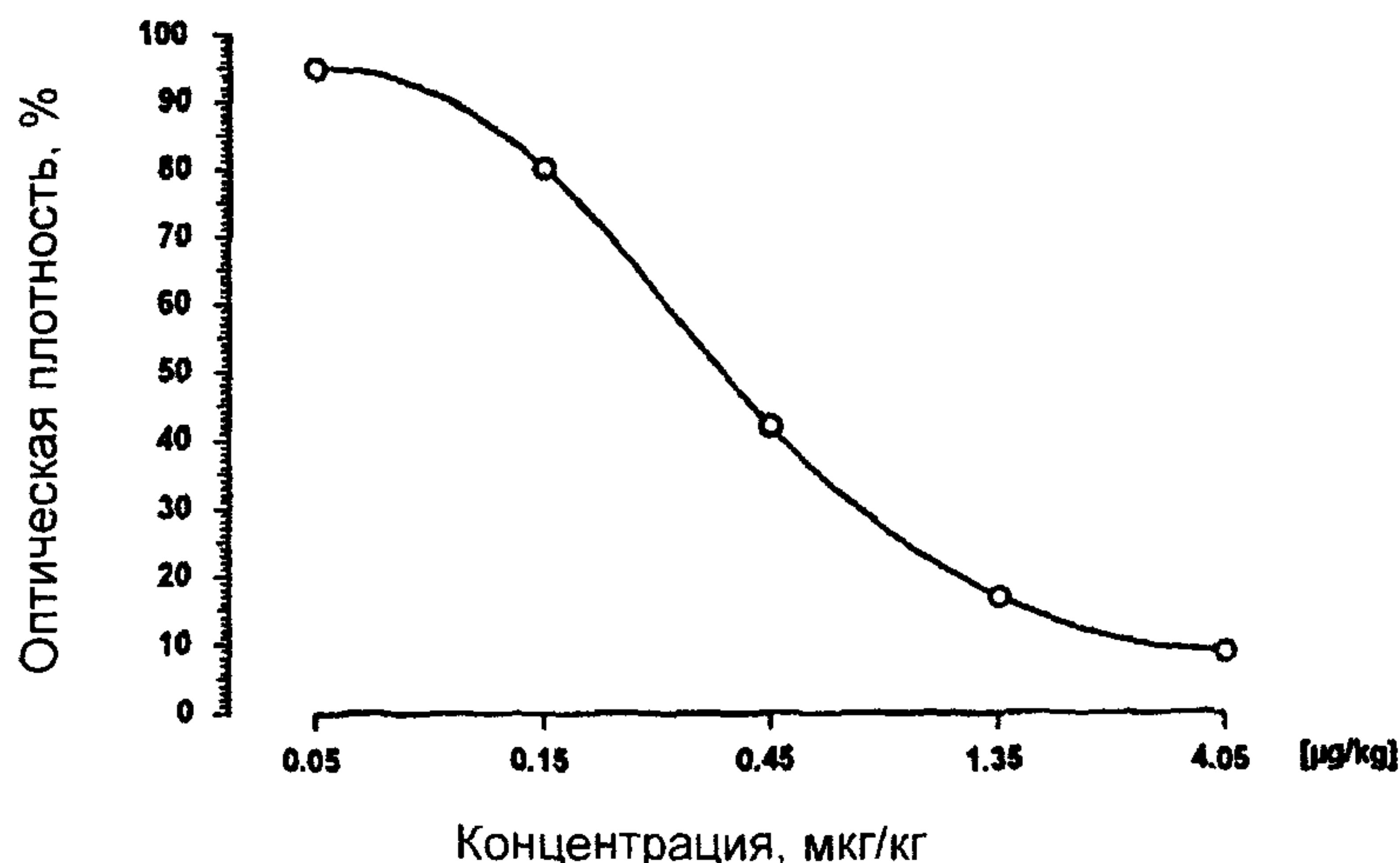
Рис. 2. Образец калибровочной кривой для набора реагентов «Ридаскрин Тетрациклин»
