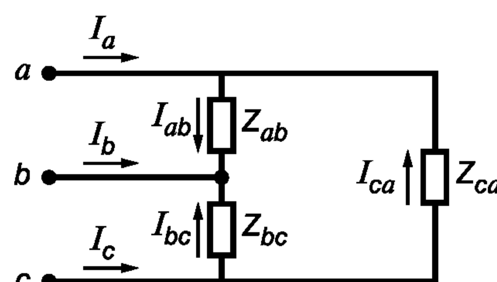
$a, b, c$  — фазы основной вторичной обмотки ТН;  $I_a, I_b, I_c$  — фазные токи;  $I_{ab}, I_{bc}, I_{ca}$  — межфазные токи;
