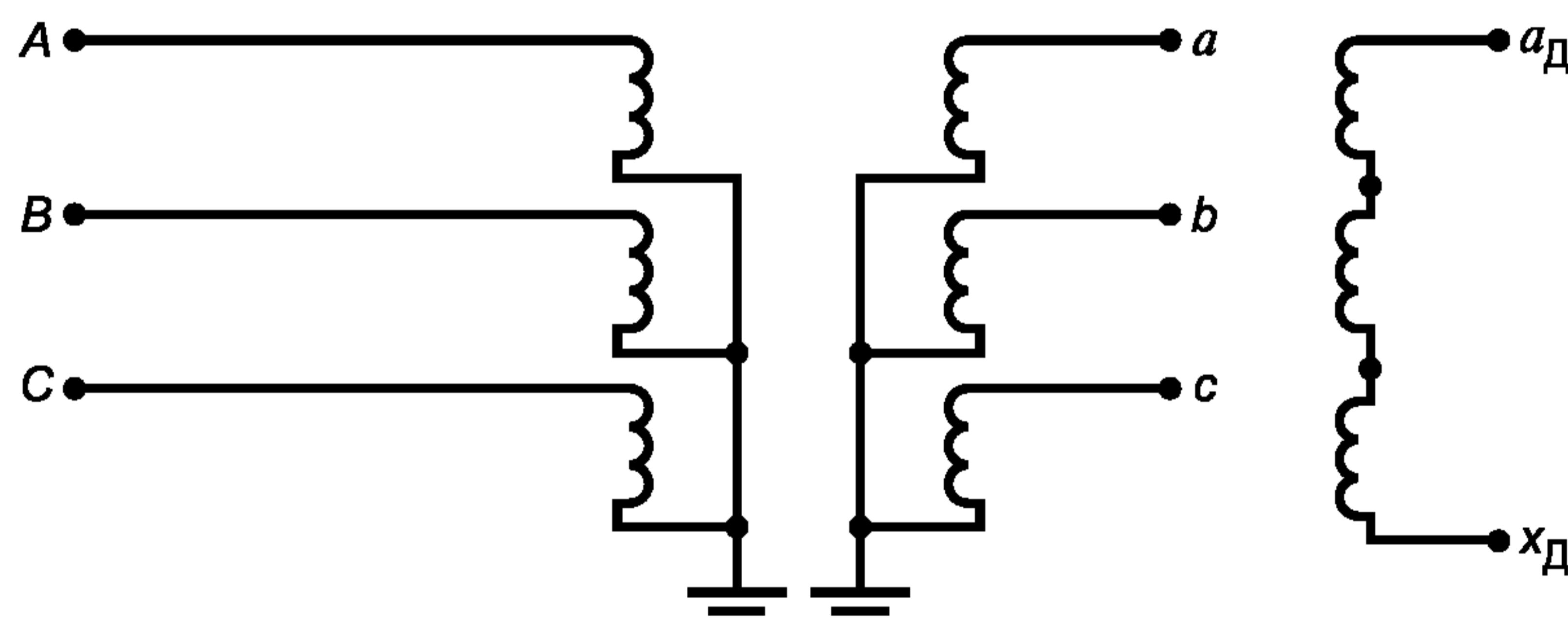
A, B, C — фазы первичной обмотки ТН; a, b, c — фазы основной вторичной обмотки ТН; aД, xД — фазы дополнительной вторичной обмотки ТН
