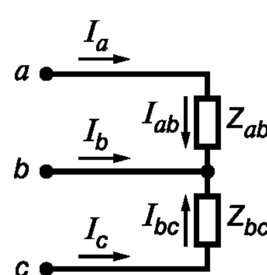
$a, b, c$  — фазы основной вторичной обмотки ТН;  $I_a, I_b, I_c$  — фазные токи;  $I_{ab}, I_{bc}, I_{ca}$  — межфазные токи;
