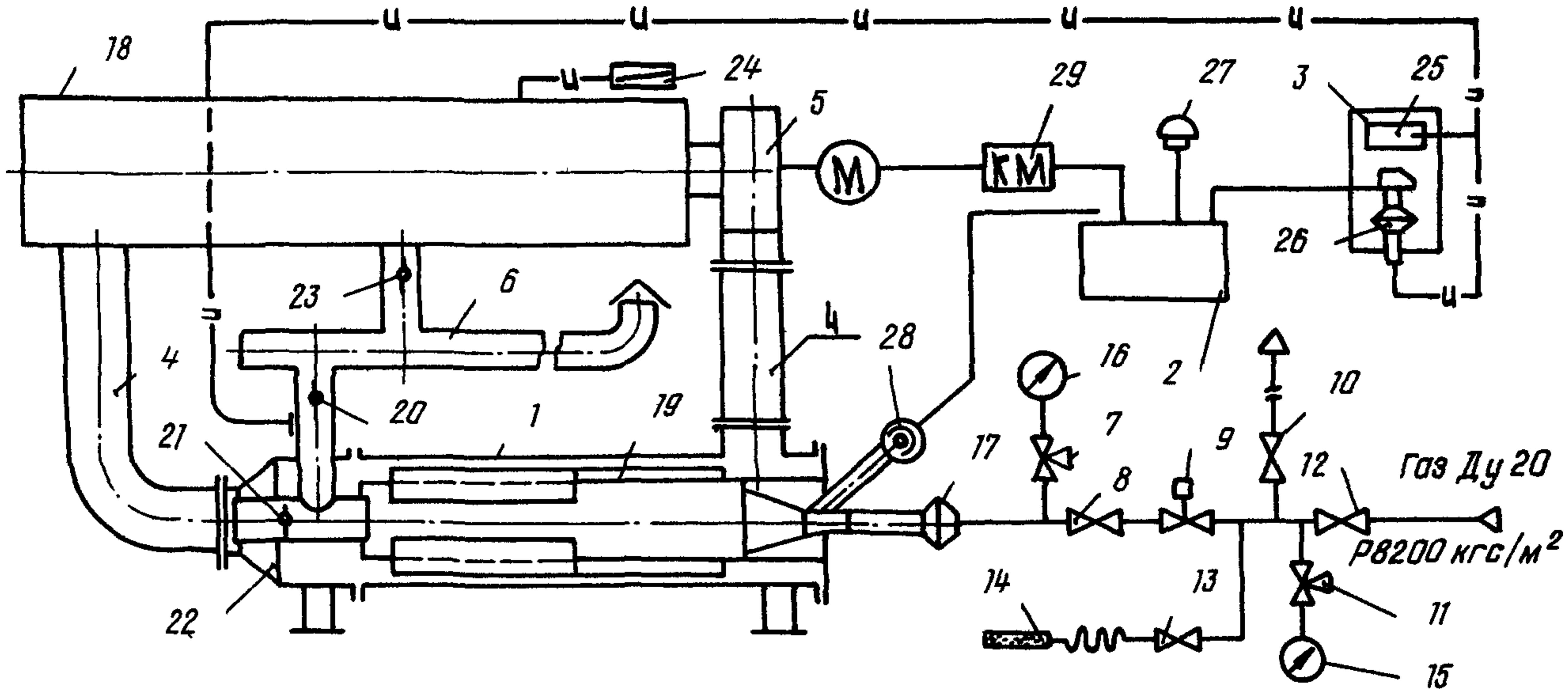
Рис.4. Принципиальная схема установки тепловлажностной обработки:
