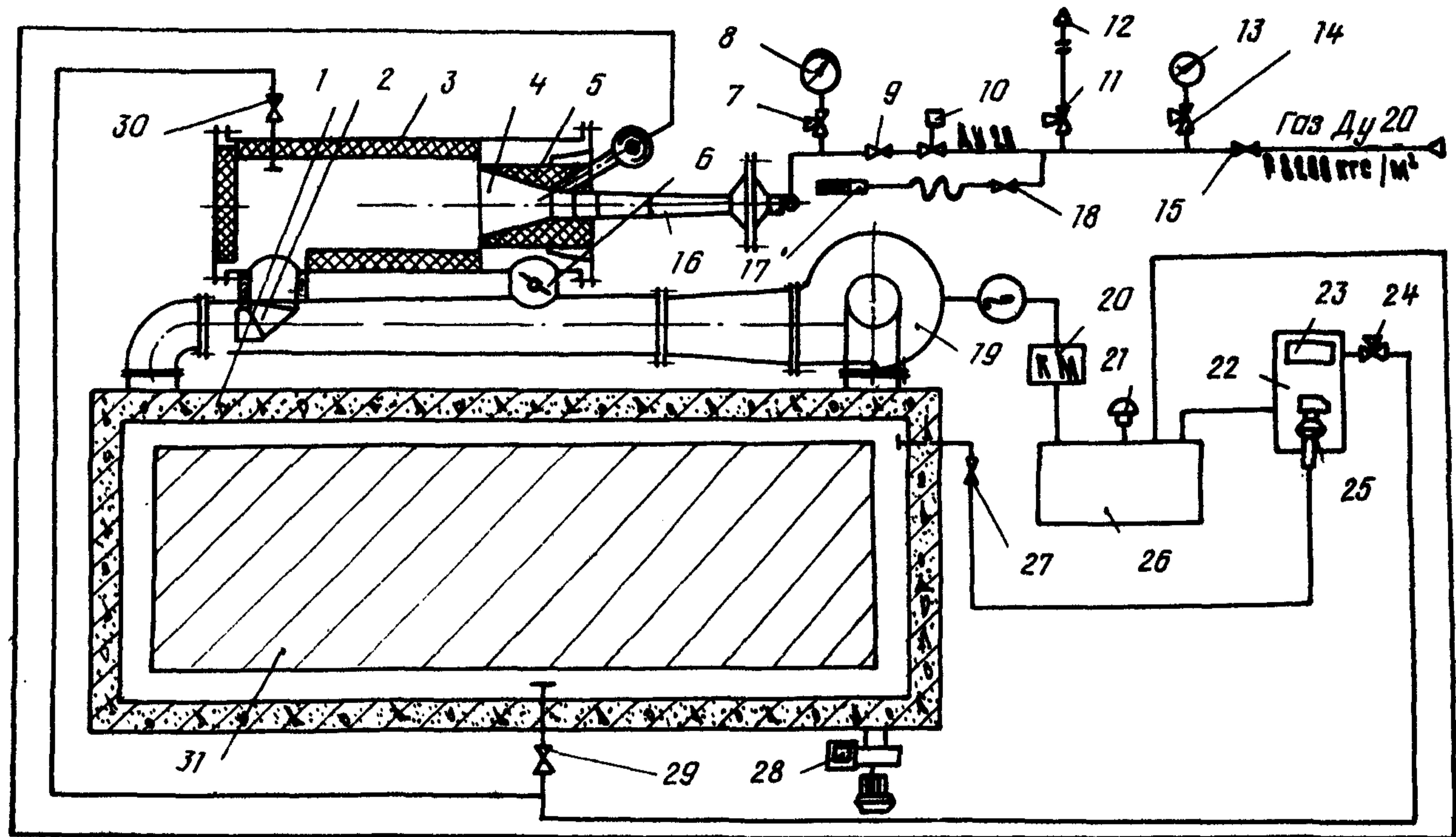
Рис.3. Принципиальная схема установки тепловой обработки железобетона:
