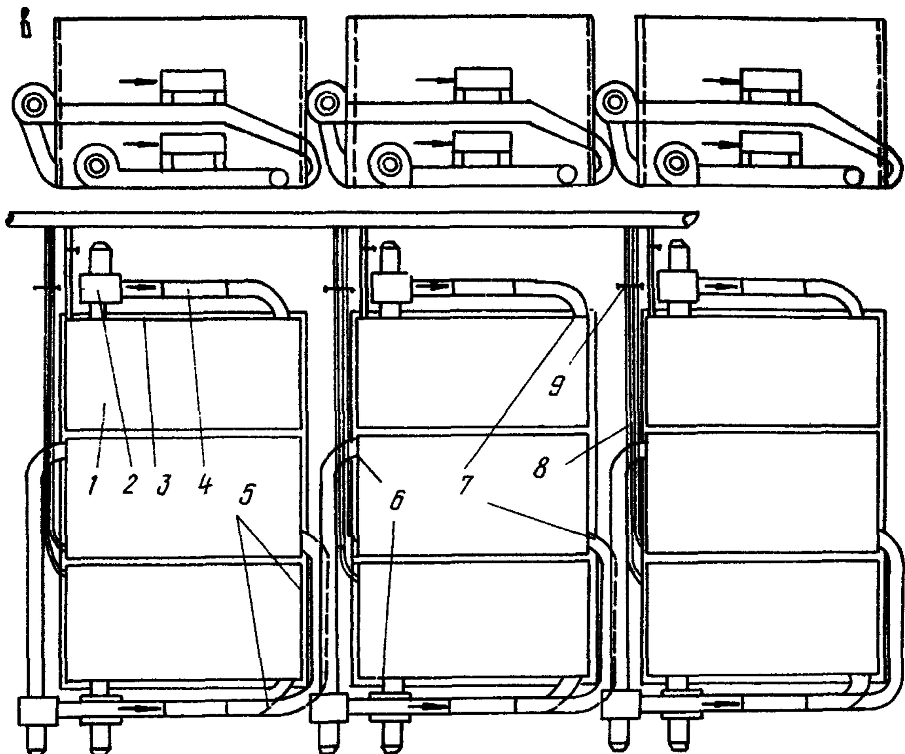
Рис.5. Схема размещения теплогенераторов при различных вариантах блокировки ямных камер:
