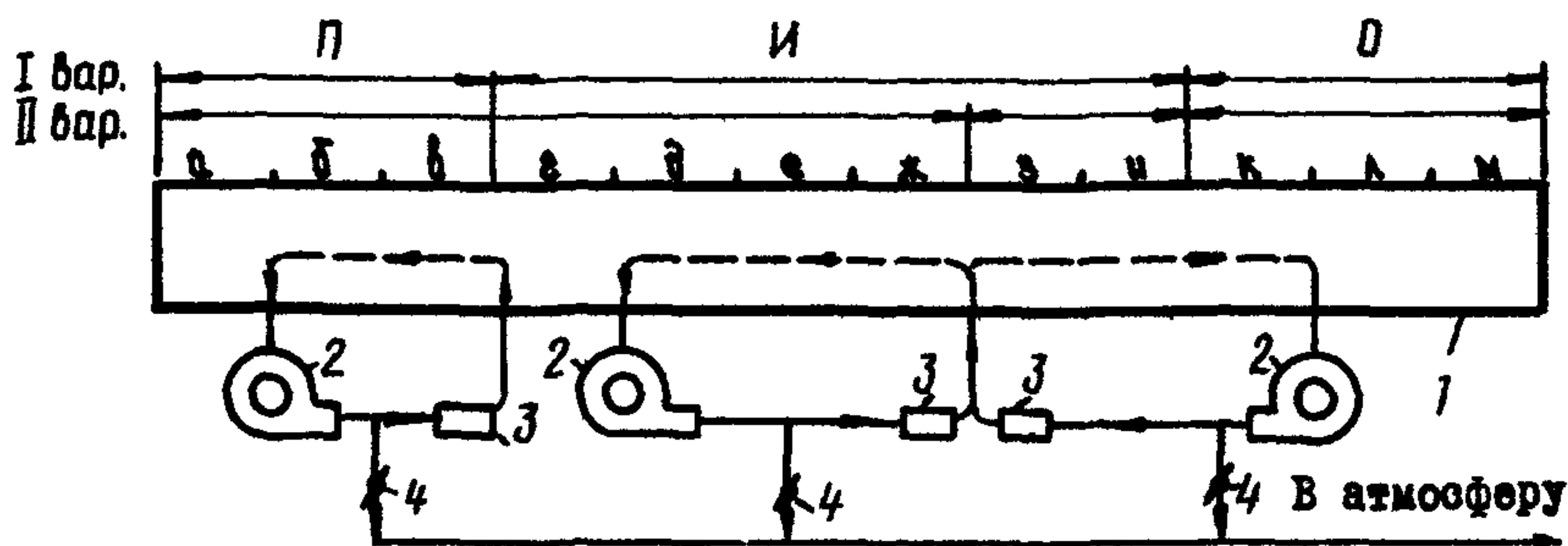
Рис.2. Схема подключения теплогенератора к щелевой или тоннельной камере:
