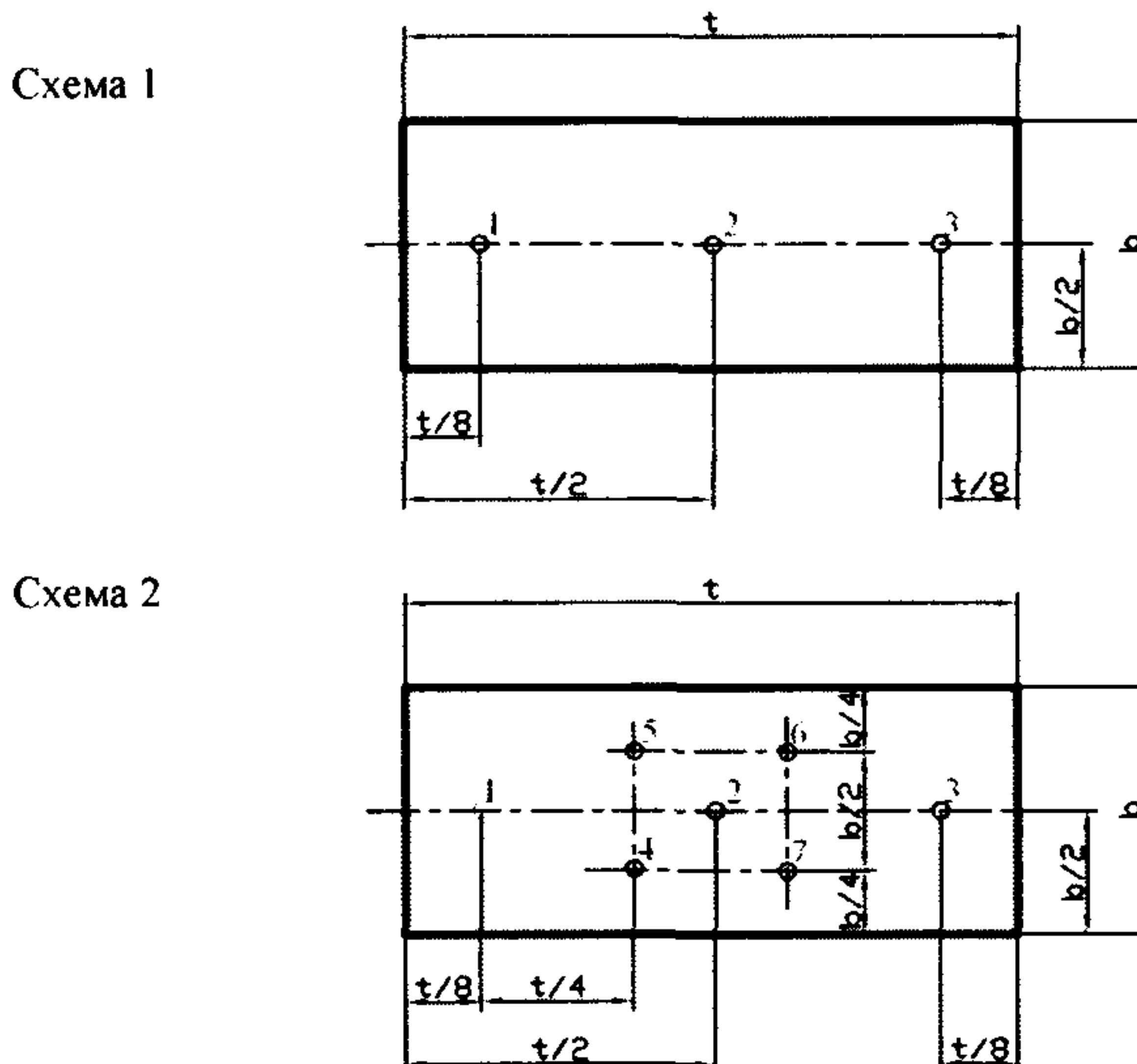
Рис. И.1. Схема измерения остаточных толщин листа
