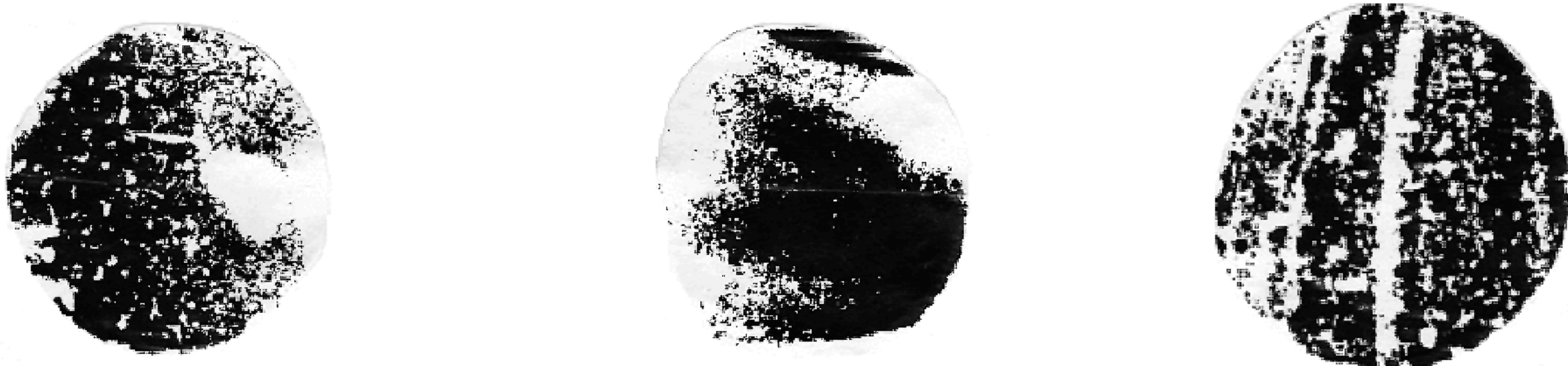
a – Отпечаток поверхности образца с крупнозернистой структурой
