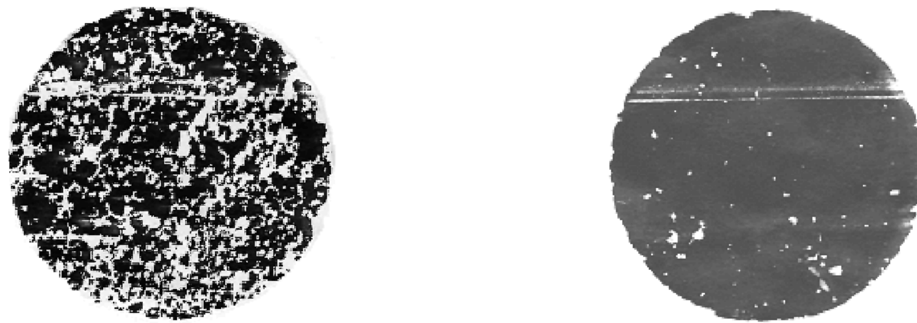
a – Отпечаток поверхности образца с крупнозернистой структурой
