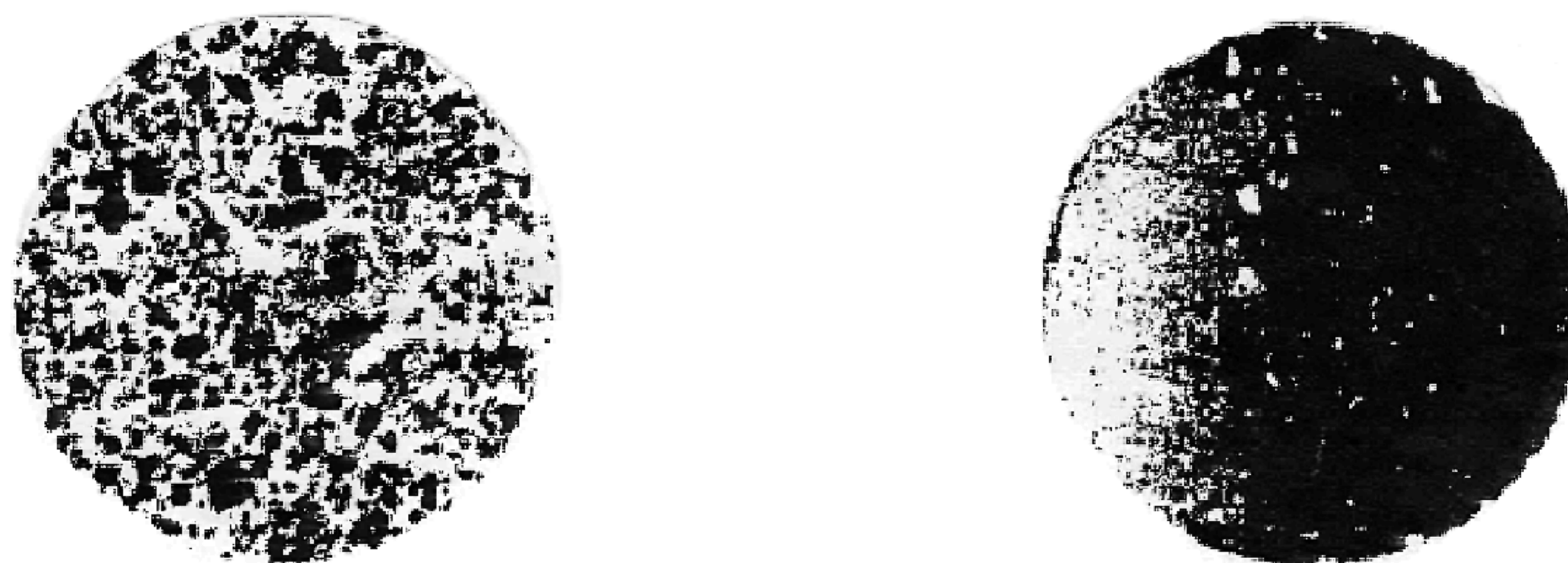
a – Отпечаток поверхности образца с крупнозернистой структурой
