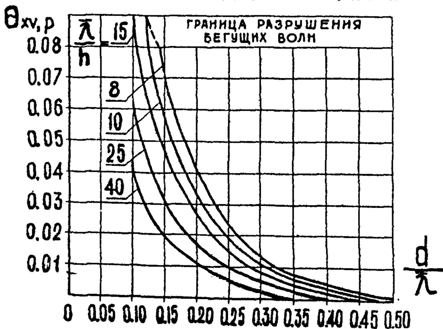
График значений фазы волны, соответствующей максимальной волновой нагрузке на нефтепровод, расположенный на дне моря
