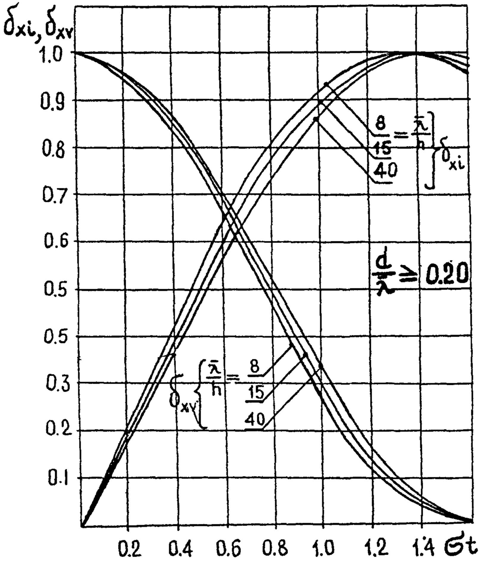
График значений фазы волны, соответствующей максимальной нагрузке на нефтегазопровод, расположенный на дне моря от соотношения
