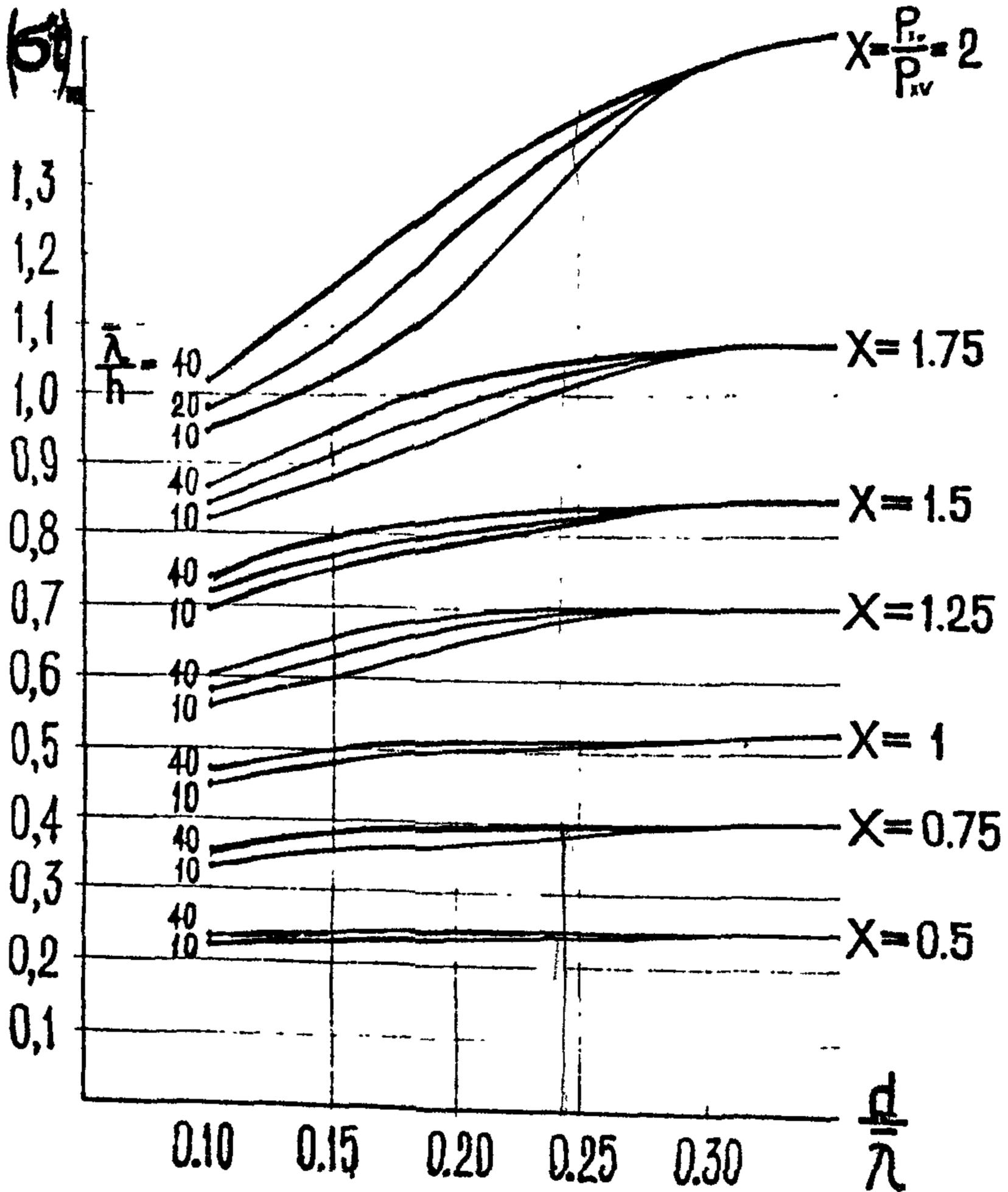
Схема к определению волновых нагрузок на морской нефтегазопровод, расположенный на дне моря в прибойной зоне
