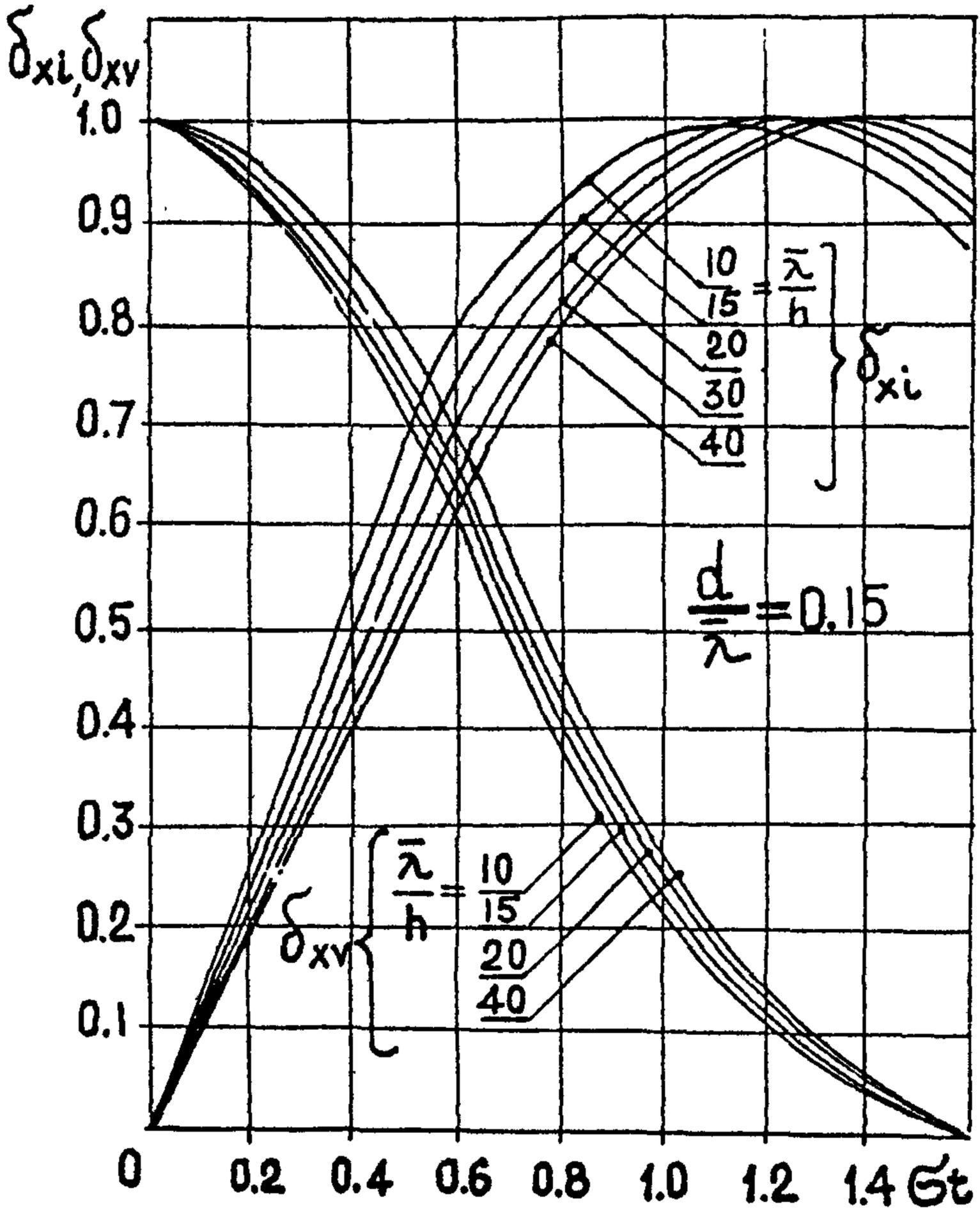
График значений фазы волны, соответствующей максимальной волновой нагрузке на нефтепровод, расположенный на дне моря
