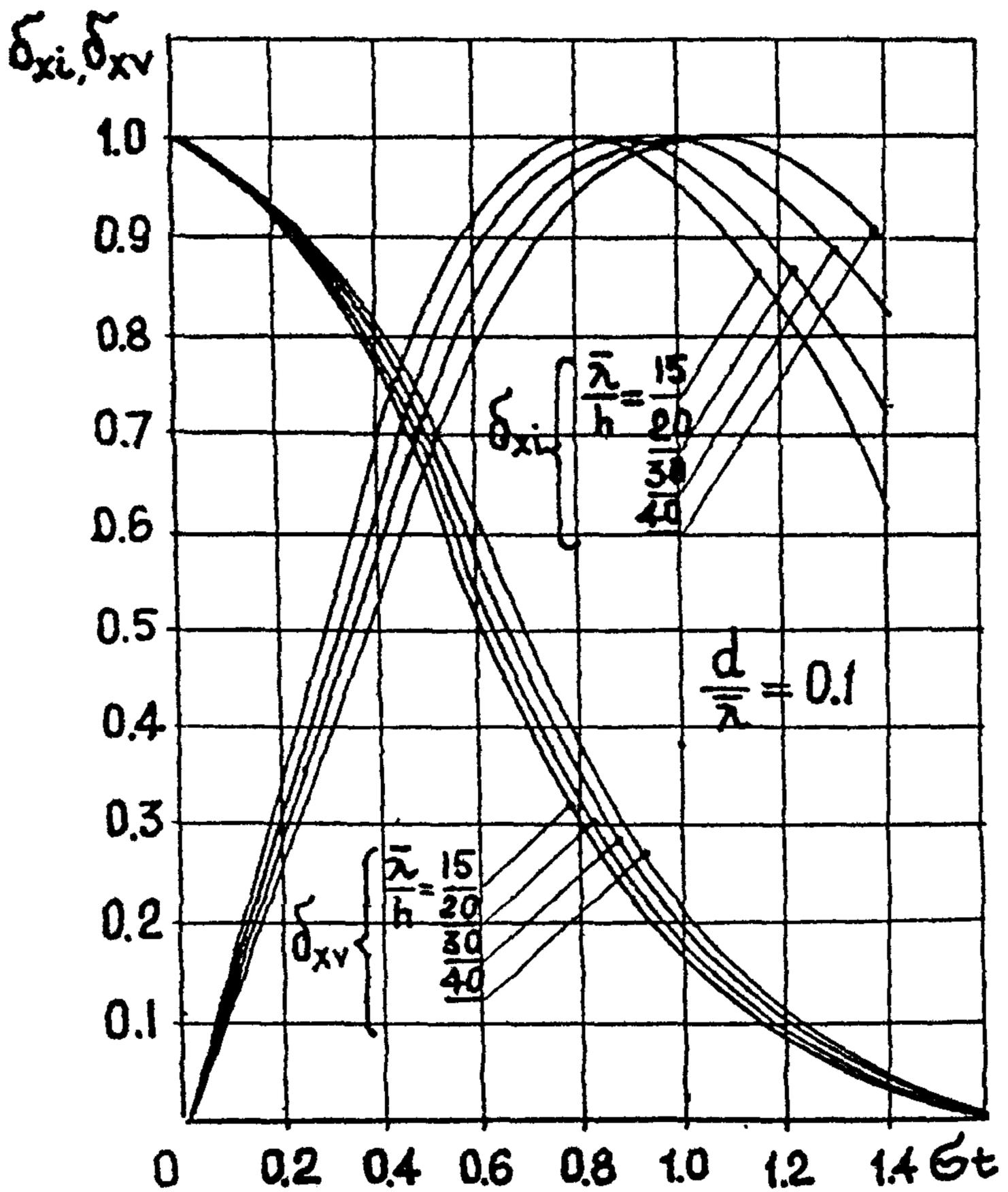
График значений фазы волны, соответствующей максимальной волновой нагрузки на нефтепровод, расположенный на дне моря
