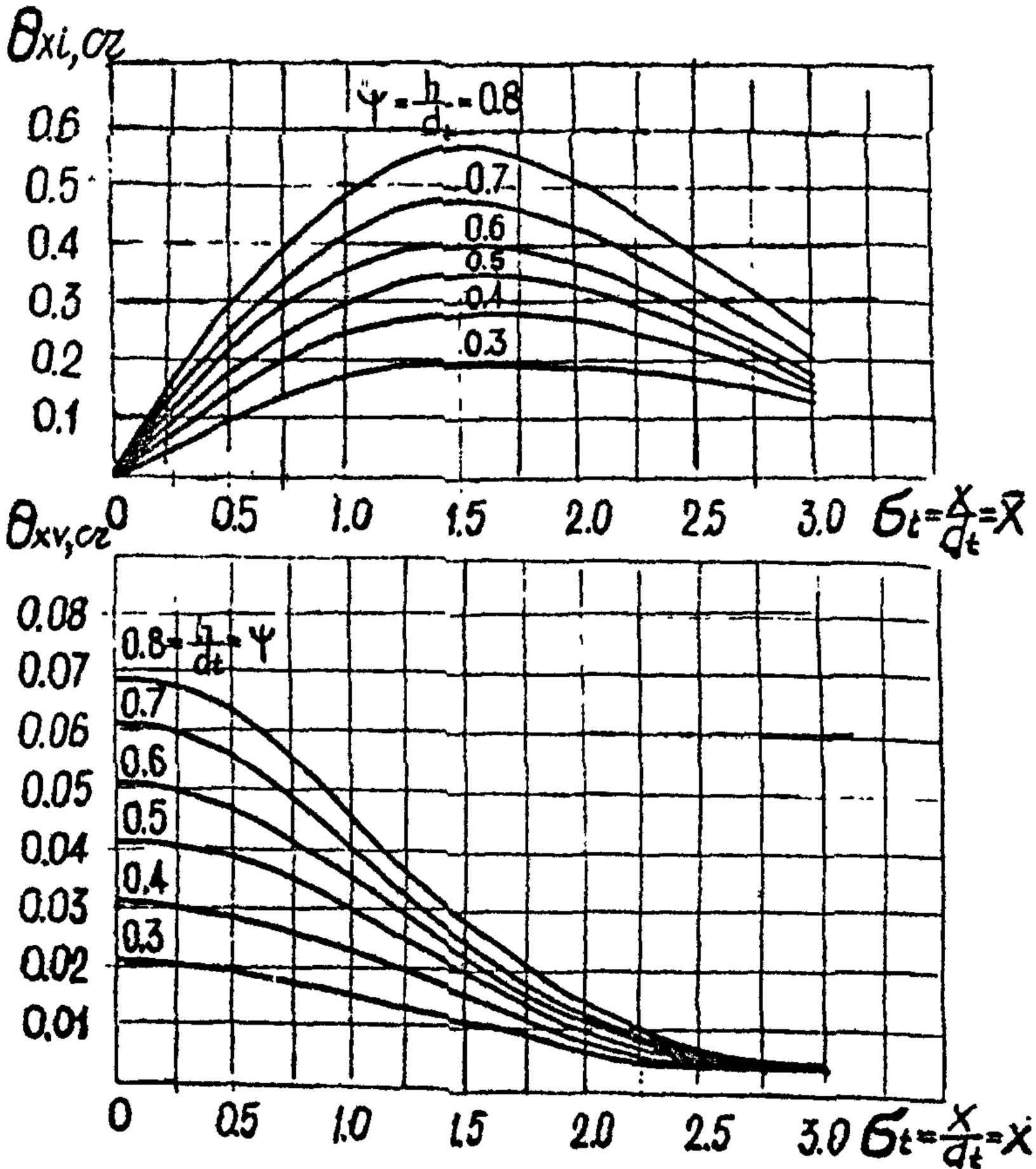
Графики значений фазы волны соответствующей максимальной волновой нагрузке на нефтегазопровод, расположенный на дне моря в прибойной зоне
