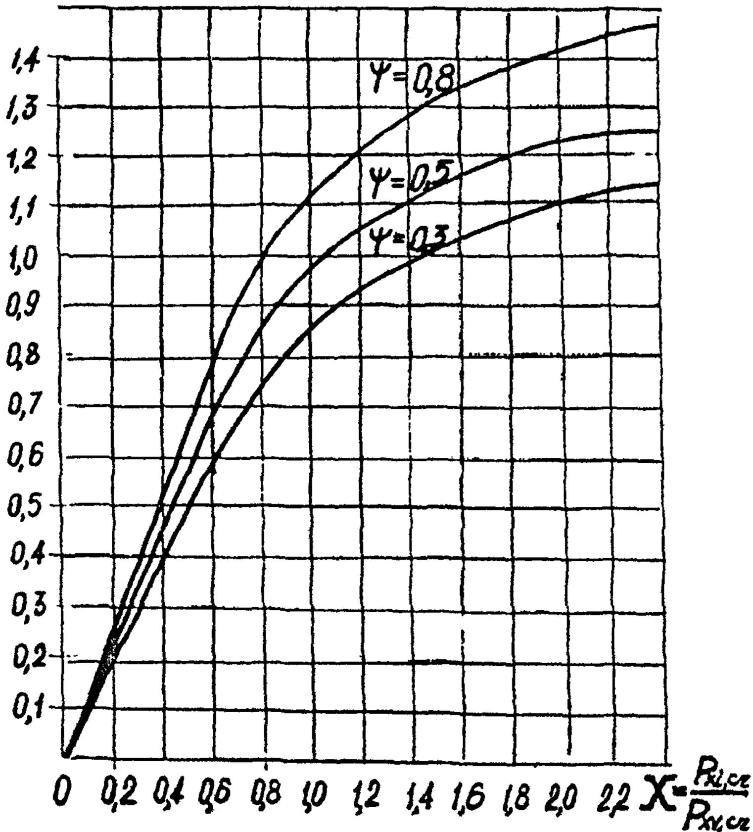
График значений коэффициентов сочетания инерционного и скоростного компонентов горизонтальной нагрузки от волн на нефтегазопровод, расположенный на дне в прибойной зоне
