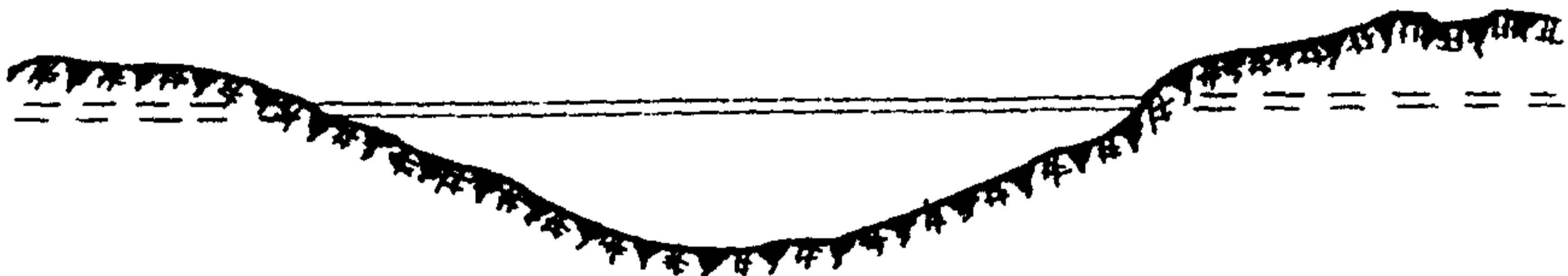
Рис. I2. Однопролетный прямолинейный бескомпенсаторный переход
