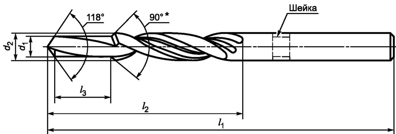
\* Допускается изготовление сверла с углом 120°.
