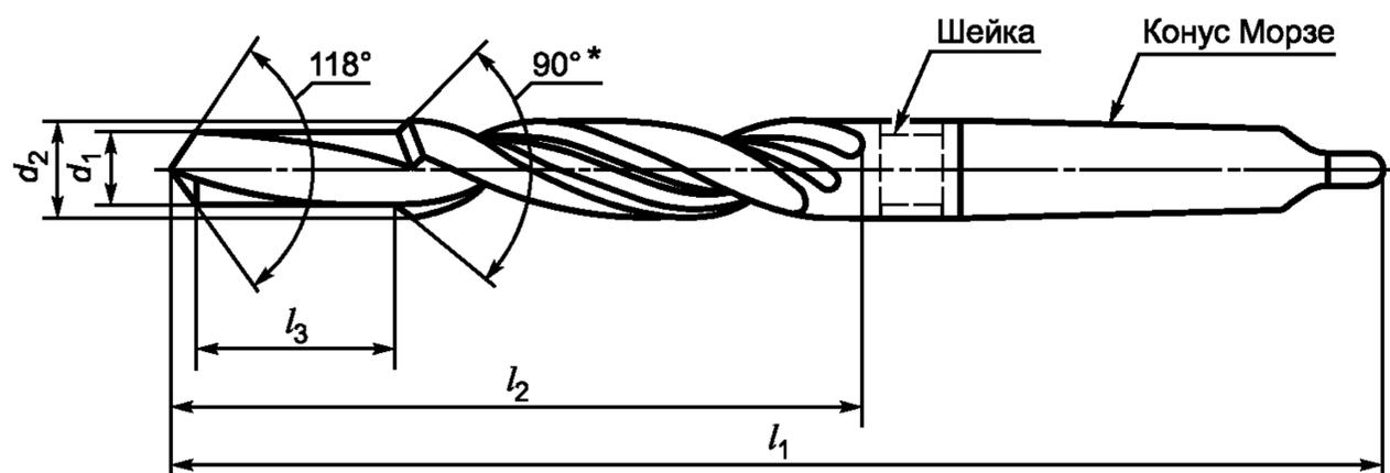
\* Допускается изготовление сверла с углом 120°.
