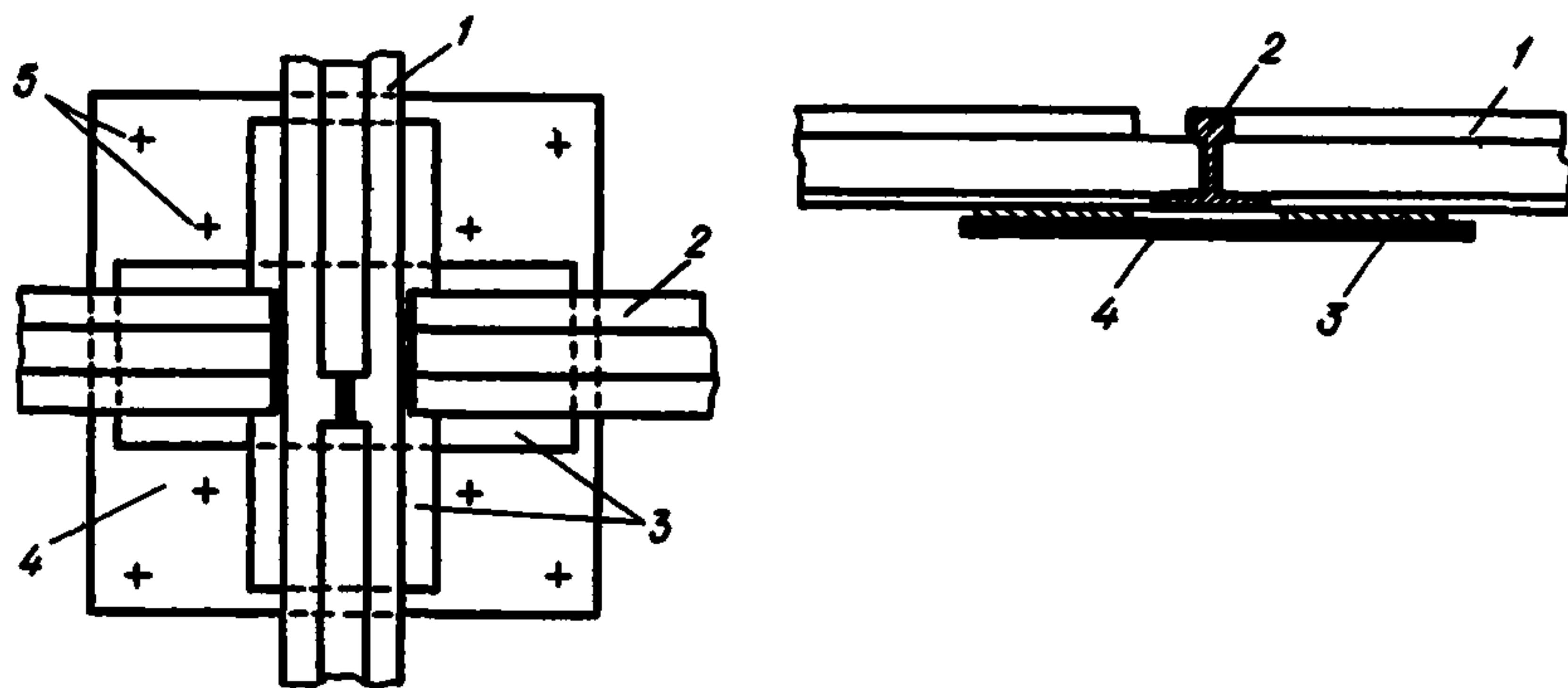
Рис. 7. Пересечение подкрановых и откатных путей
