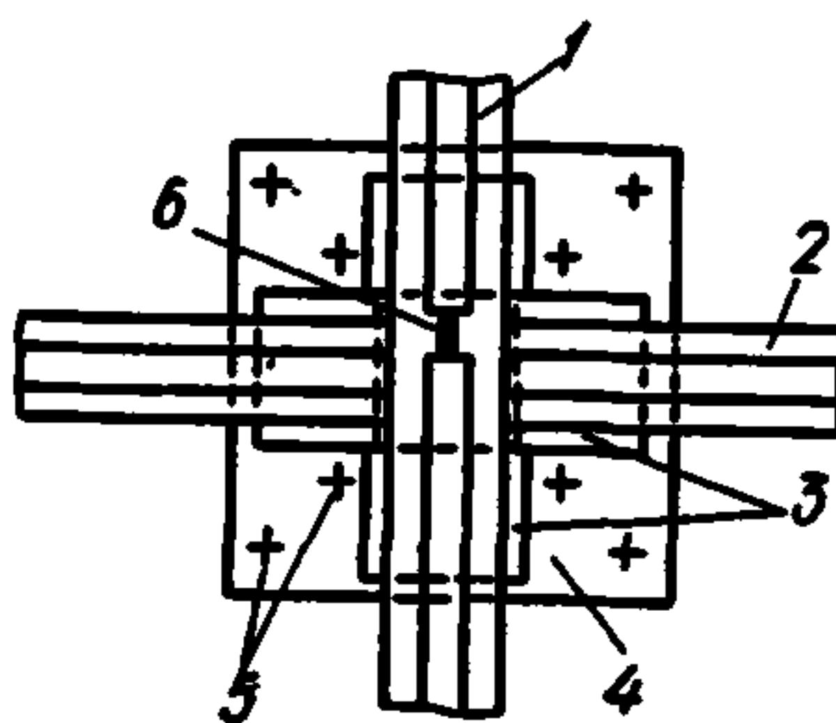
Рис. 8. Пересечение стапельных и откатных путей
