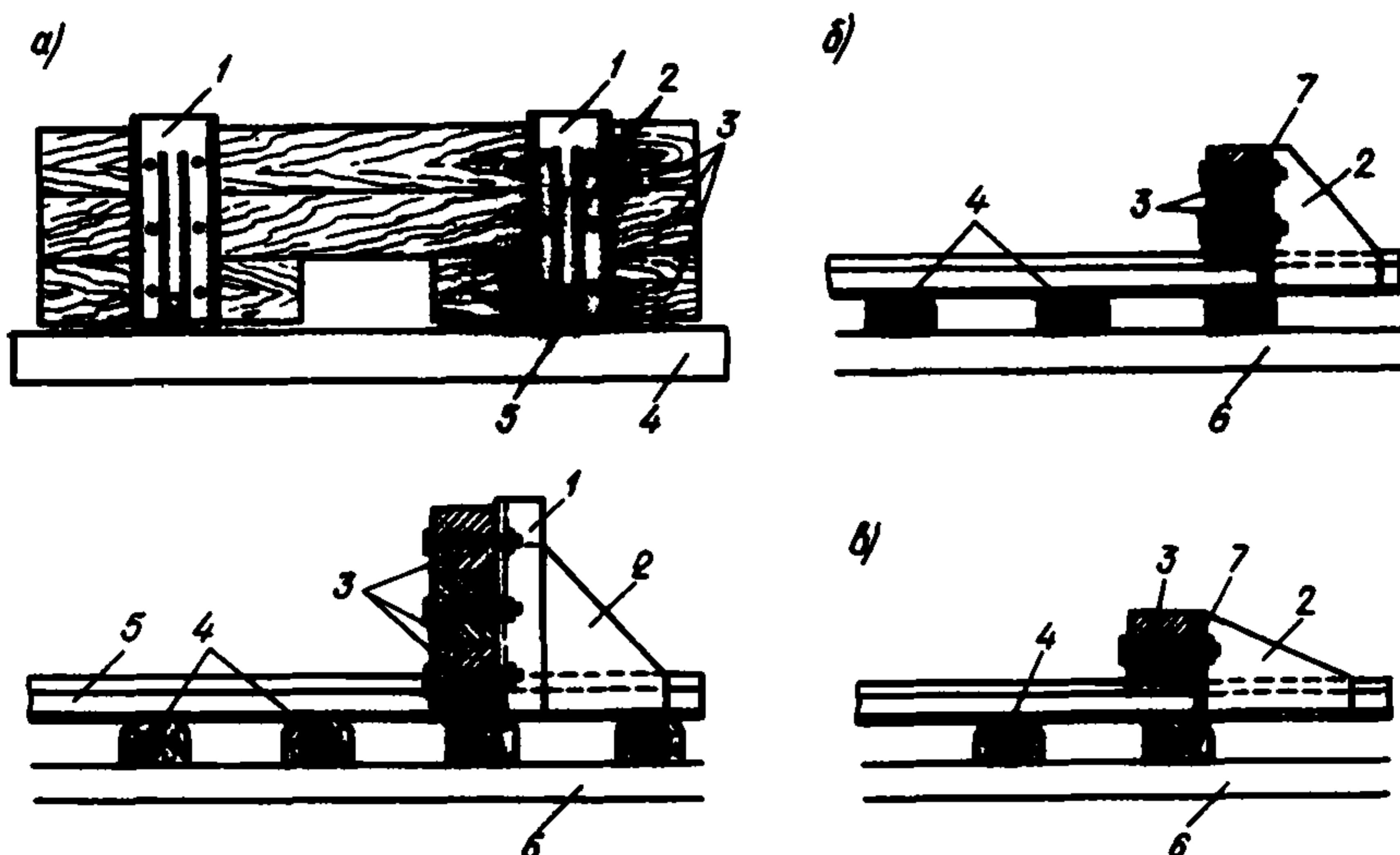
Рис. 3. Поперечные упоры
