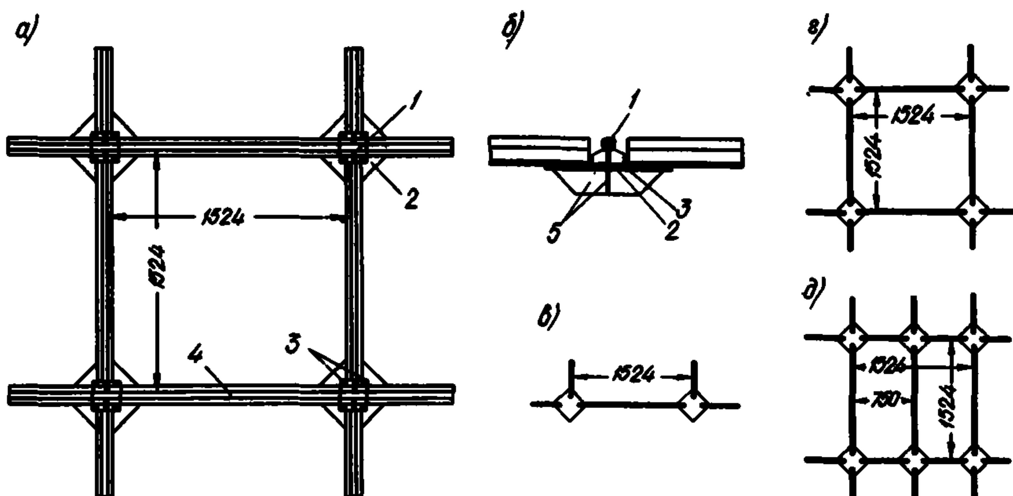
Рис. 5. Пересечка с вкладышем
