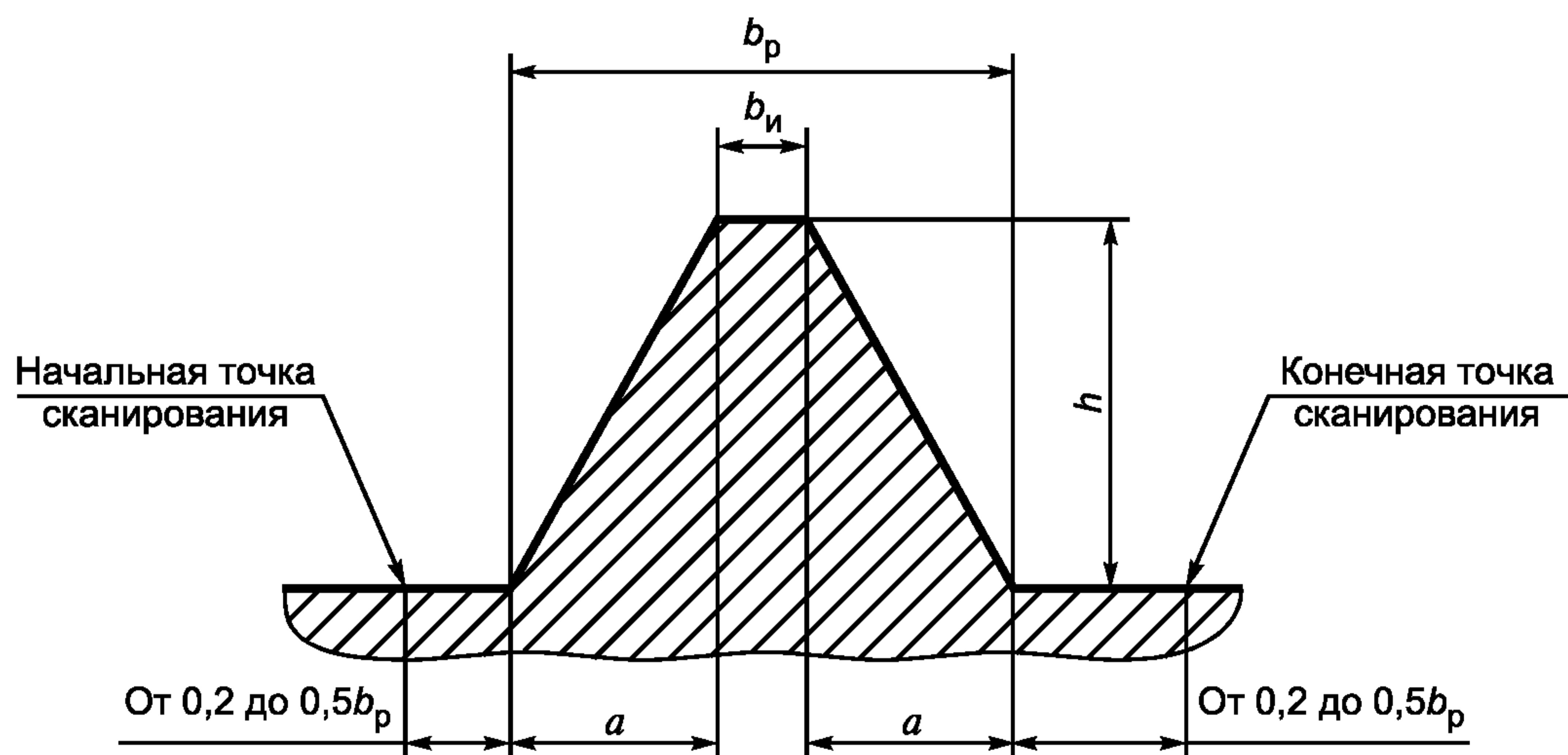
$b_p$  — ширина нижнего основания выступа;  $b_i$  — ширина верхнего основания выступа;  $h$  — высота выступа;  $a$  — значение проекции наклонной стенки на плоскость нижнего основания выступа
