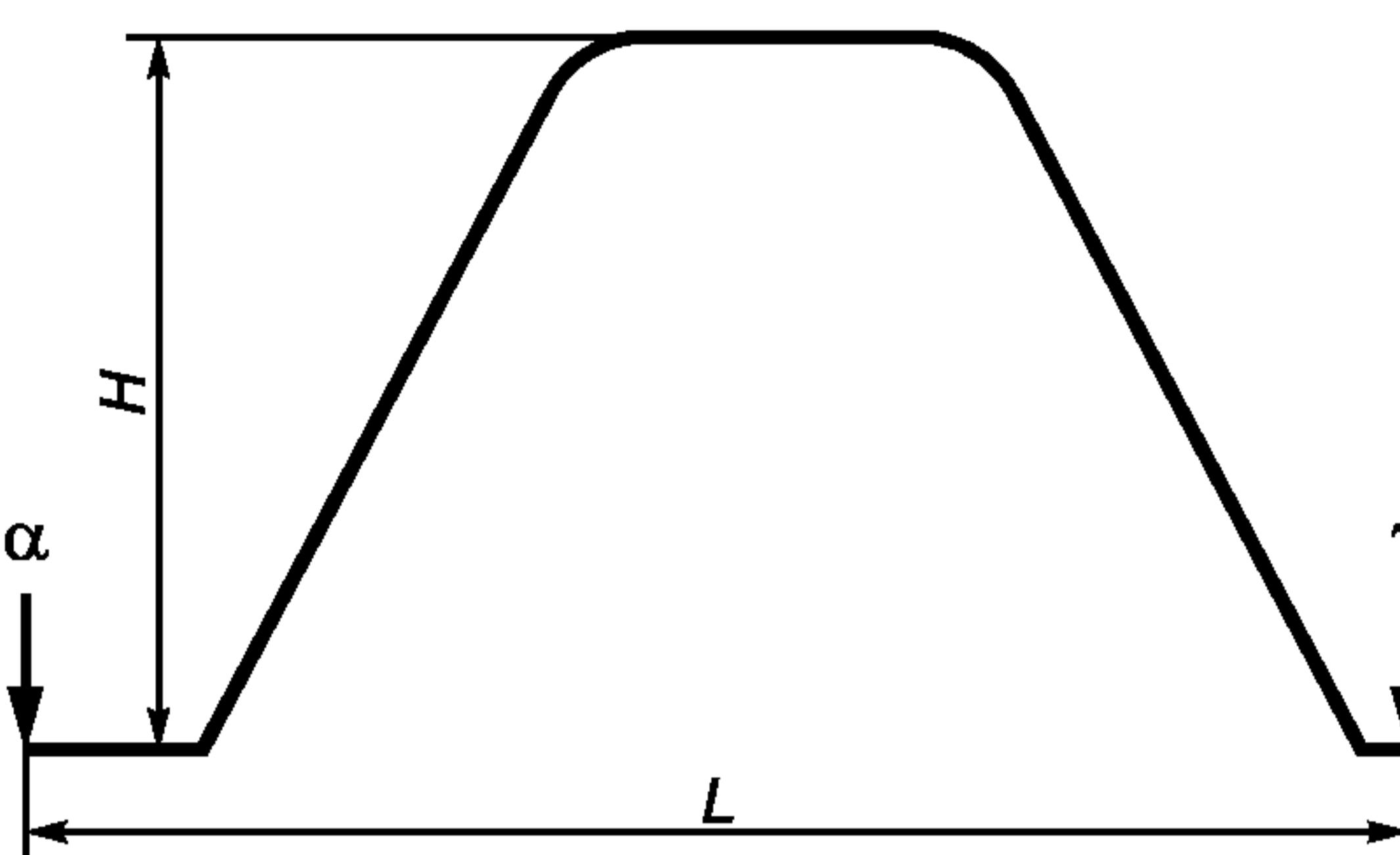
$\alpha$  — точка на видеопрофиле, соответствующая начальному положению зонда АСМ при сканировании;  $\gamma$  — точка на видеопрофиле, соответствующая конечному положению зонда при сканировании;  $H$  — высота выступа, измеренная по видеопрофилю;  $L$  — разность абсцисс конечной и начальной точек горизонтального сканирования, соответствующая значению горизонтального перемещения подвижной части рабочего стола АСМ, вычисленная по видеопрофилю
