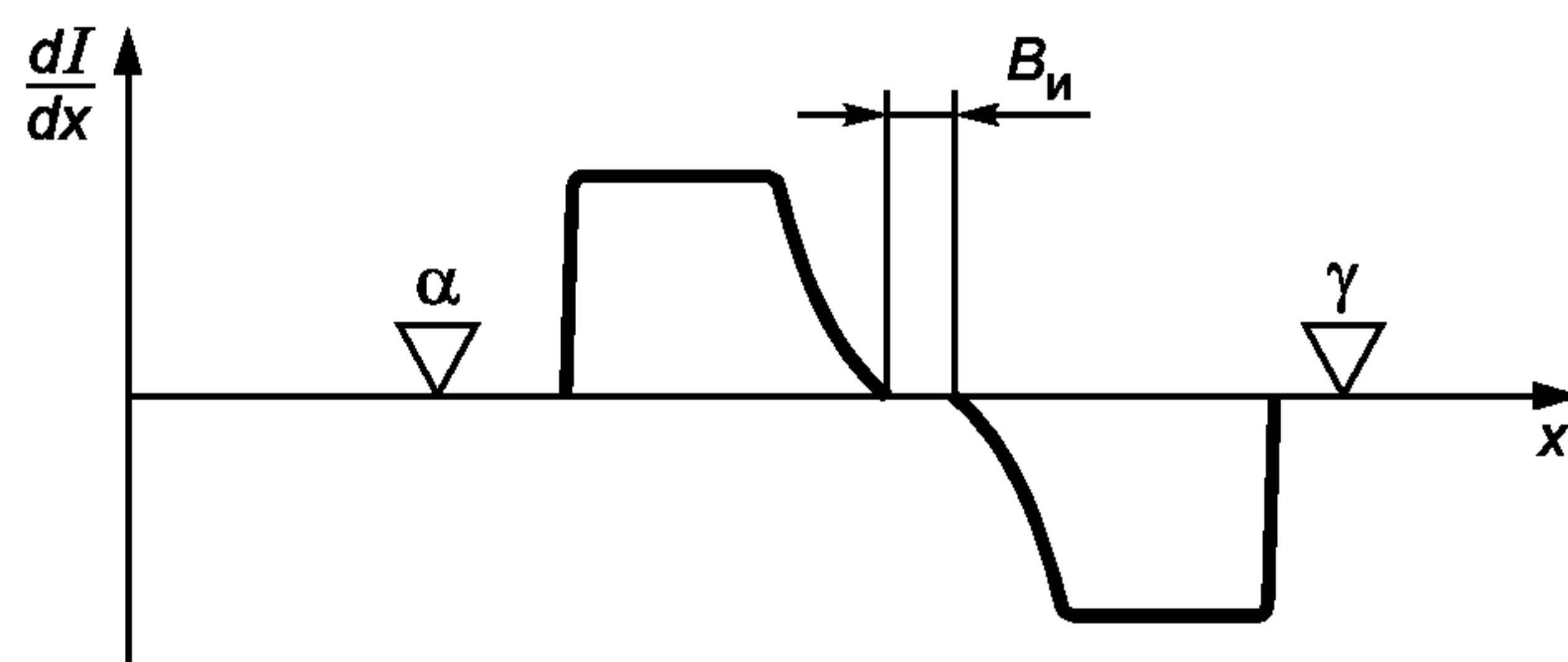
$x$  — ось абсцисс по 7.5;  $\alpha, \gamma$  — начальная и конечная точки положения зонда АСМ при сканировании калибруемого элемента, расположенные в соответствии с требованиями 7.4;  $\frac{dI}{dx}$  — ось ординат значений производной величины видеосигнала по координате  $x$ .
