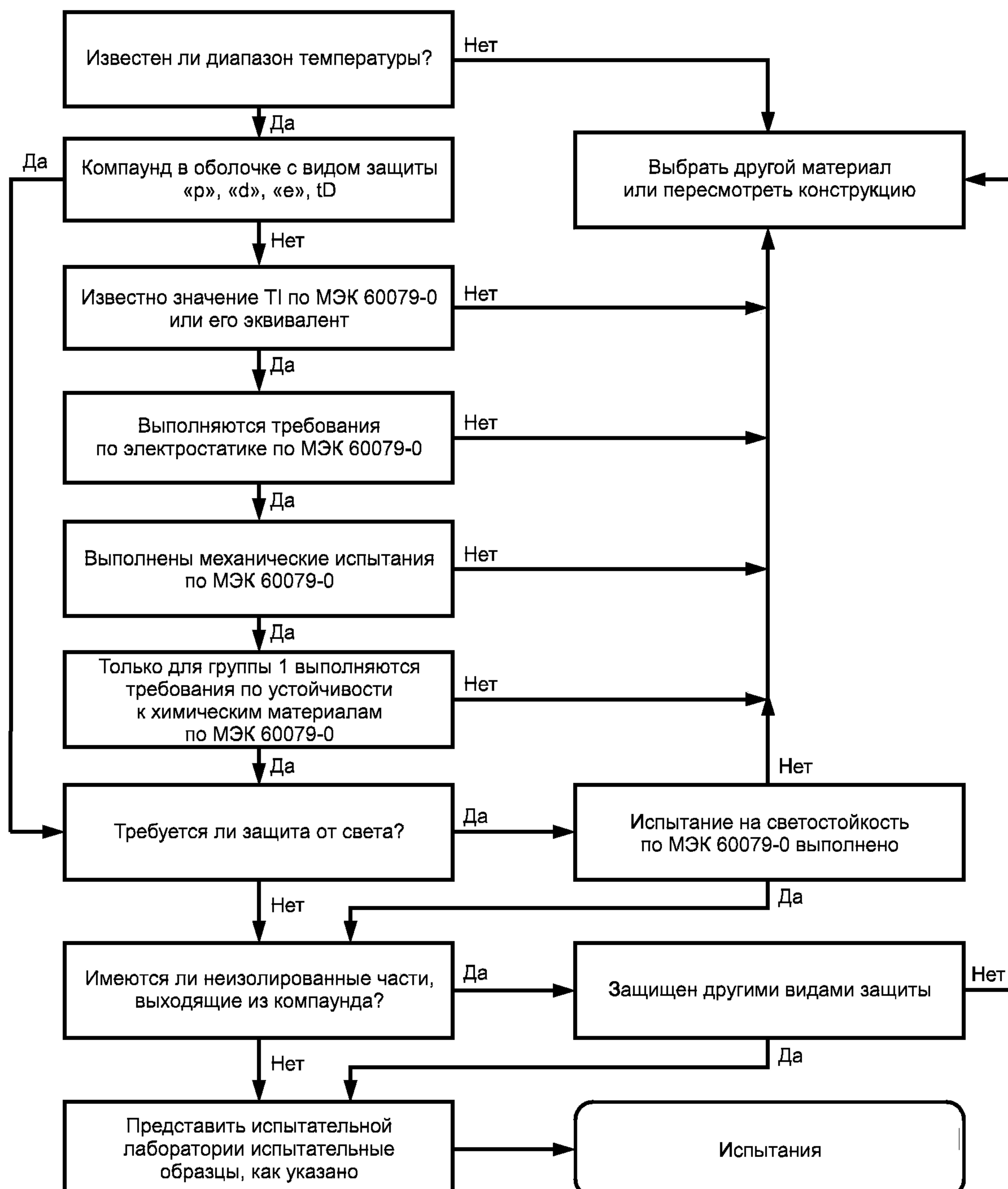
Рисунок А.1 — Основные требования к компаундам для оборудования с взрывозащитой вида «герметизация компаундом "т"»
