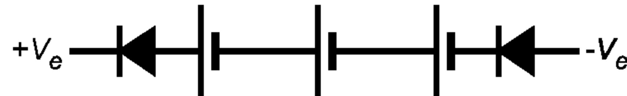
Рисунок 5 — Установка блокировочных диодов
