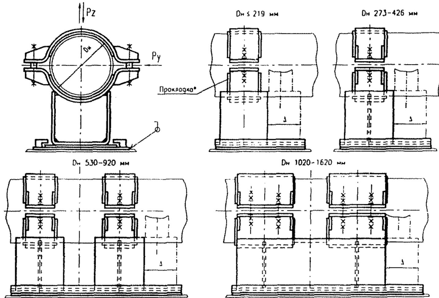
\*Для трубопроводов из коррозионно-стойкой стали
