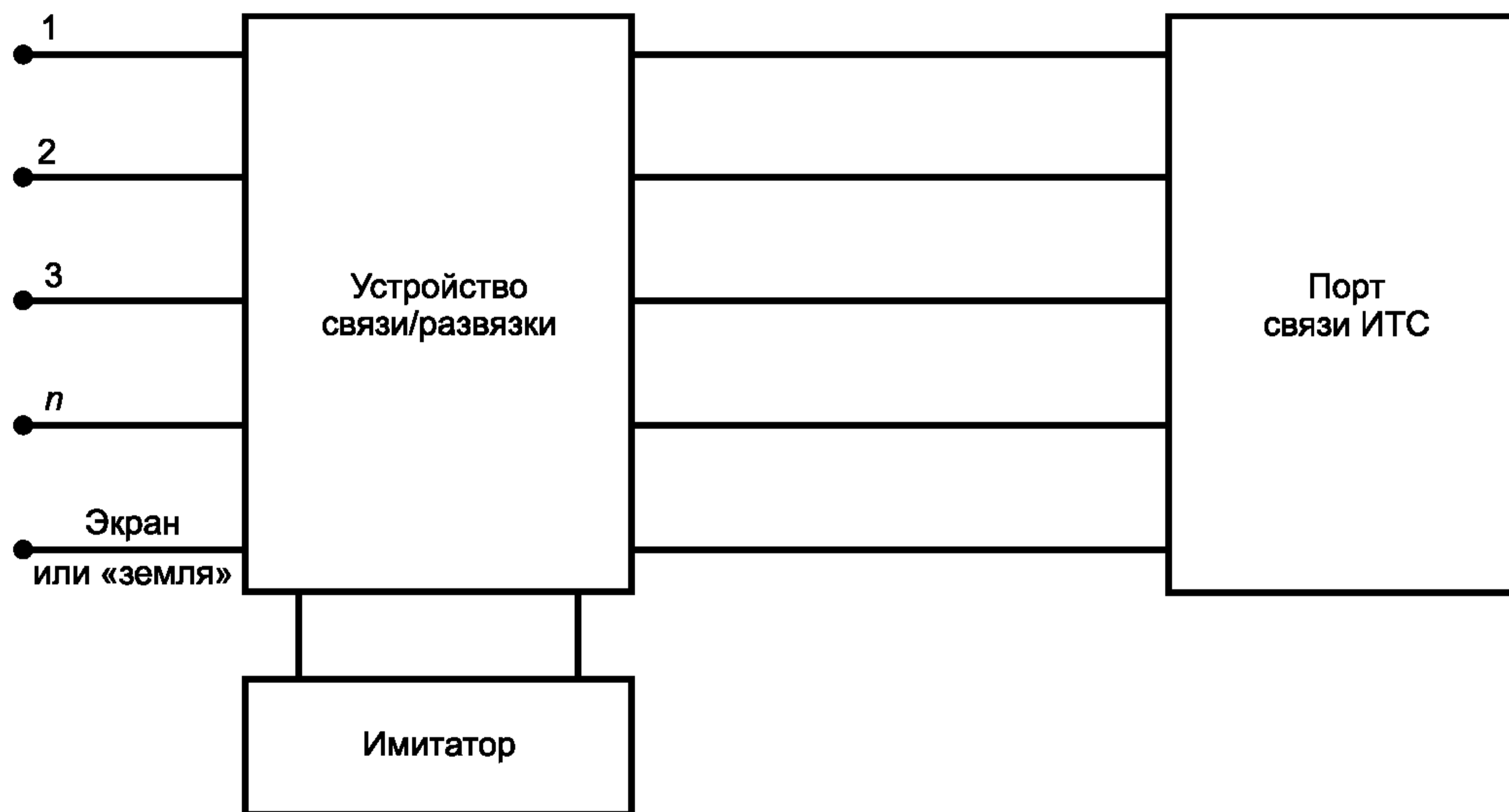
Рисунок Д.4 — Схема подключения имитатора ПД ЭМВ по проводным линиям связи
