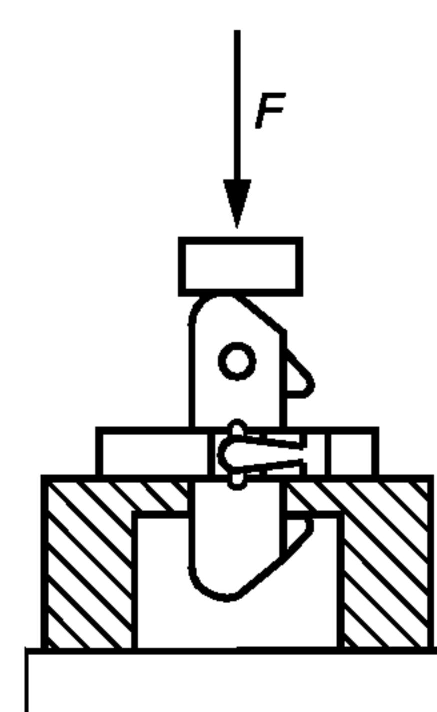
Рисунок В.11 — Испытание конуса стопора на сжатие
