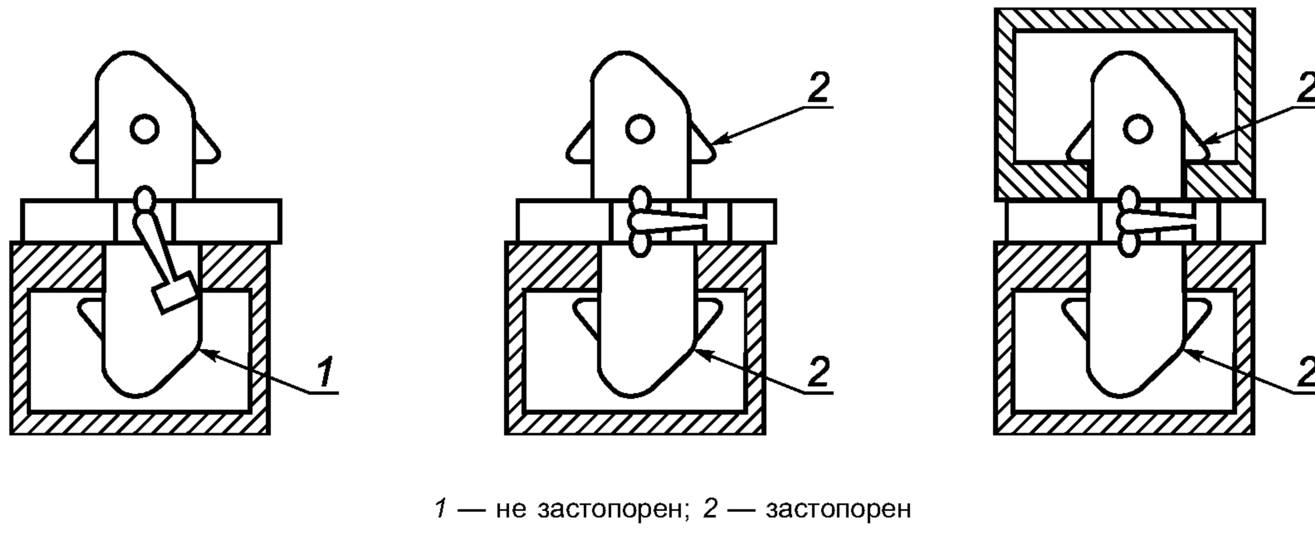
Рисунок В.3 — Полуавтоматический двусторонний стопор, установленный в верхний угловой фитинг
