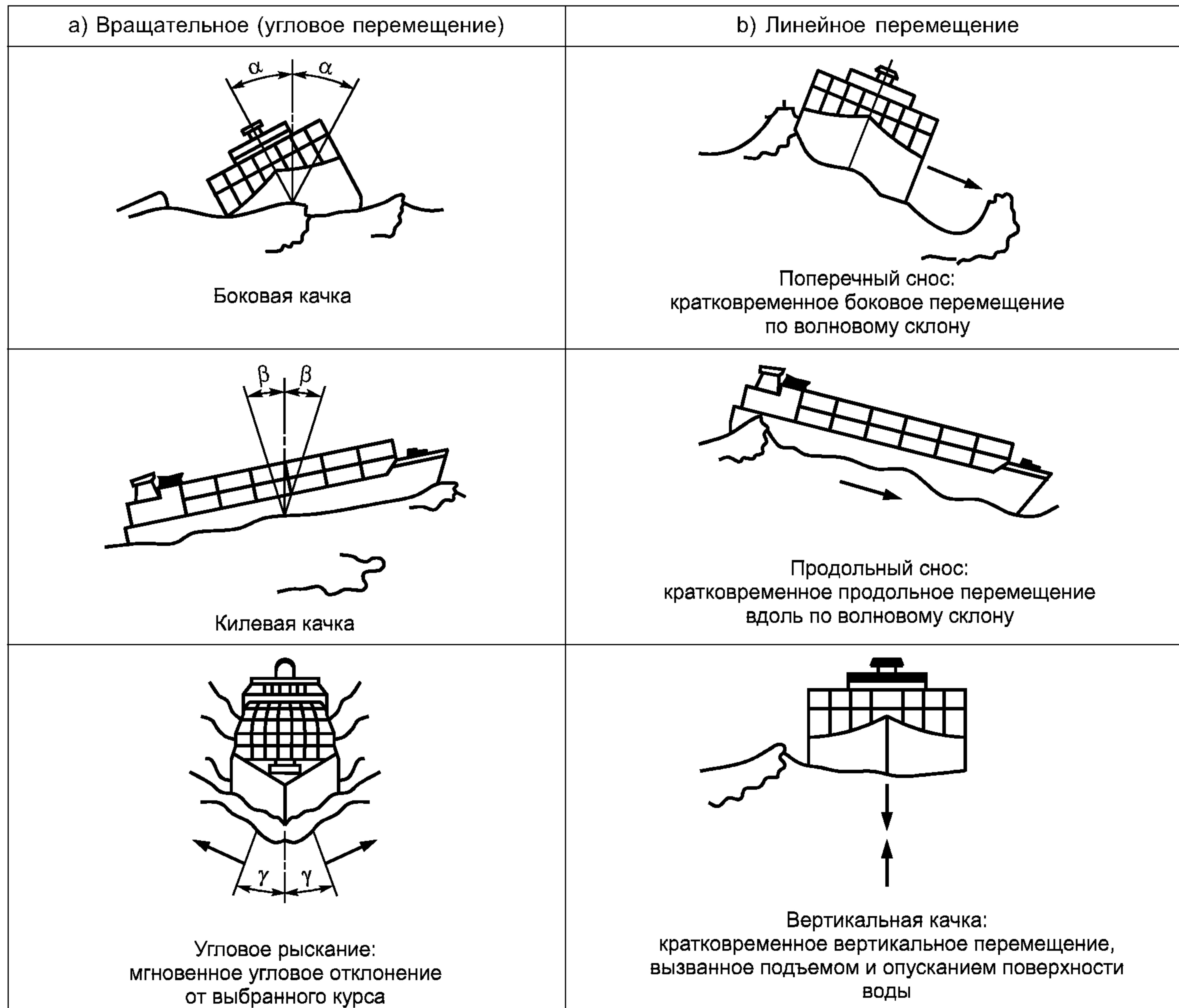
Рисунок 17 — Примеры перемещения судна при волнении моря
