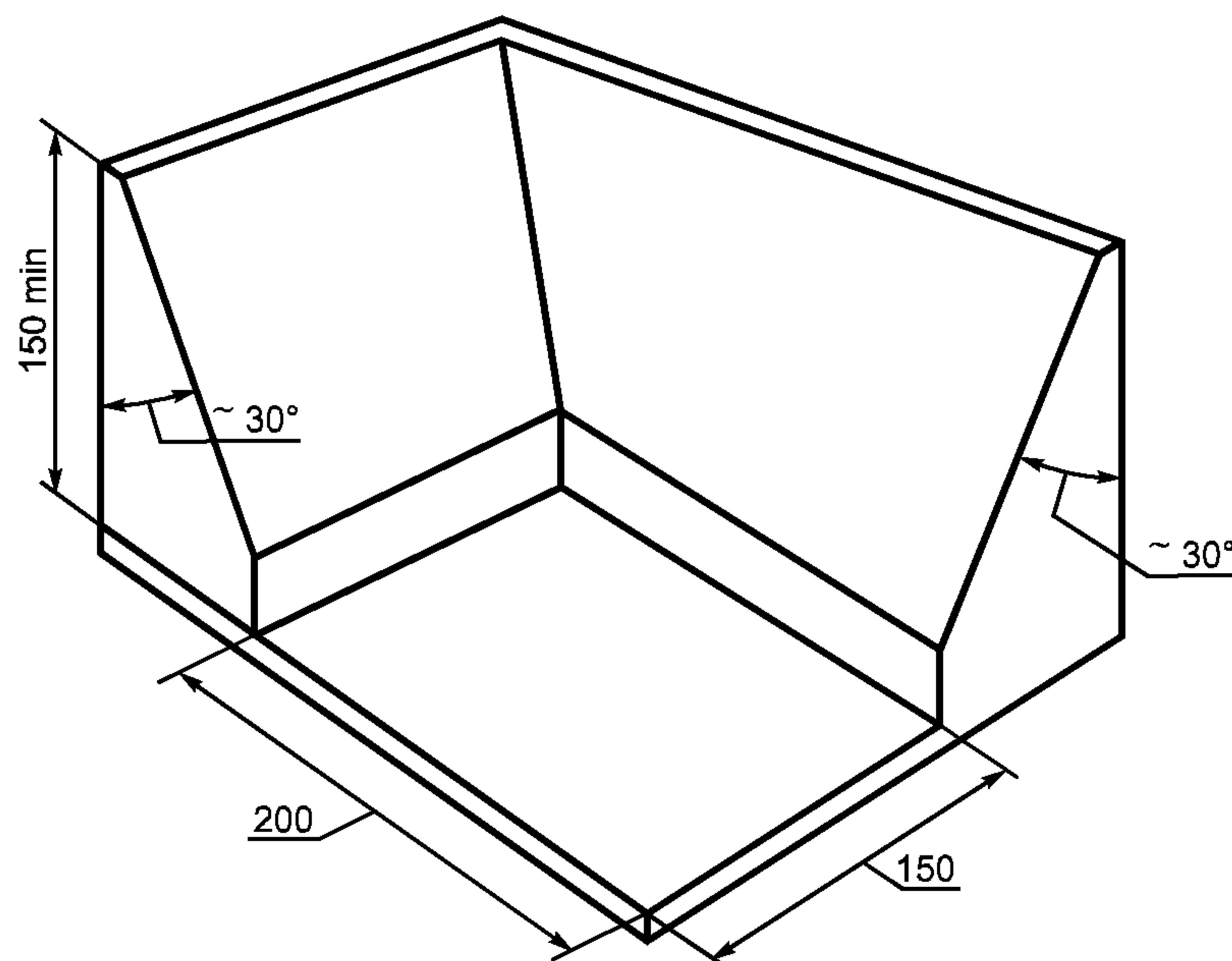
Рисунок 24 — Пример уголковой направляющей с горизонтальным упором
