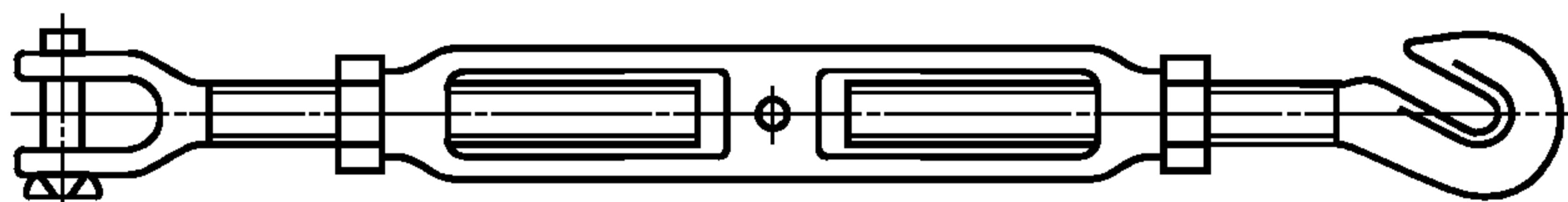
Рисунок D.6 — Типовой пример устройства натяжения (тальреп с контргайками)
