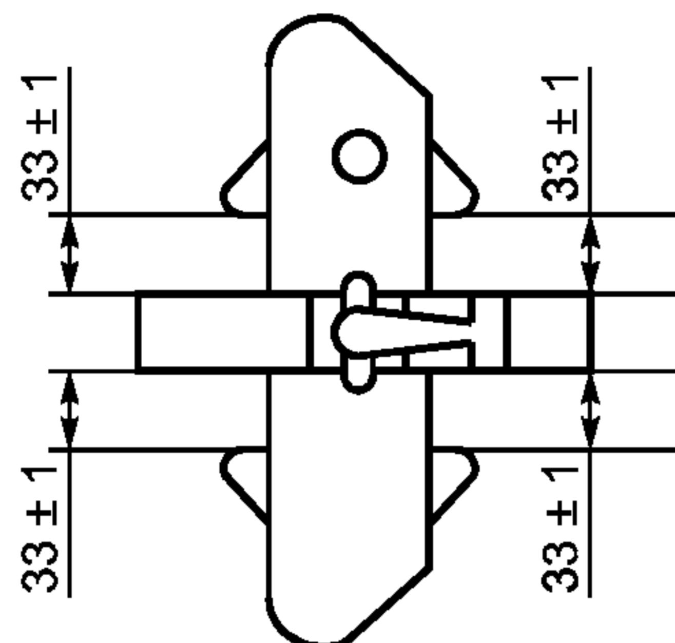
Рисунок B.8 — Расстояние между верхними и нижними ригельными фиксаторами
