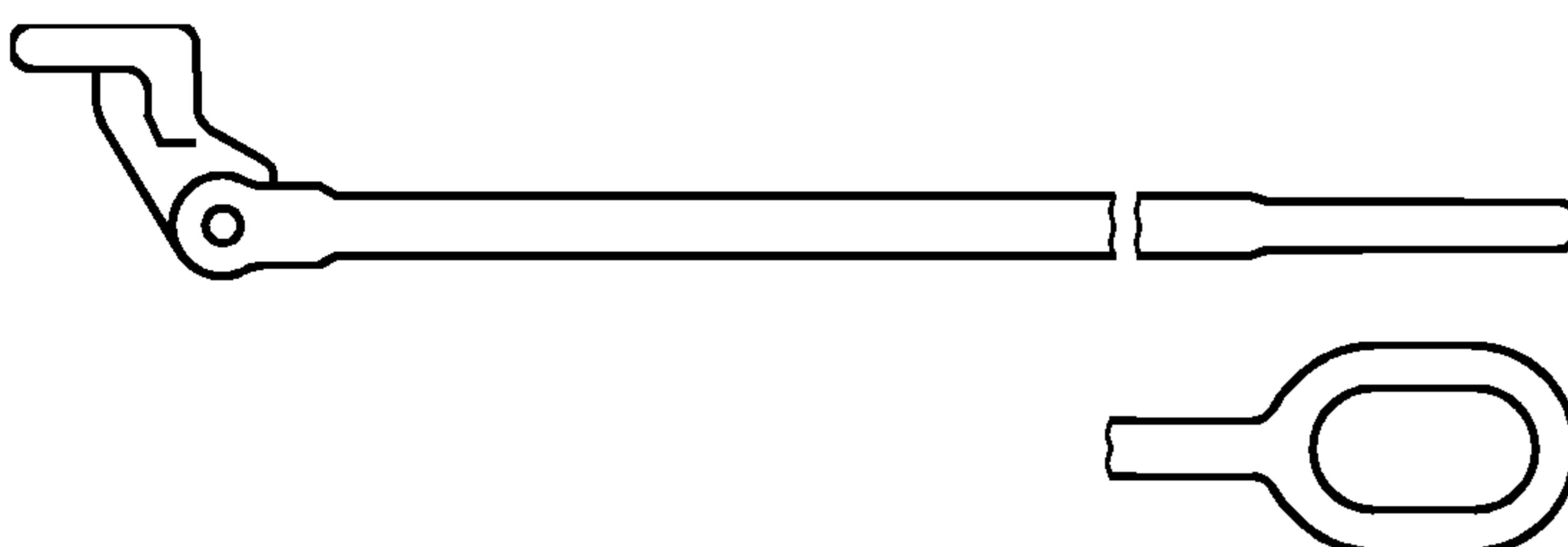
Рисунок D.4 — Контейнерная штанга с шарнирным оголовком
