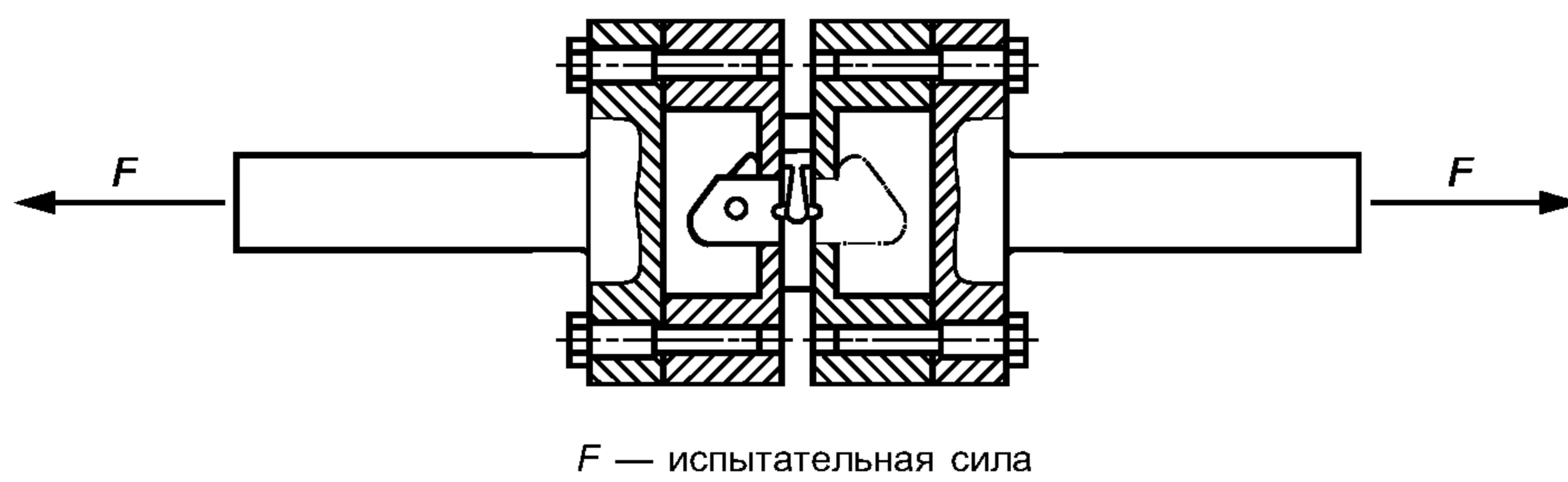
Рисунок В.9 — Испытание стопора на растяжение
