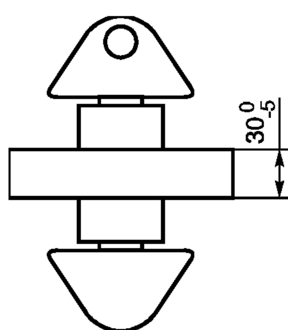
Рисунок А.6 — Промежуточная пластина
