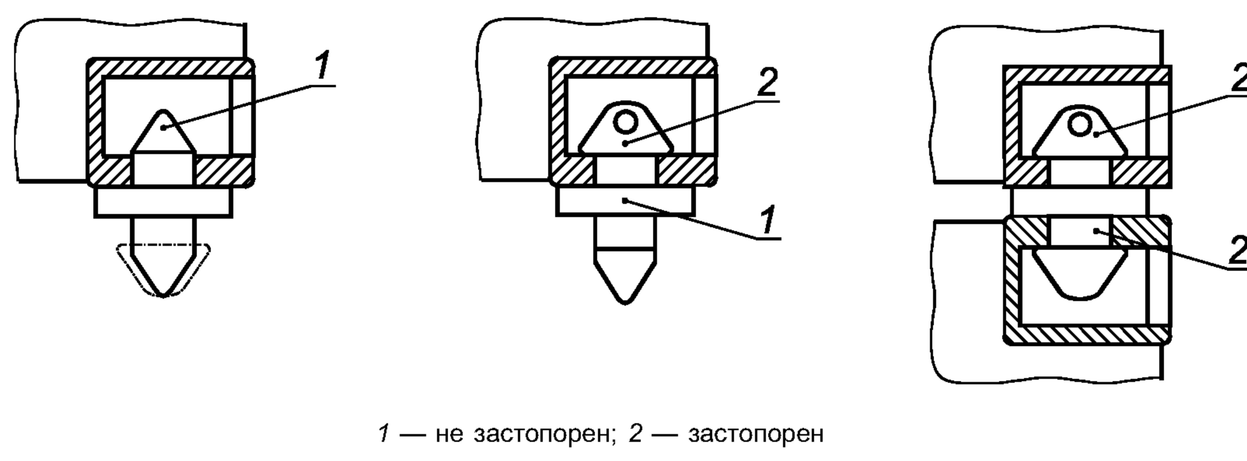
Рисунок А.4 — Полуавтоматический стопор, установленный в верхний угловой фитинг
