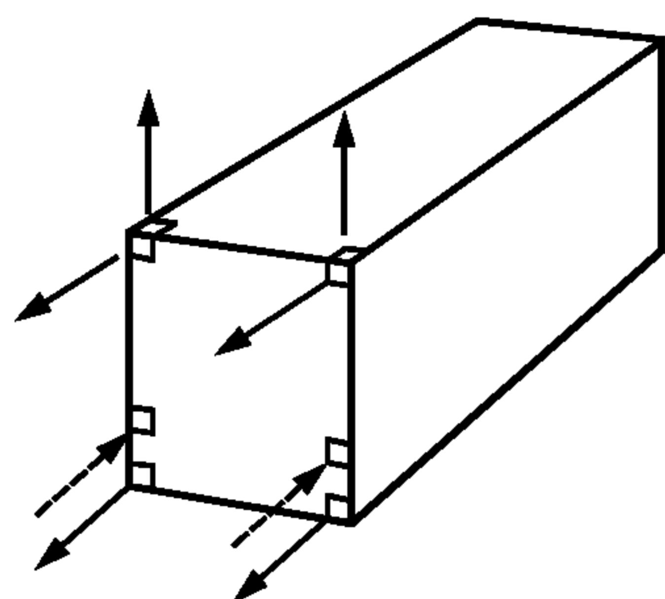
Рисунок 13 — Подъем за торцевые угловые фитинги (способ 2)
