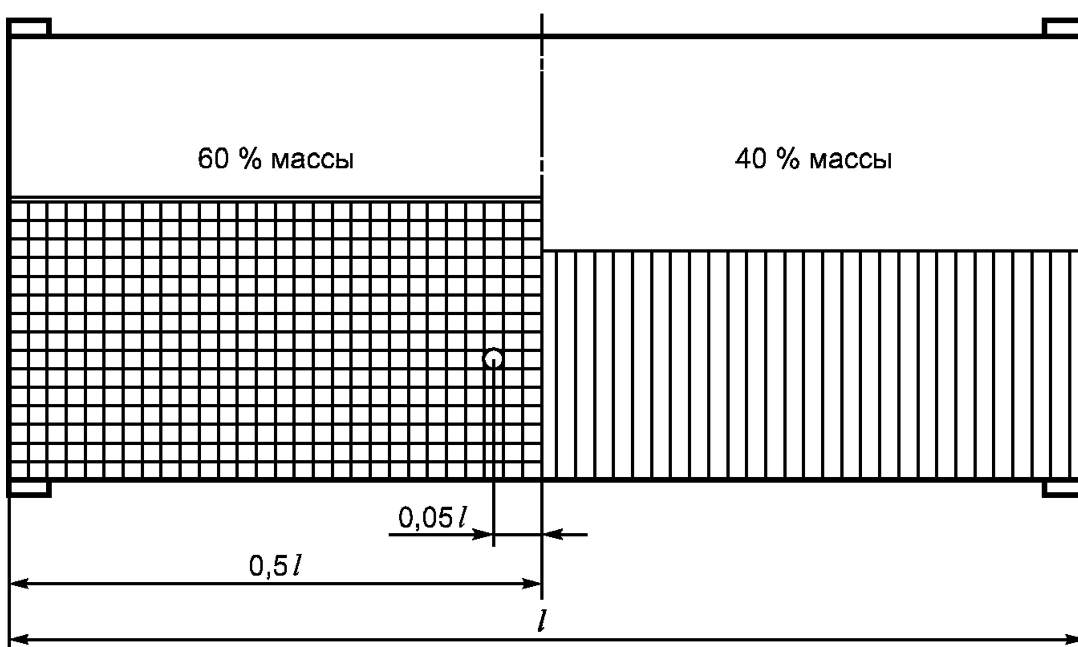
Рисунок 1 — Распределение нагрузки
