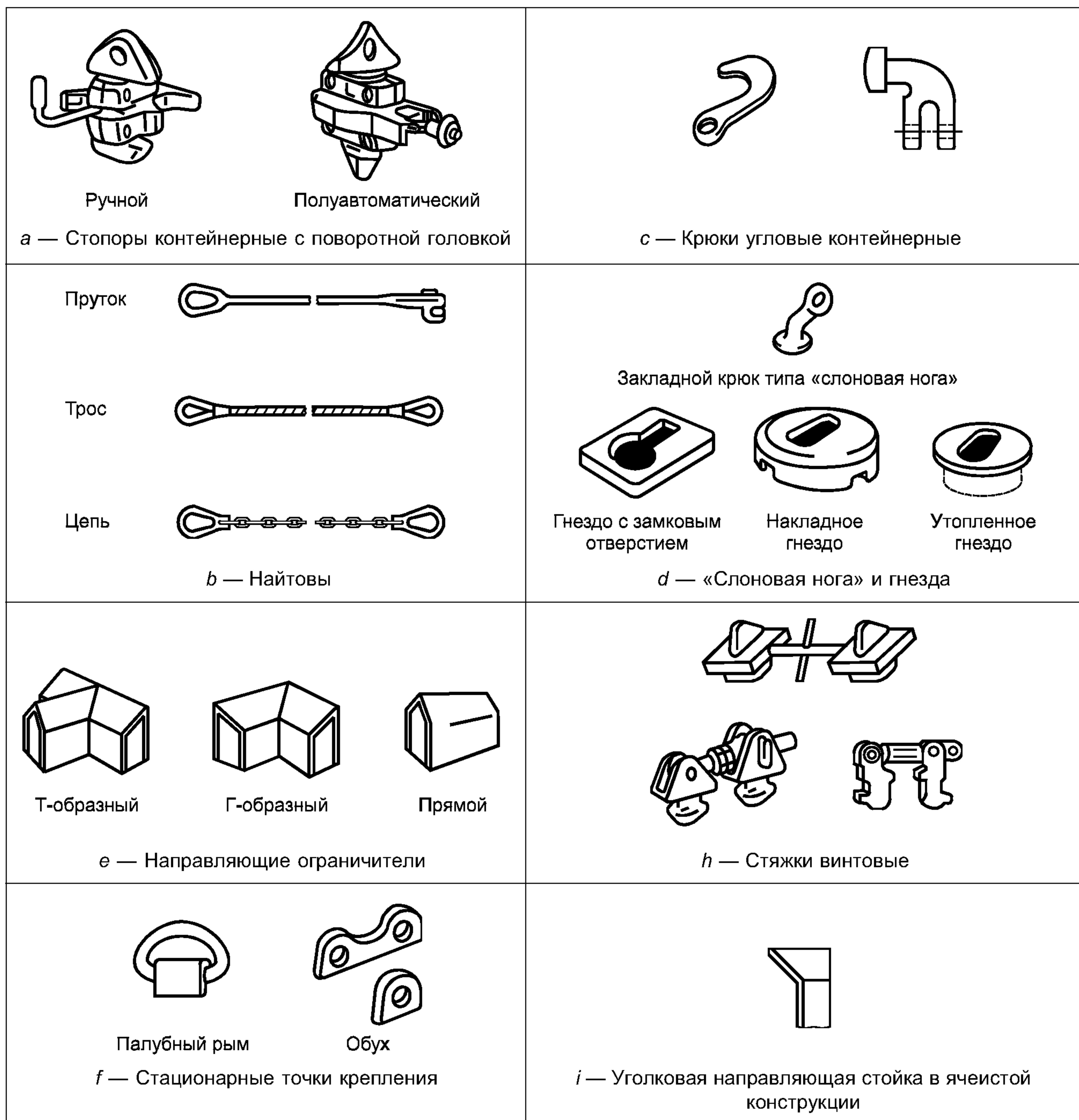
Рисунок 23 — Примеры типовых устройств для крепления контейнеров, лист 1
