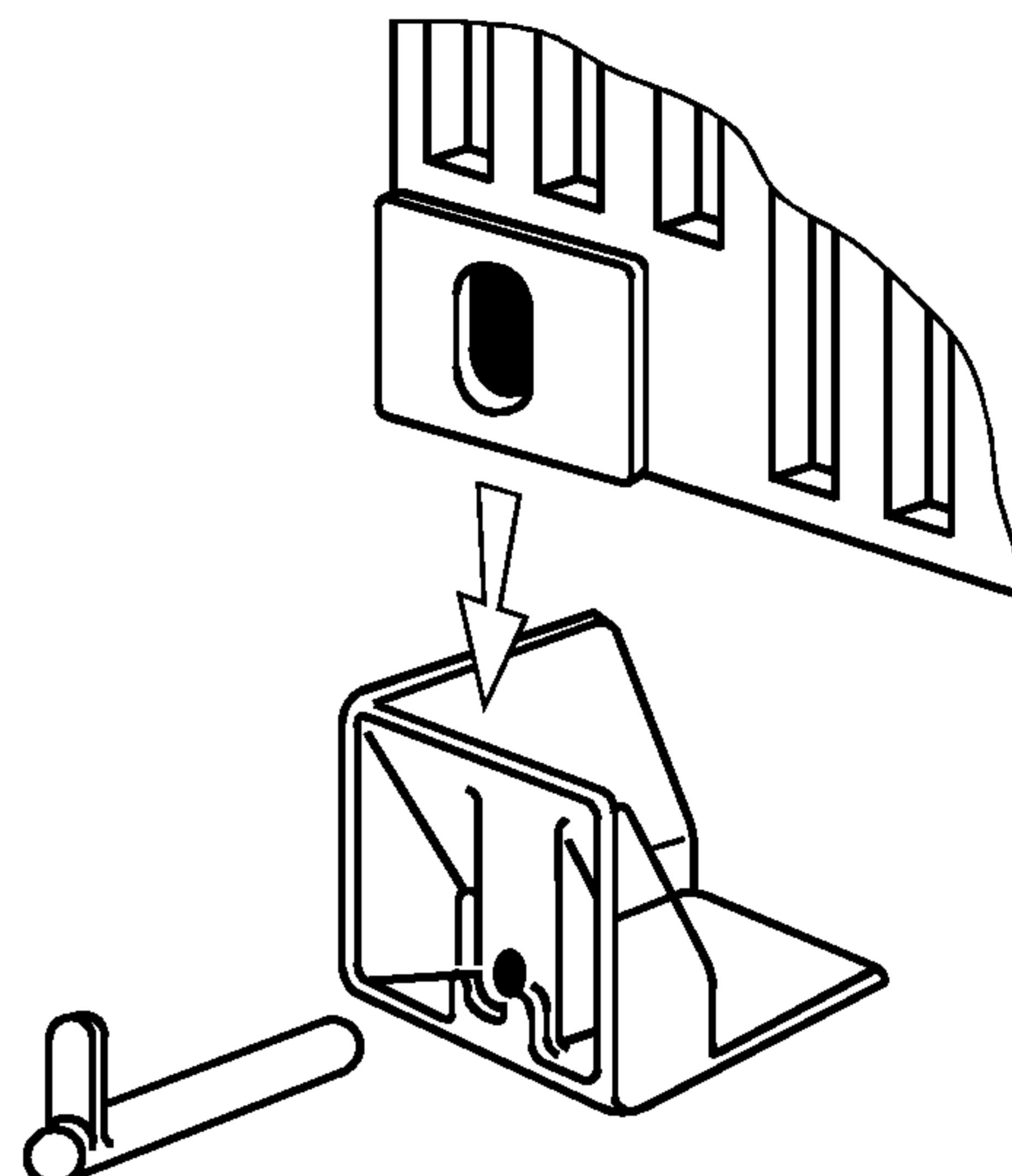
Рисунок 28 — Углковый направляющий ограничитель со стопорным пальцем
