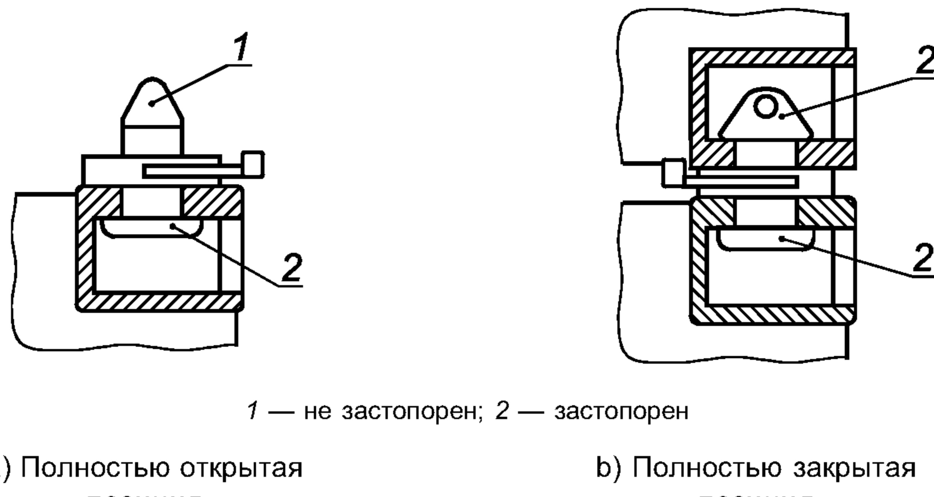
Рисунок А.1 — Ручной двухпозиционный стопор с фиксированным основанием и одной поворотной головкой
