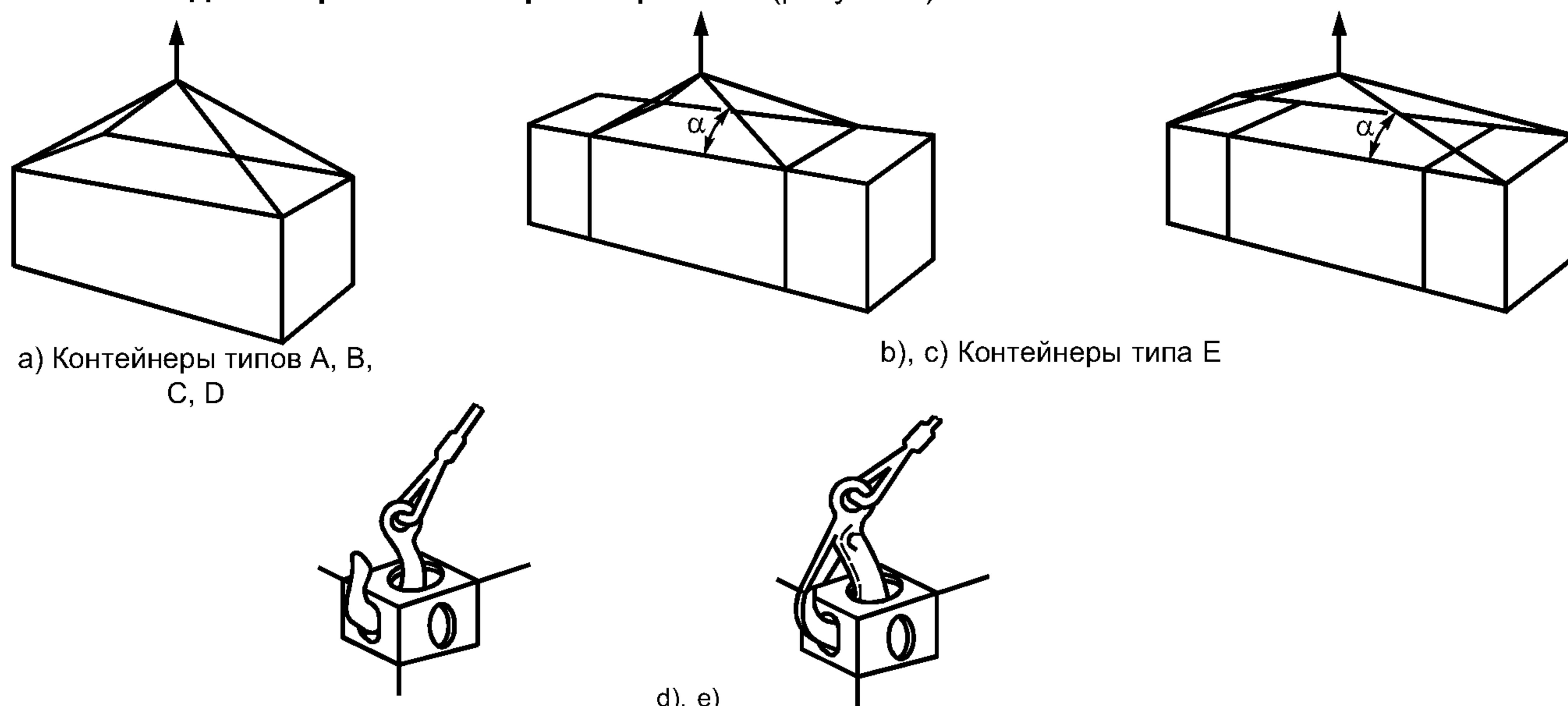
$\alpha$  — угол наклона стропов по таблице 6
