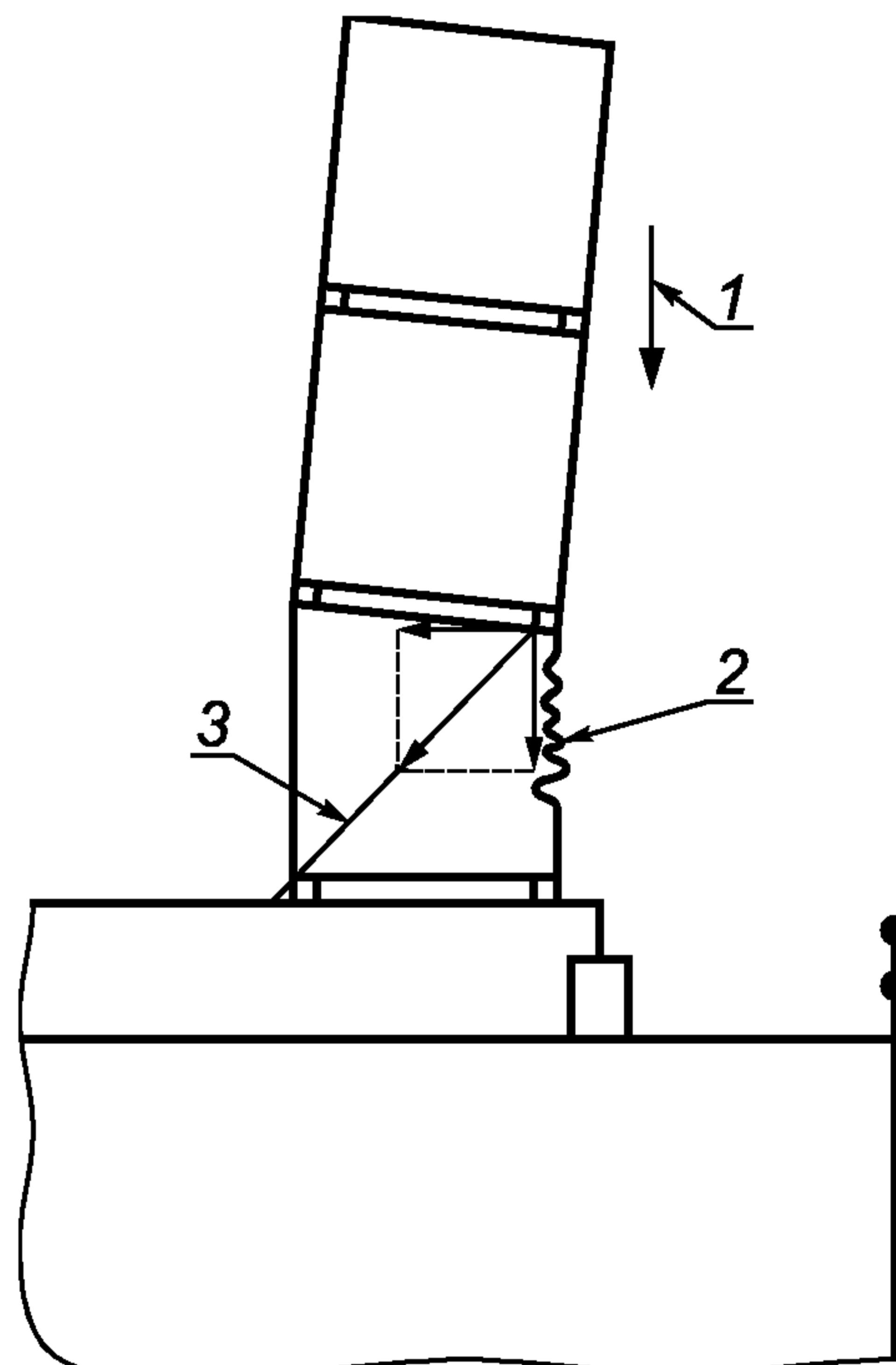
1 — сила сжатия; 2 — разрушение; 3 — найтов
