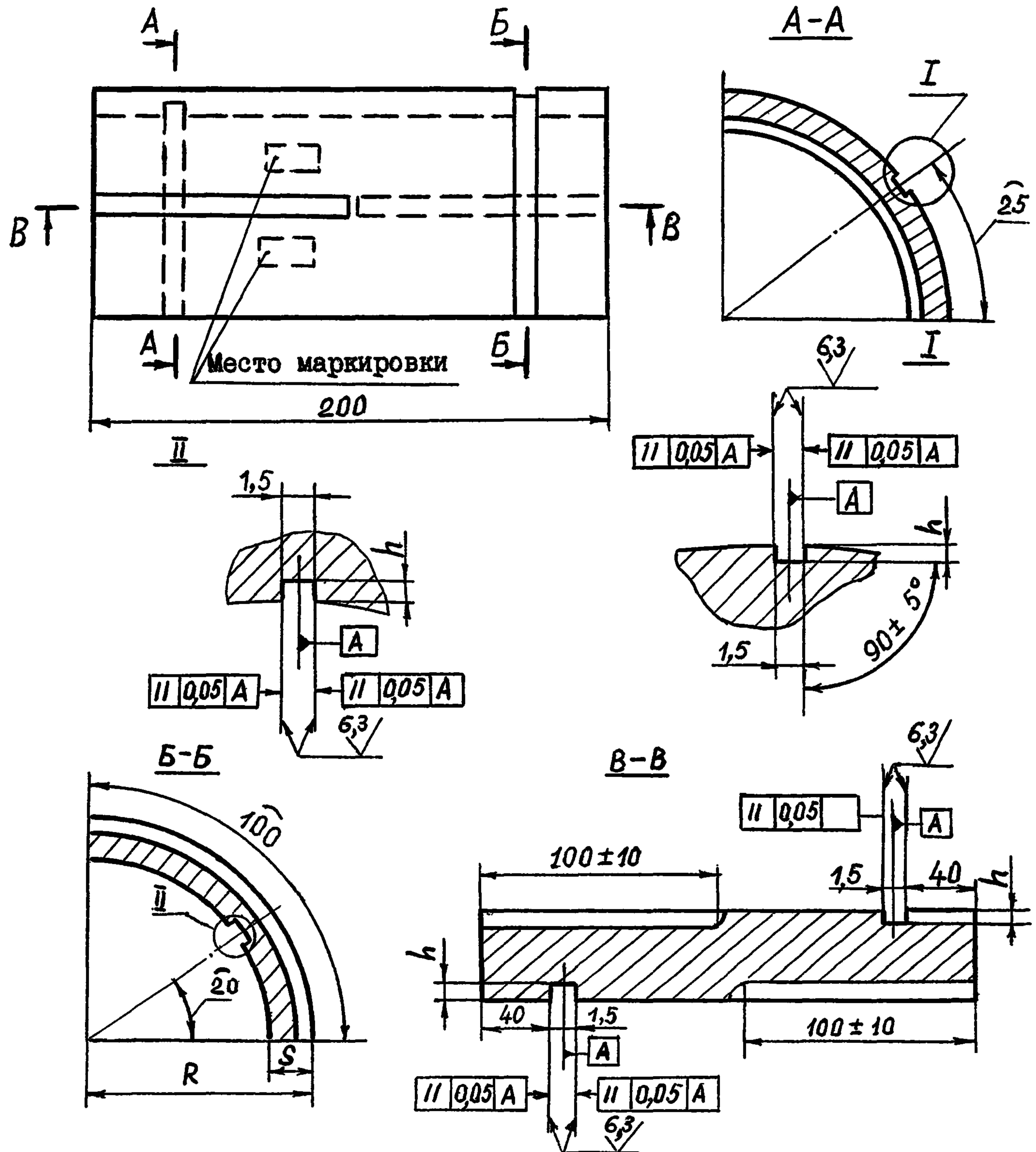
Маркировать марку стали, диаметр  $(2R)$ , толщину стенки  $S$ , глубину канавок  $h$
