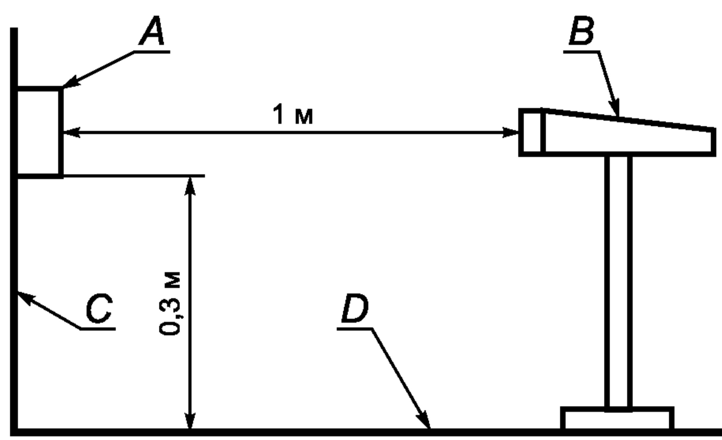
А — газосигнализатор, В — микрофон, С — стена (вертикальная плоскость),
