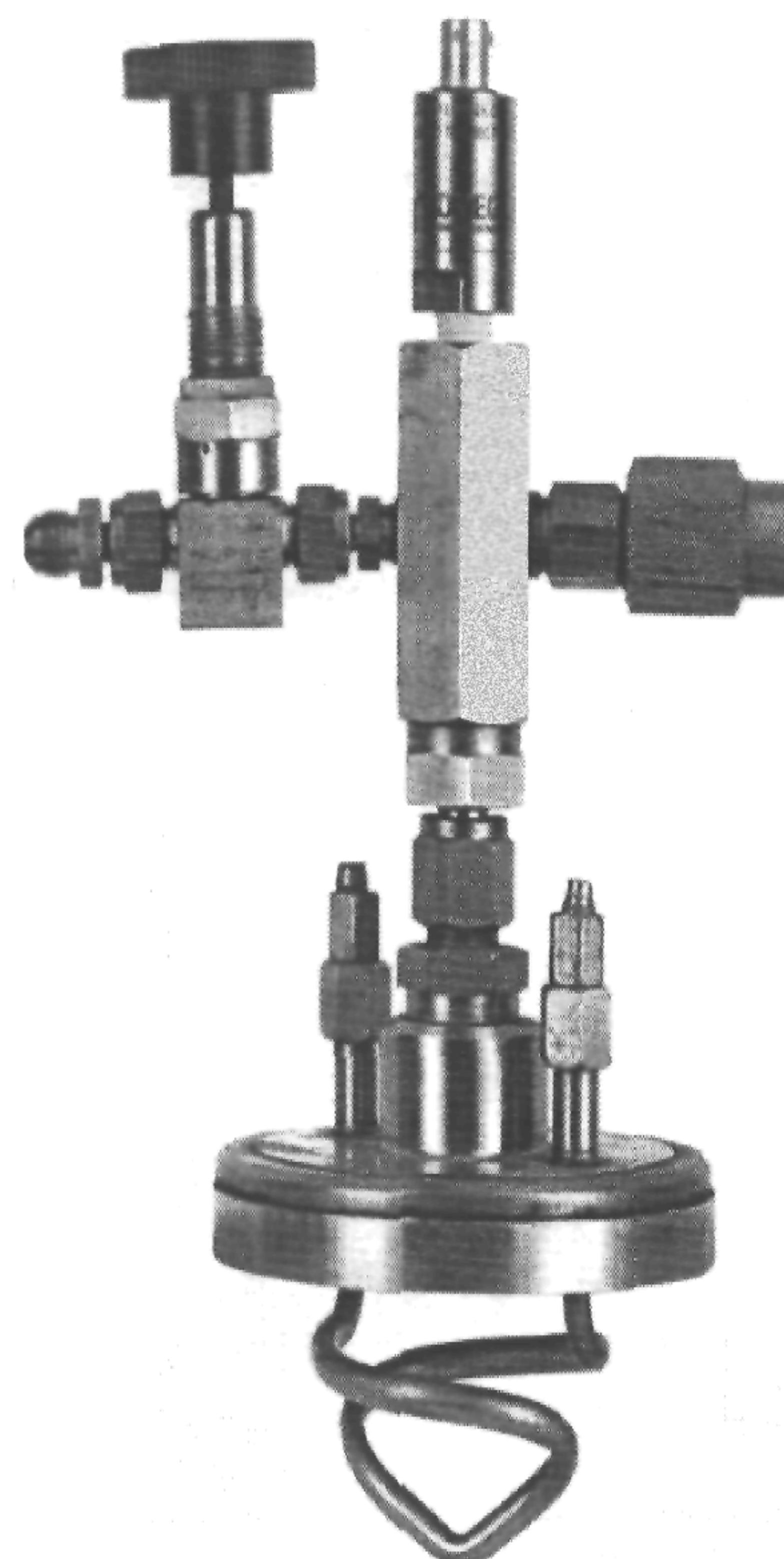
Рисунок 3 — Крышка с охлаждающим змеевиком
