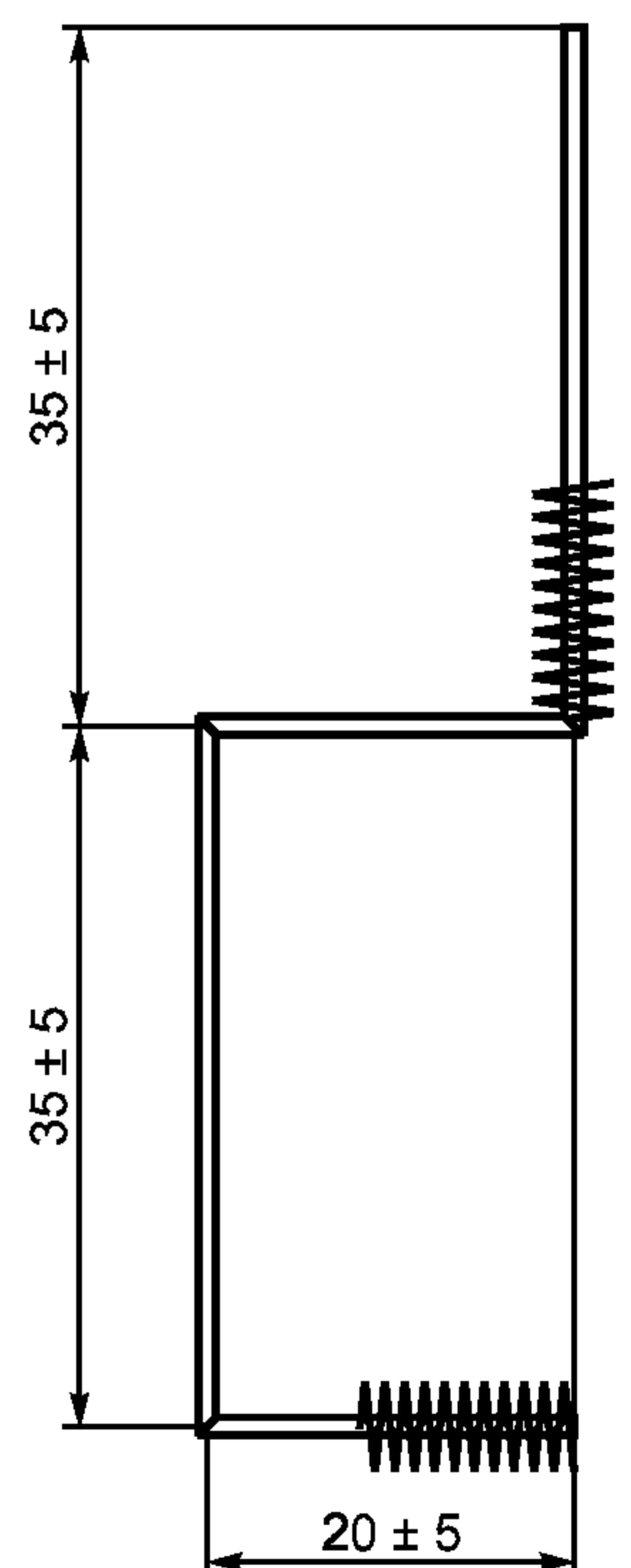
Рисунок 4 — Пример держателя для испытания на облучивание
