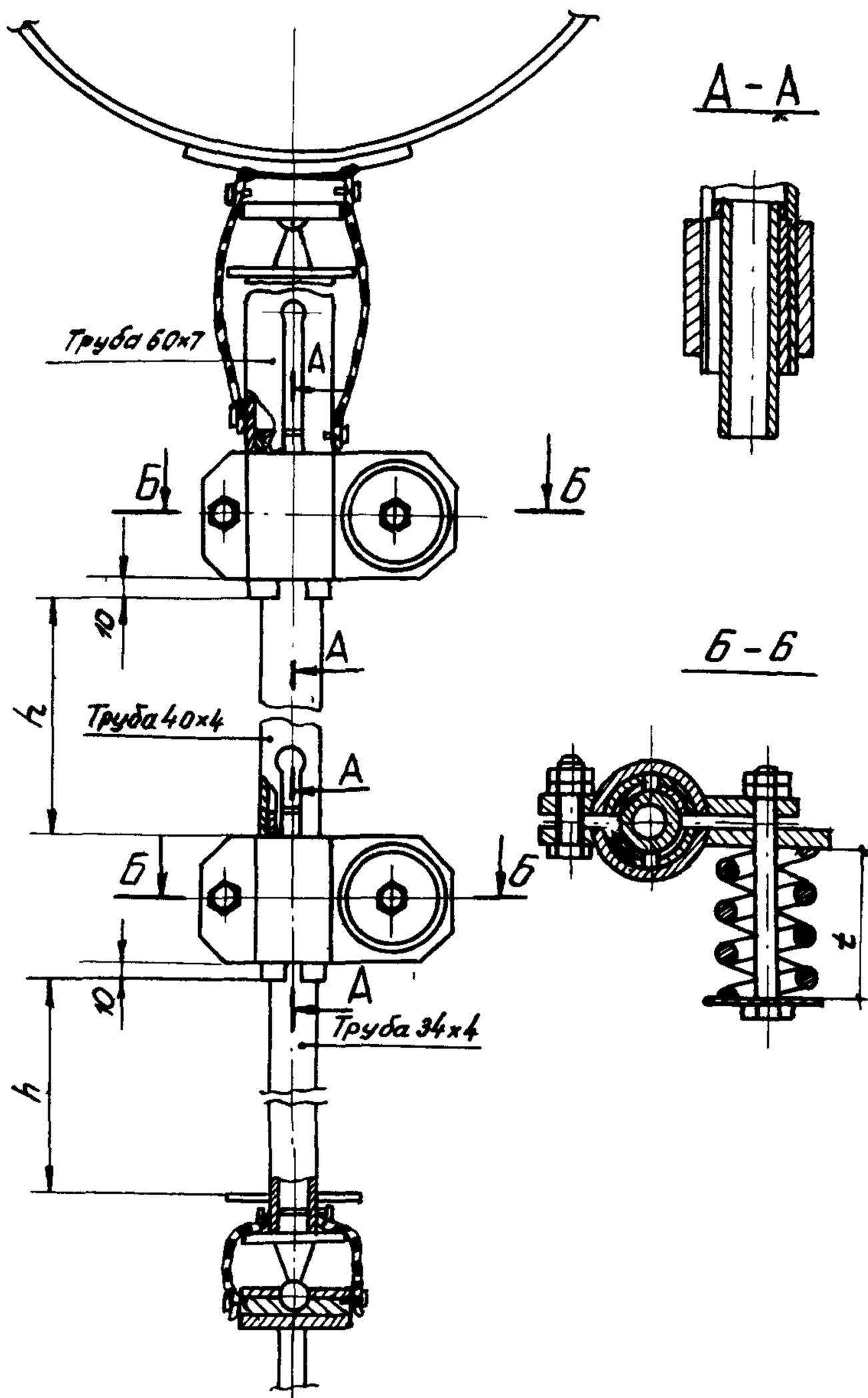
Рис.4. Устройство для предотвращения колебаний (двухходовое)
