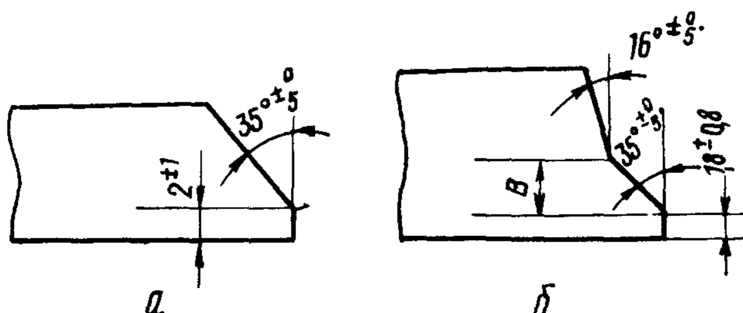
Рис. I. Типы разделки кромок труб:
