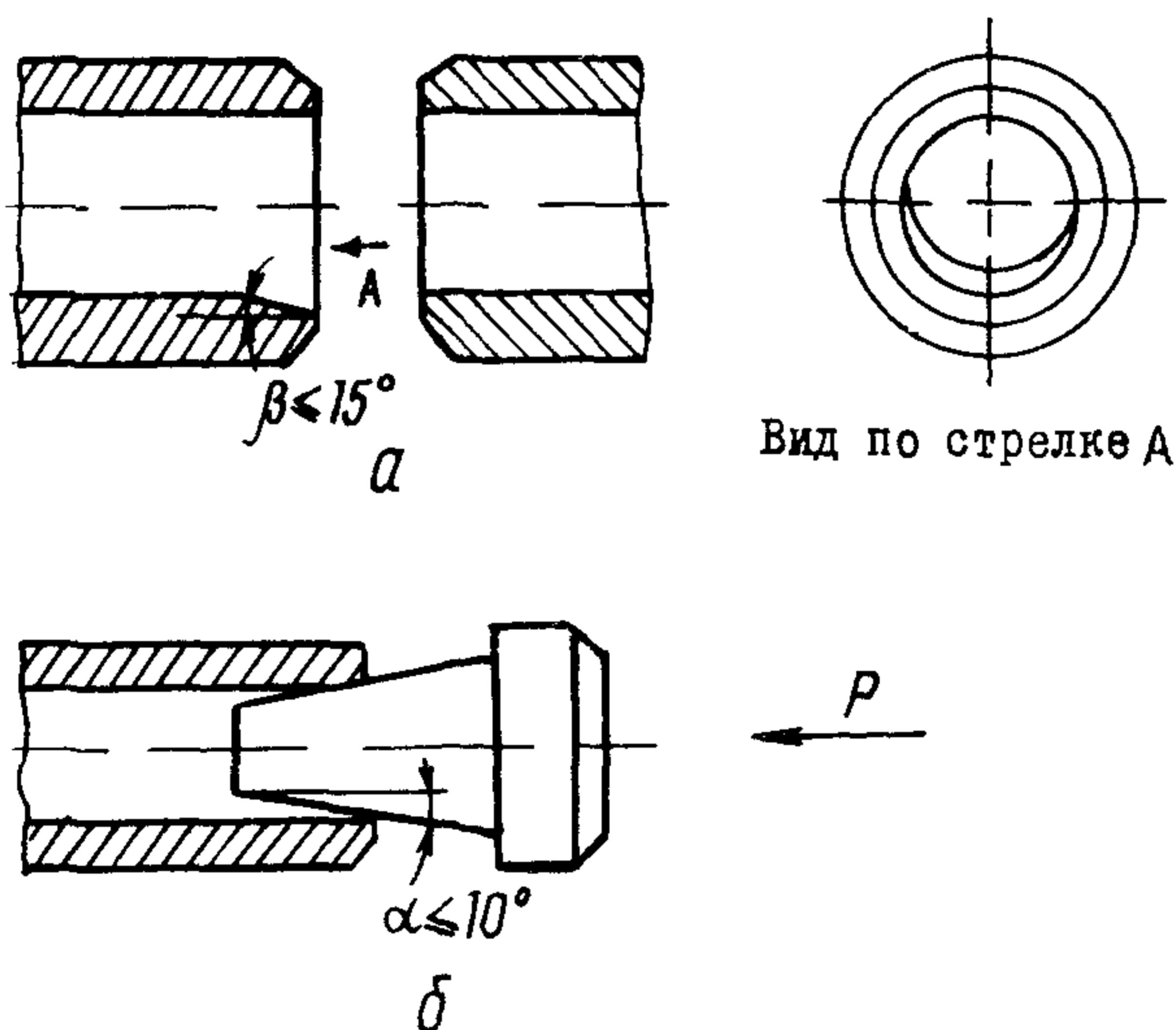
Рис.2. Подготовка концов труб под сварку:
