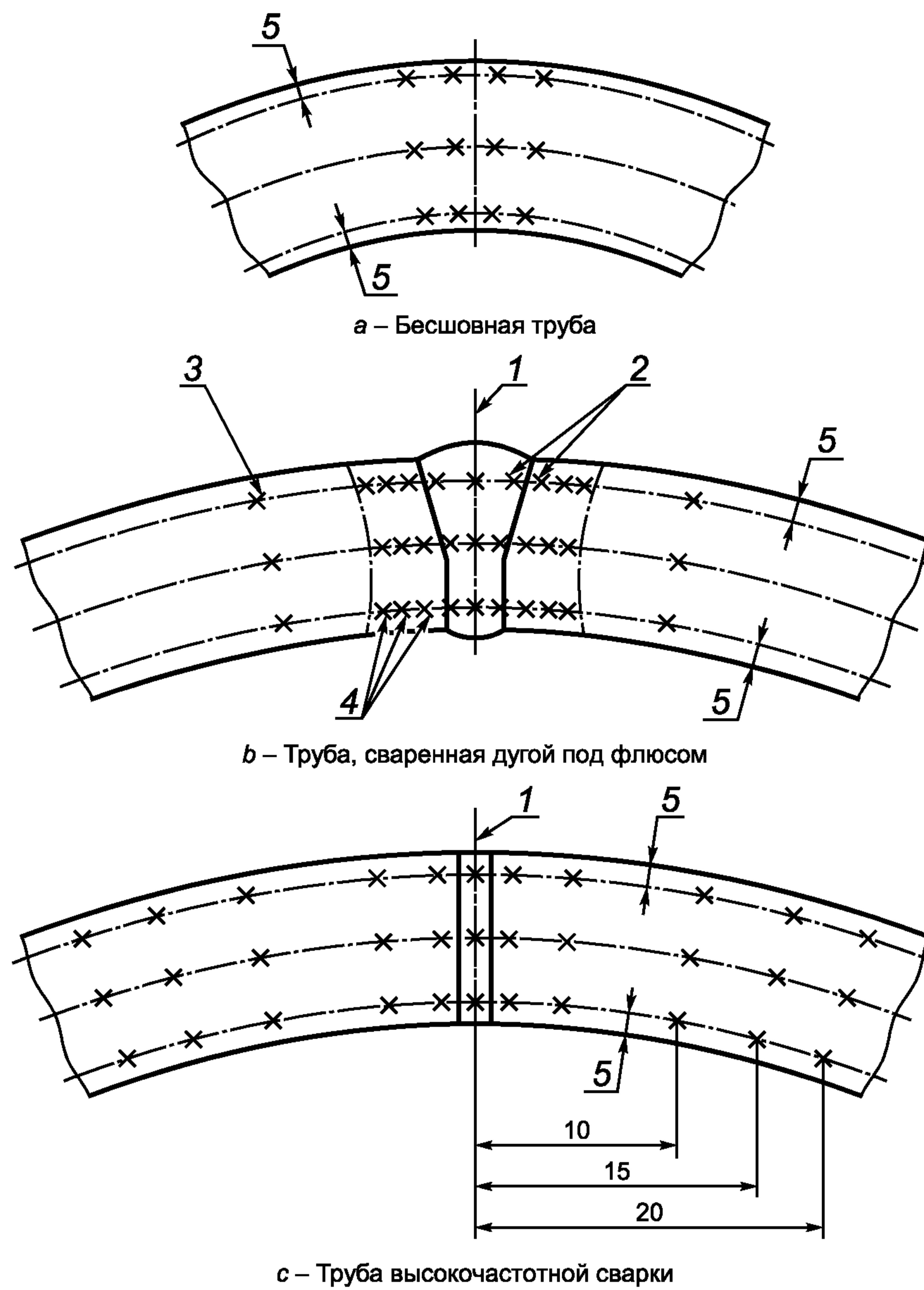
1 — ось шва; 2 — 0,75 мм от линии сплавления; 3 — 1 $T$  от линии сплавления, где  $T$  — номинальная толщина стенки труб, мм;
