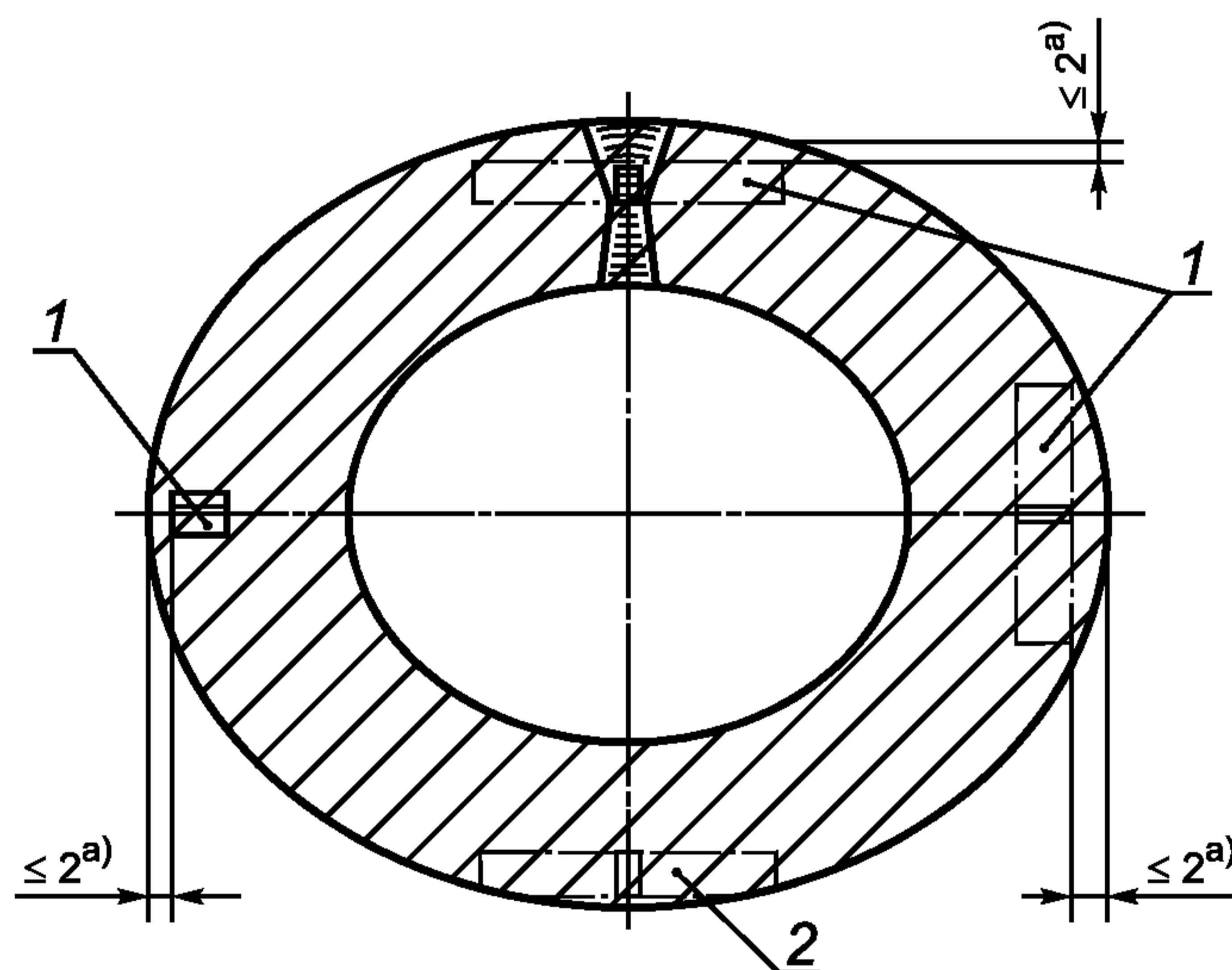
а — Расположение испытательных образцов
