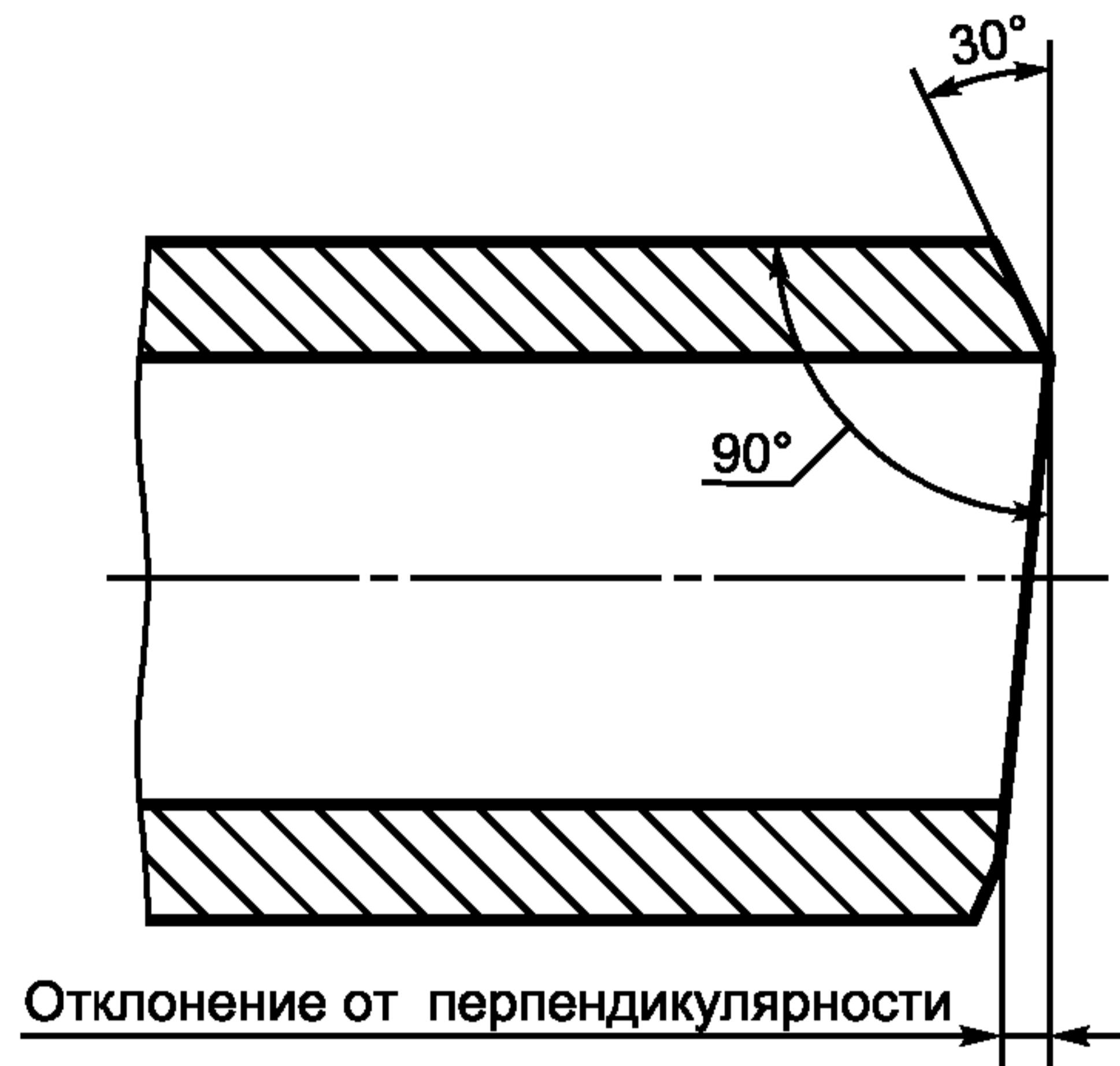
Рисунок 1 — Отклонение от перпендикулярности торца (косина реза)
