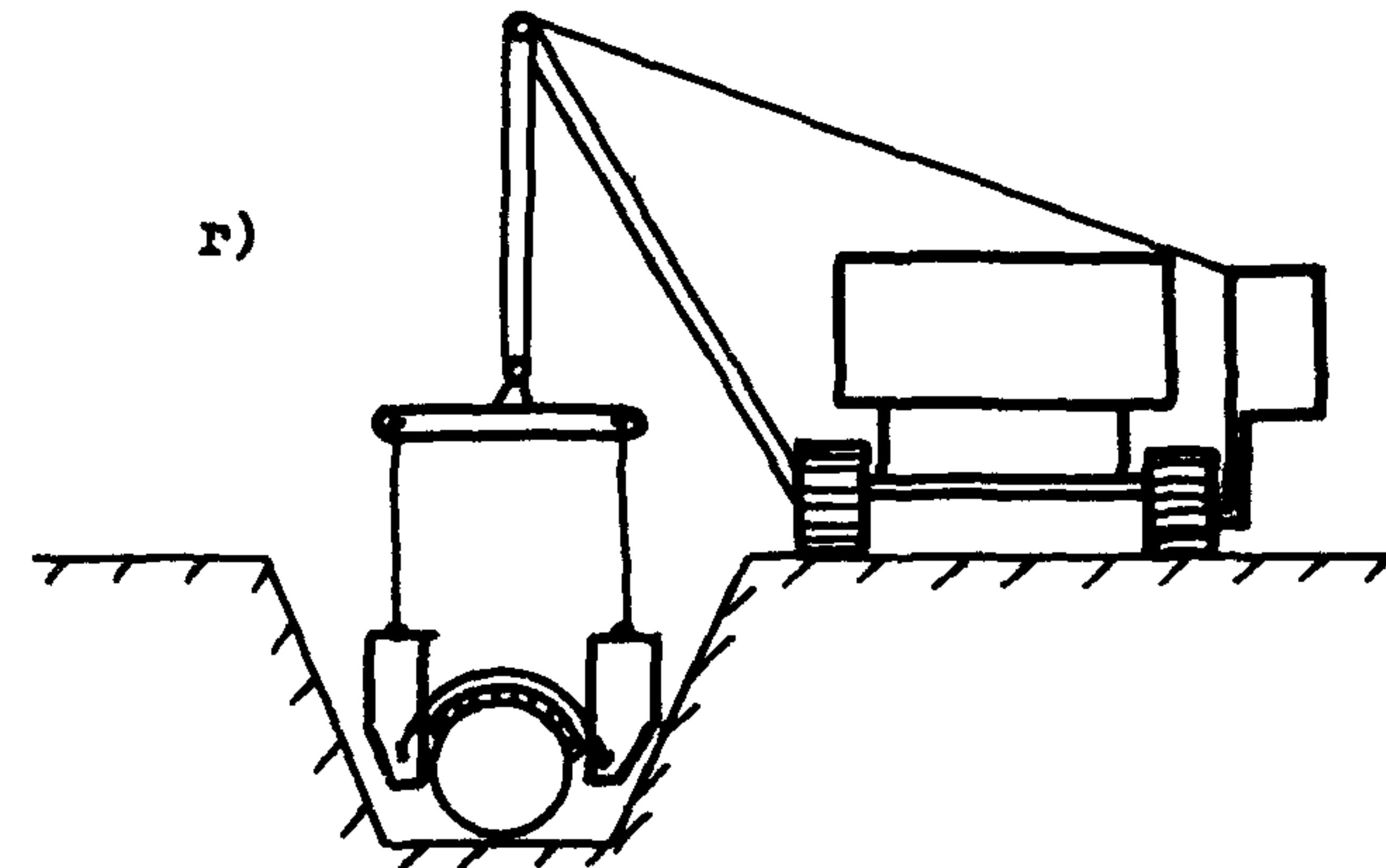
Рис.2. Продовательность монтажа утяжелителей типа УБО:
