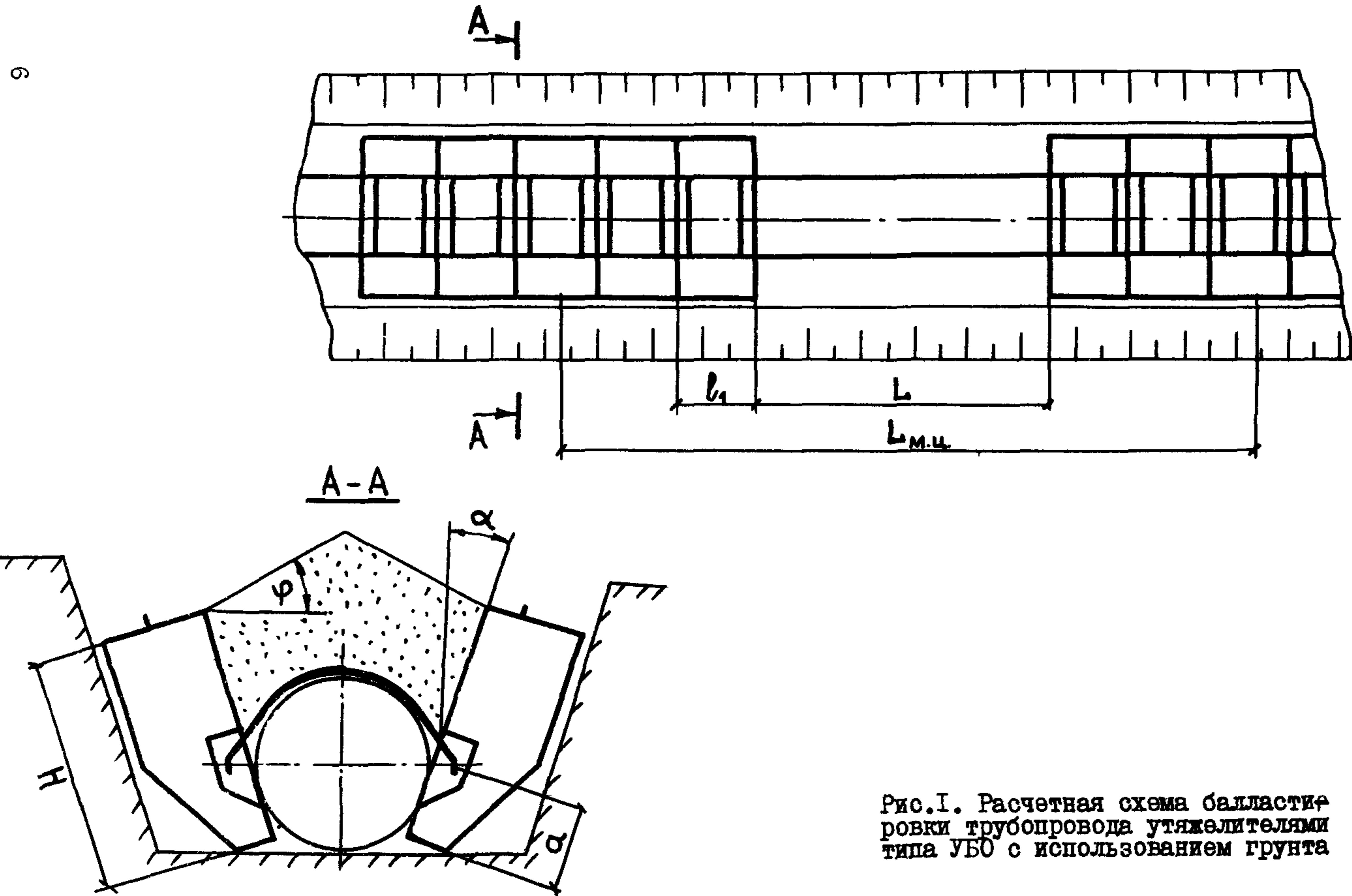
$$F = [D + (H-a)\sin\alpha] (H-a)\cos\alpha - \frac{\pi D^2}{8} + \left[ \frac{D+2(H-a)\sin\alpha}{2} \right] t_0 \varphi, \quad (3)$$
