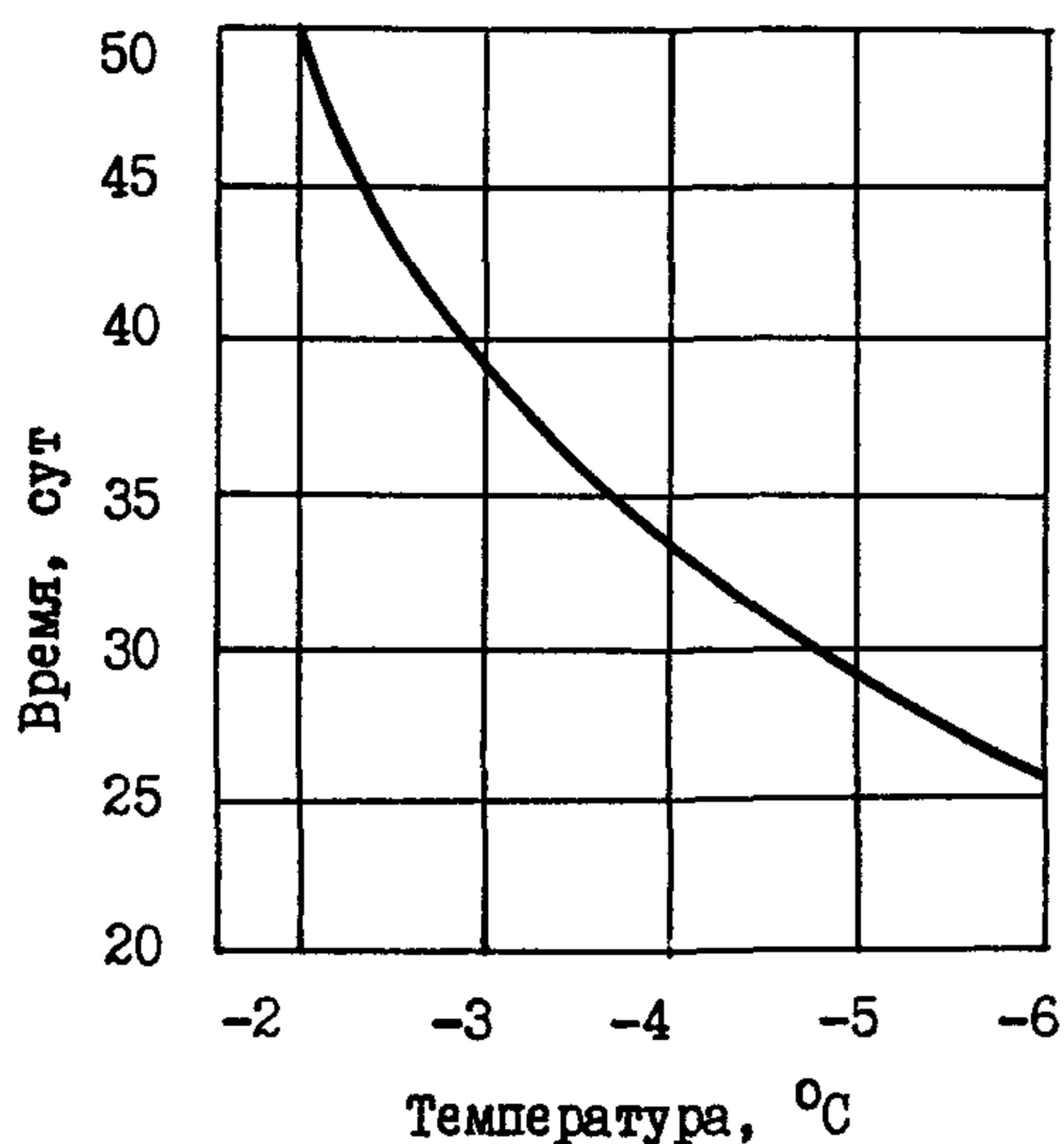
Рис. 2 Продолжительность восстановления температуры в скважине в зависимости от среднегодовой температуры вечномерзлого грунта
