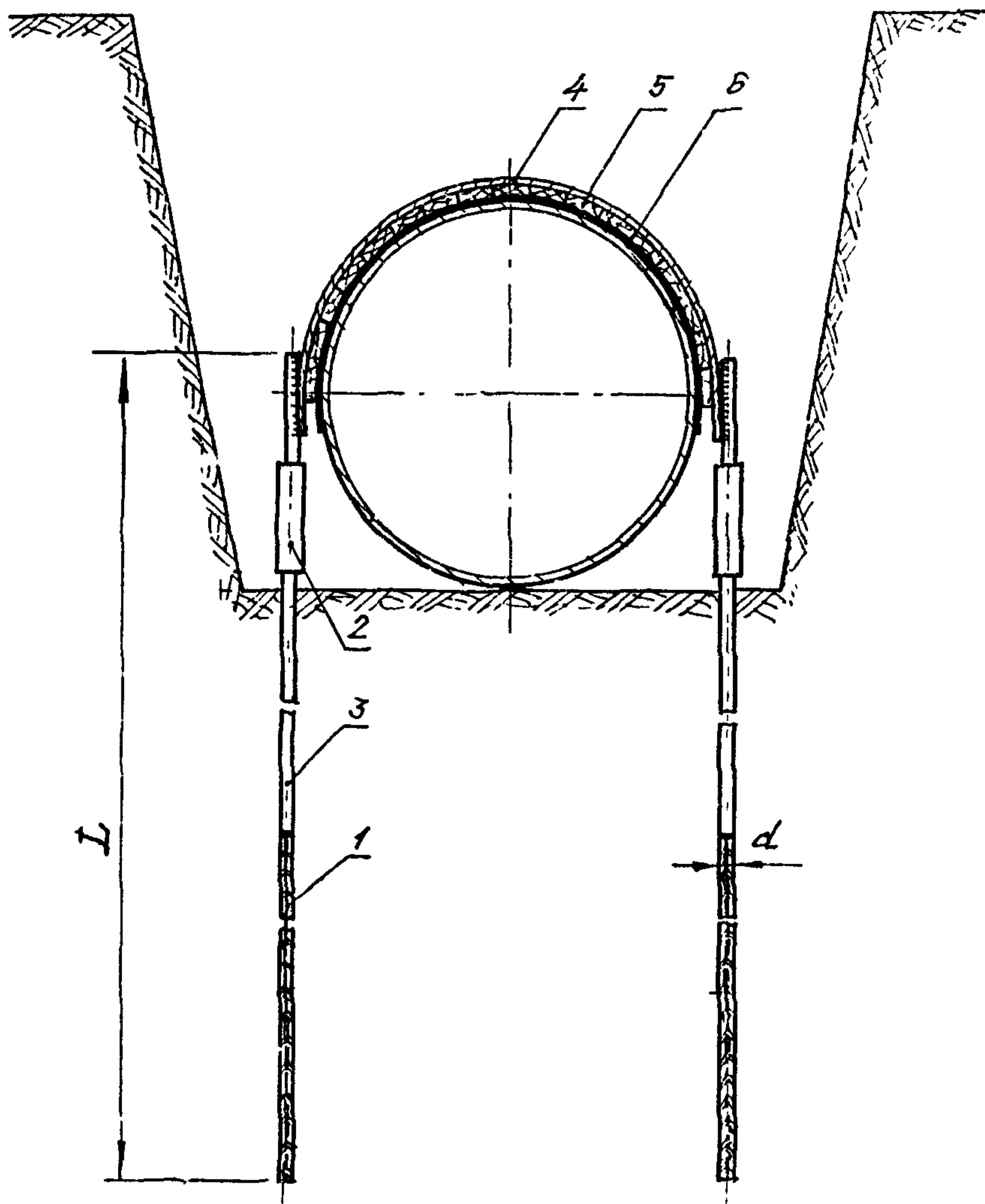
Рис. I. Стержневое анкерное устройство
