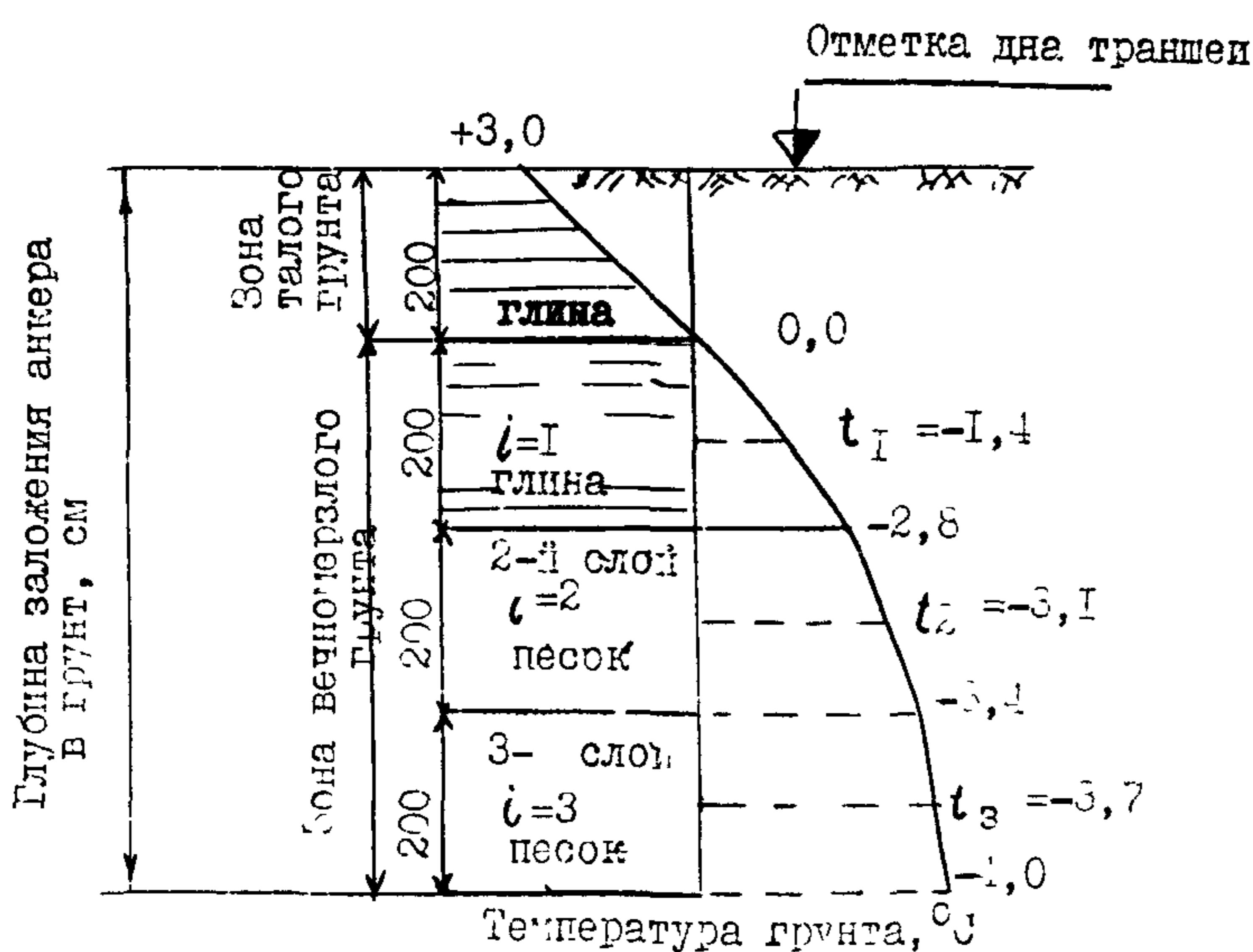
Рис.3. График распределения температур в грунте под трубопроводом
